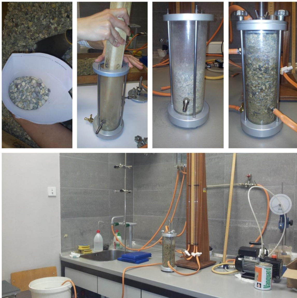
Slika 4-11 Ugradnja uzorka u ćeliju
