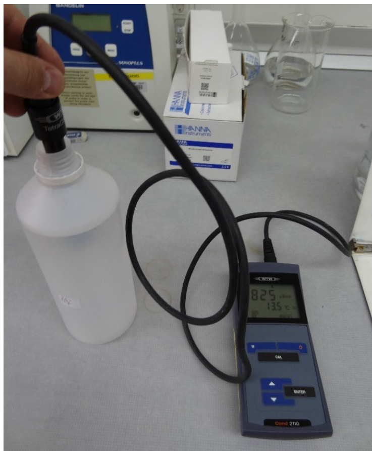
Slika 4.23. Mjerenje električne vodljivosti na uzorku ZG-14
