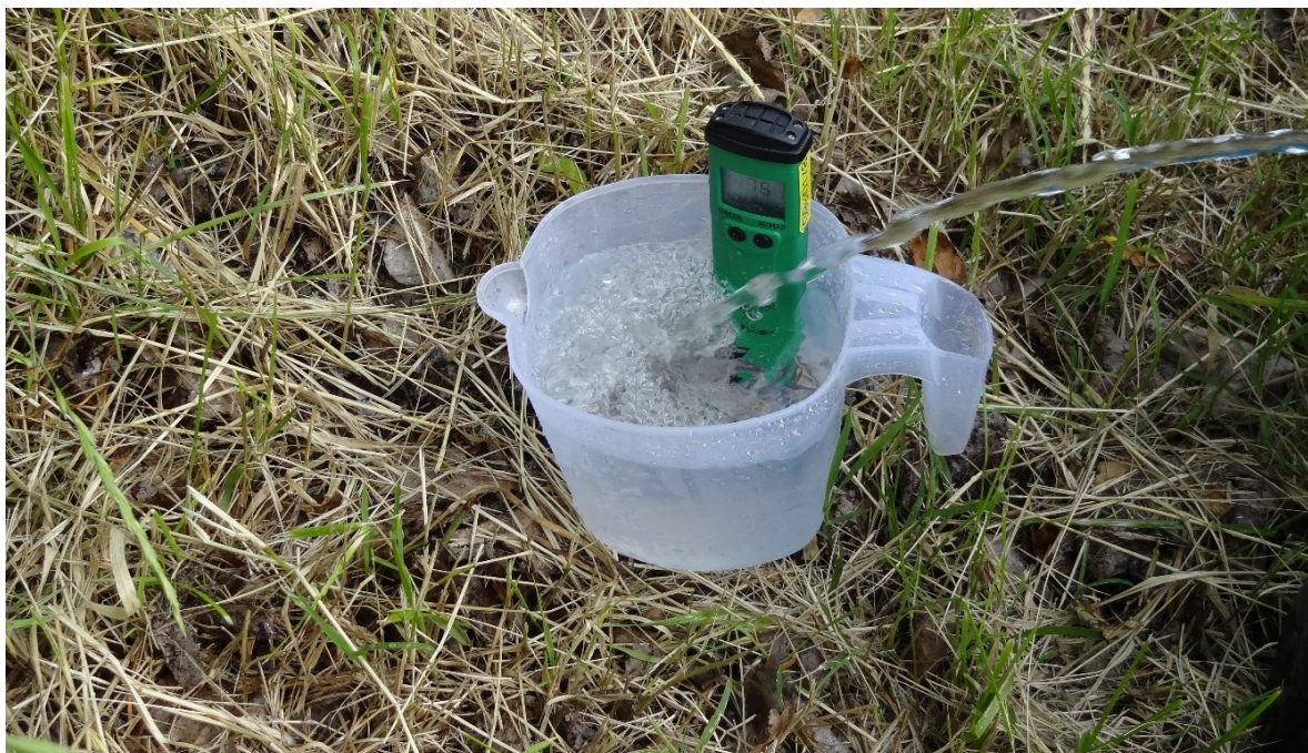
Slika 4.22. Mjerenje pH prije uzorkovanja na piezometru Mm-325
