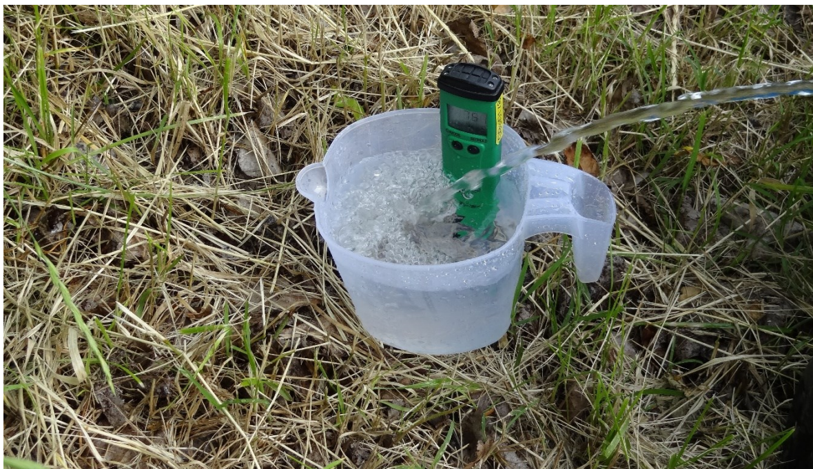
Slika 4.22. Mjerenje pH prije uzorkovanja na piezometru Mm-325
