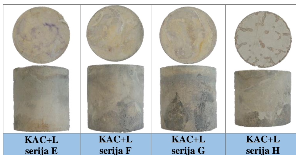
Slika 4.61. Izgled uzoraka cementnog kamena KAC+L nakon izlaganja vodi zasićenoj s CO 2
