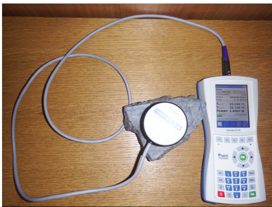
Slika 5.10. Mjerenje toplinske vodljivost trijaskog dolomita površinskom sondom
