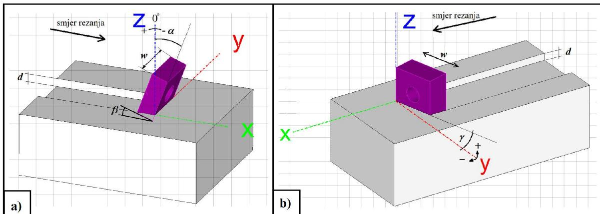
Slika 2.5. Geometrijske veličine reznog alata a)  $\alpha = -20^\circ$ ,  $\gamma = 0^\circ$ ,  $\delta = 0^\circ$ ,  $\beta = 20^\circ$ ; b)  $\alpha = 0^\circ$ ,  $\gamma = 15^\circ$ ,  $\delta = 0^\circ$ ,  $\beta = 0^\circ$ .
