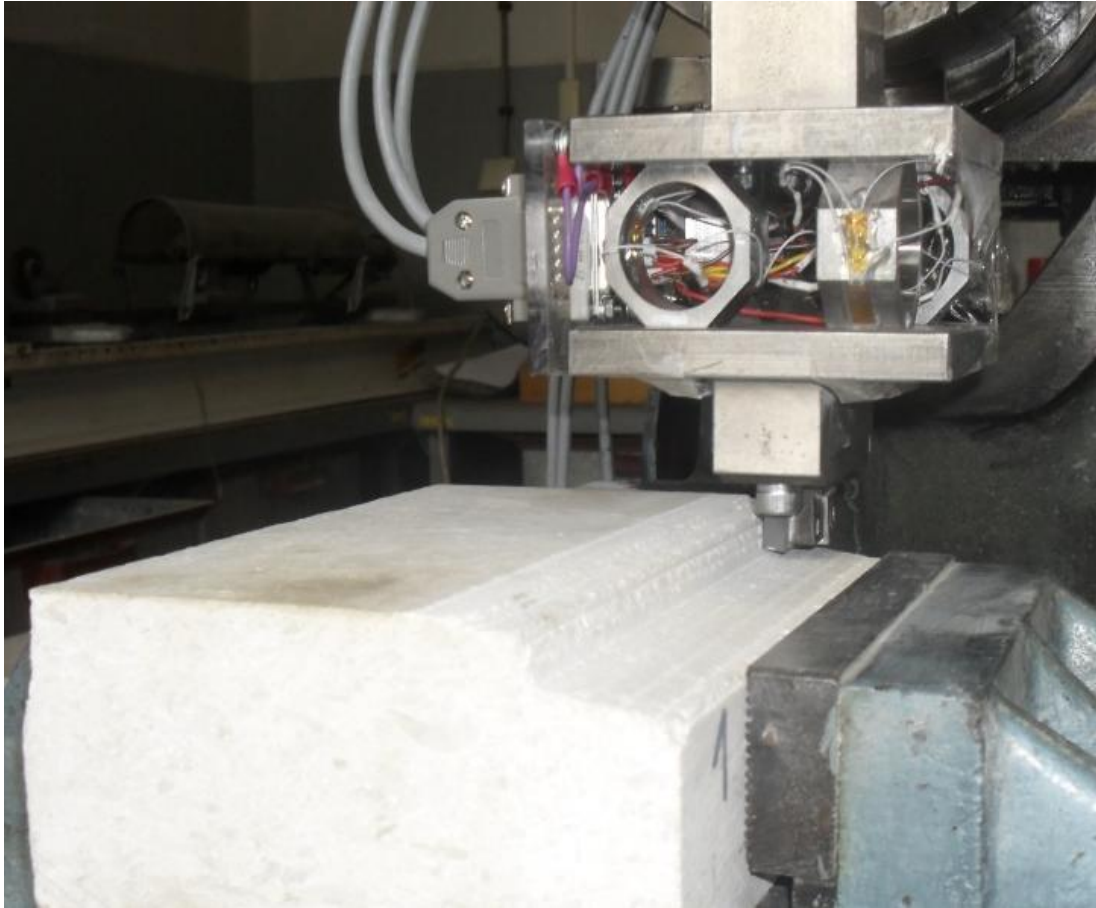
Slika 6.22. Ispitivanje utjecaja širine i dubine reza na učinak rezanja.
