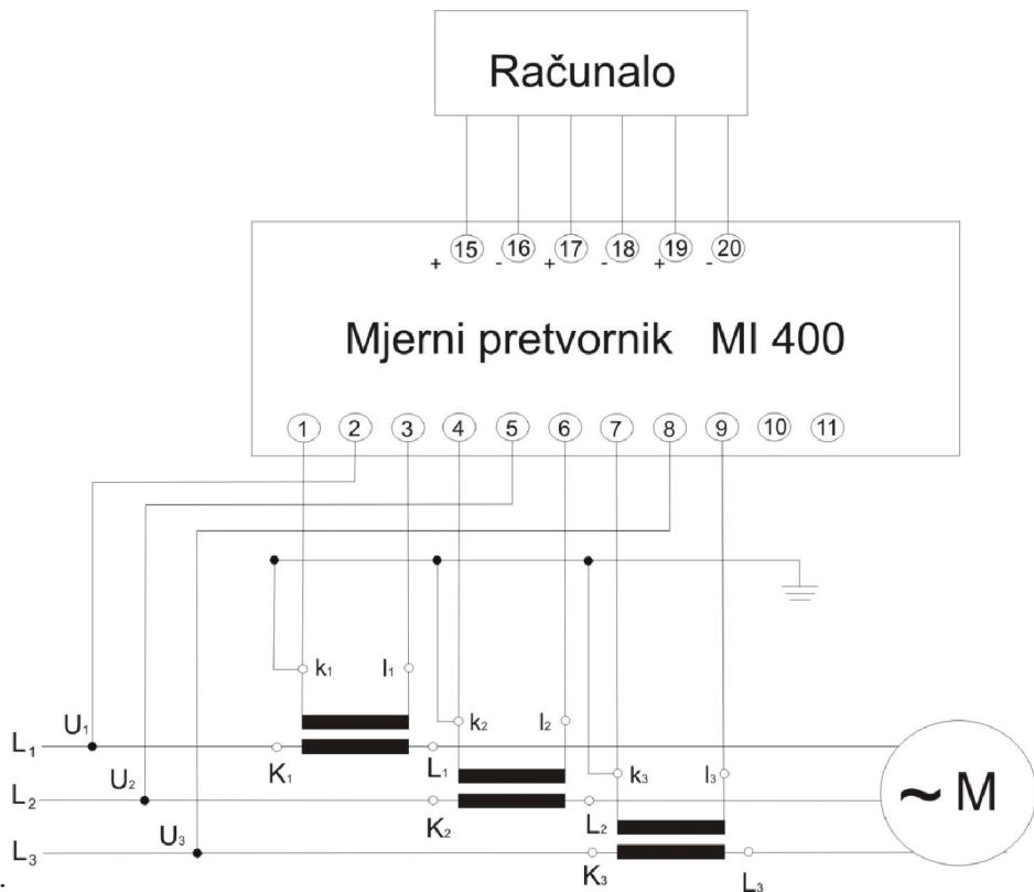
Slika 6.36. Električna shema mjerjenja snage.
