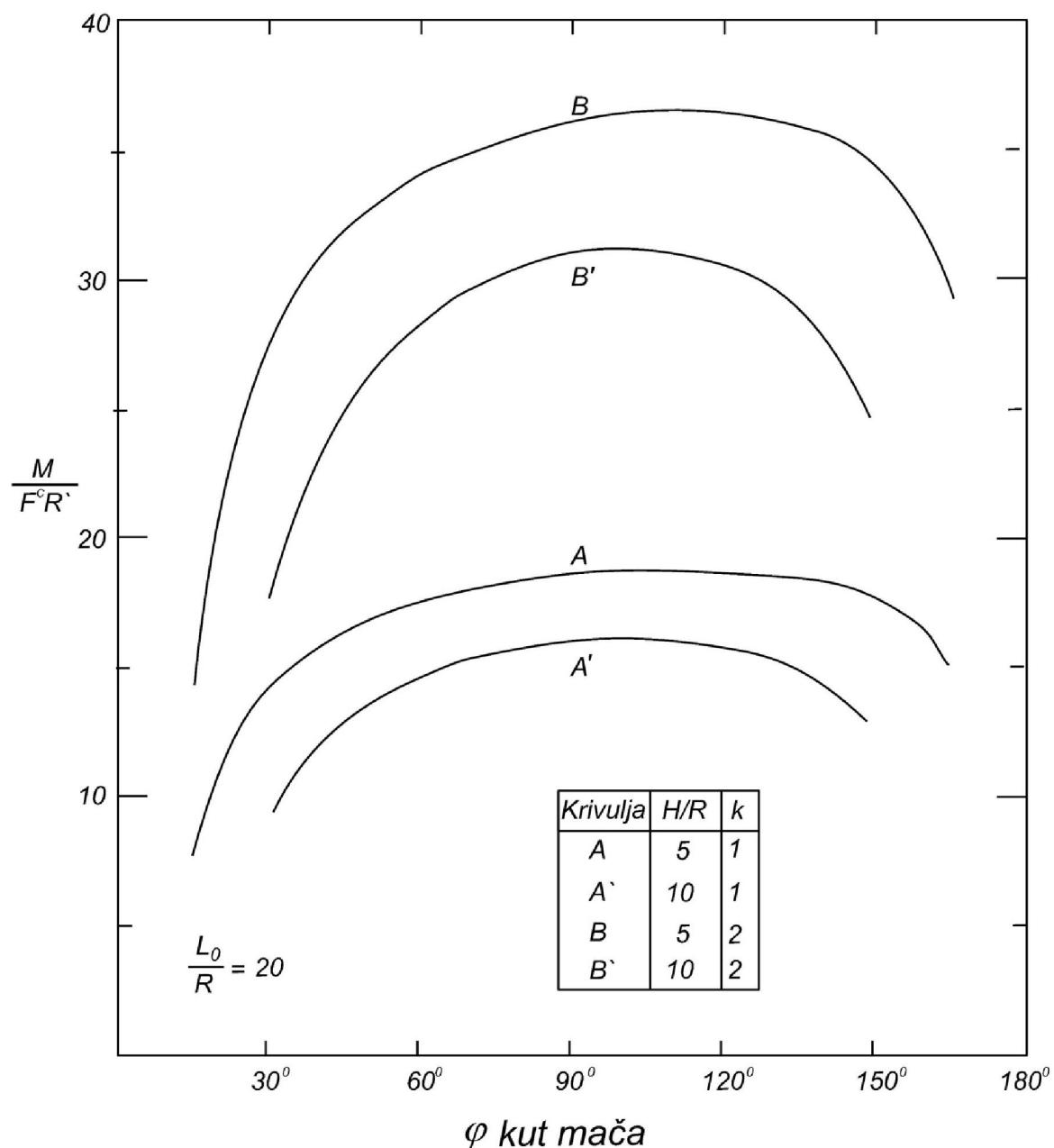
Slika 4.6. Utjecaj promjene kuta mača na povećanje momenta sila rezanja pri konstantnoj dubini rezanja (Mellor, 1978).
