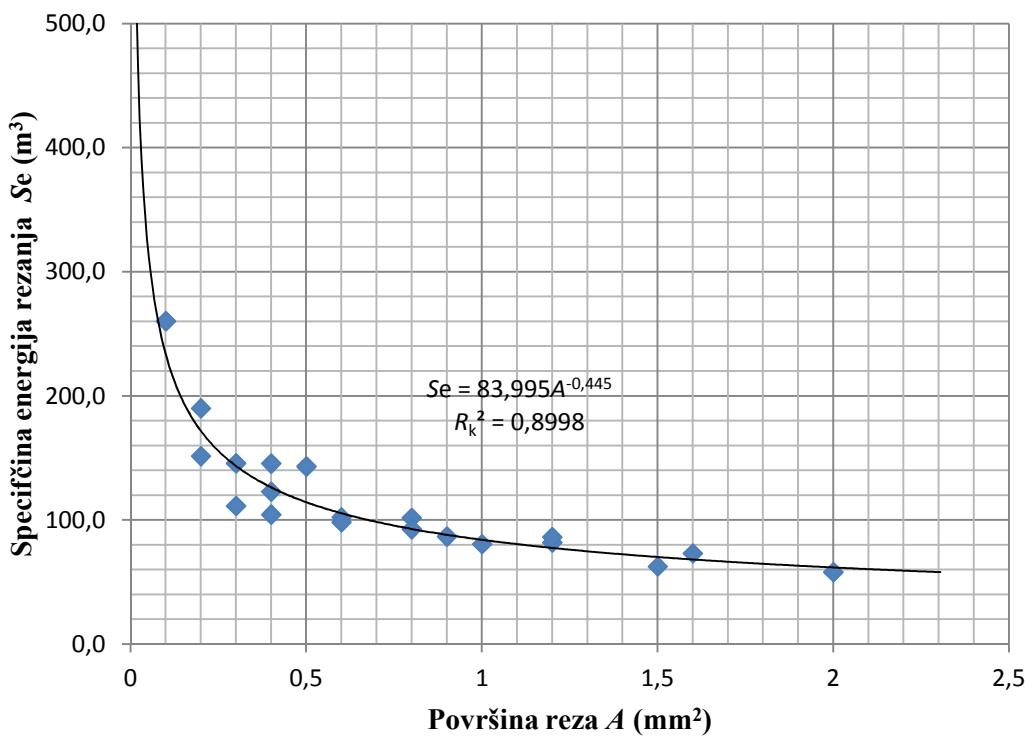
Slika 6.23. Utjecaj površine reza na specifičnu energiju.
