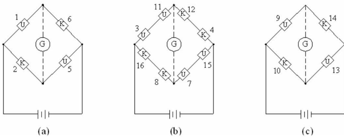
Slika 6.7. Konfiguracija mjernih traka u Wheatstoneovom mostu za a) bočnu silu, b) normalnu silu i c) tangencijalnu silu (Yıldız i Ünsaçar, 2006).
