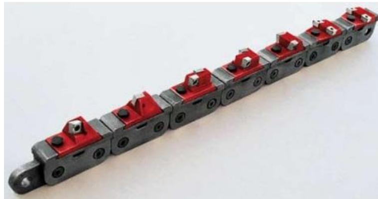
Slika 7.1. Rezni segment lančane sjekačice „Pellegrini Ch-60“ (Pellegrini, 2009).
