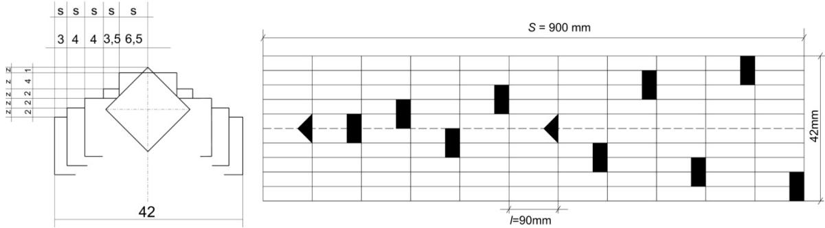
Slika 2.4. Rezni segment lančane sjekačice tvrtke Korfmann.
