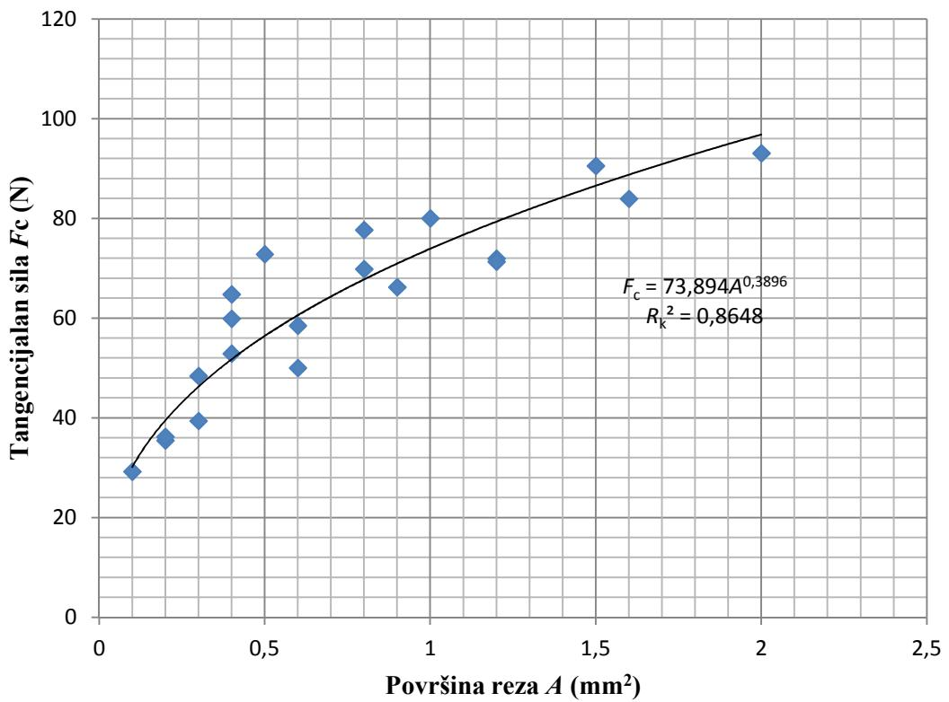
Slika 6.24. Utjecaj površine reza na tangencijalnu silu rezanja.
