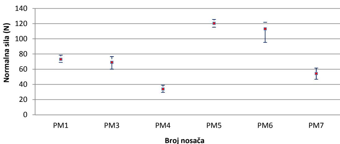
Slika 6.31. Raspodjela normalnih sila za pojedinačne nosače.
