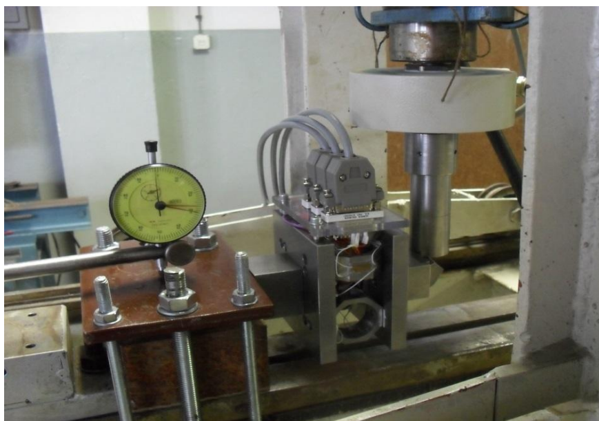
Slika 6.10. Uređaj za umjeravanje pretvornika sile.
