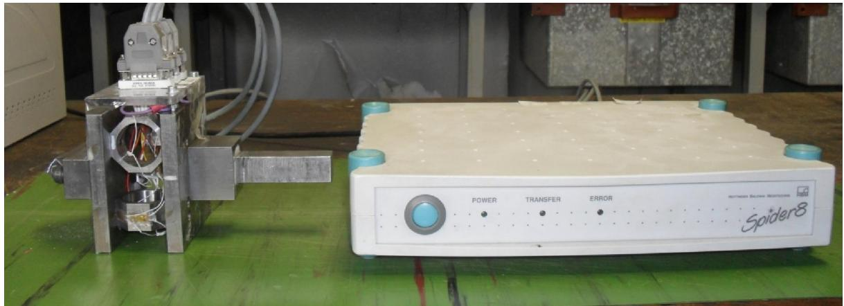
Slika 6.8. Mjerni sustav za ispitivanje rezivosti stijenske mase.
