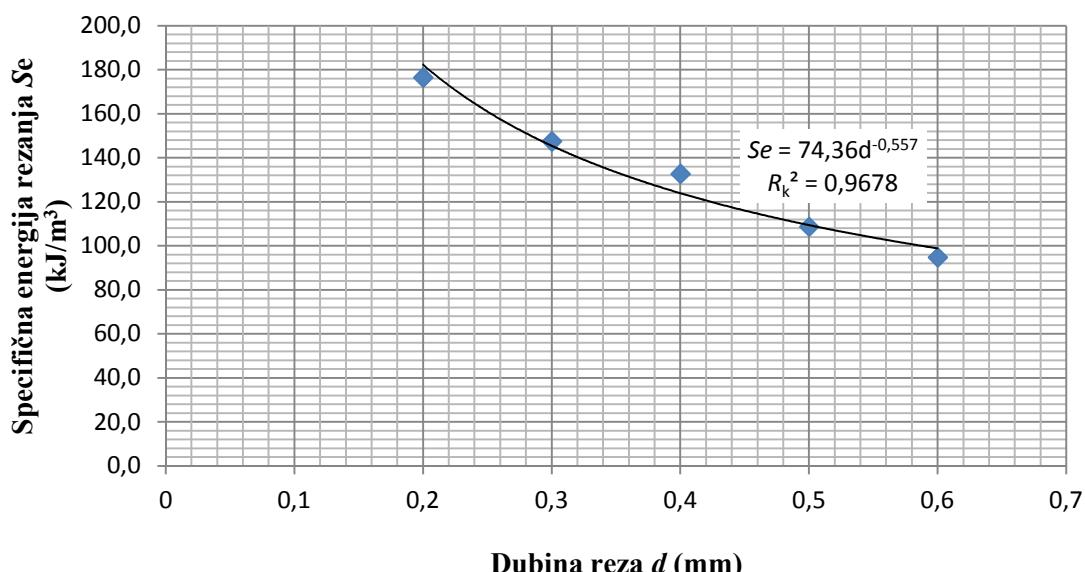
Slika 6.21. Zavisnost specifične energije rezanja o dubini reza.
