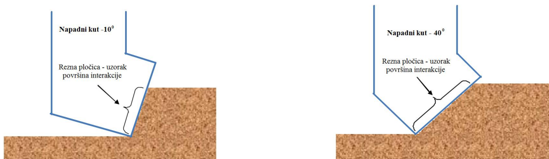
Slika 5.5. Povećanje površine kontakta stijene i rezne pločice uslijed povećanja napadnog kuta Rajabov et al. (2012).
