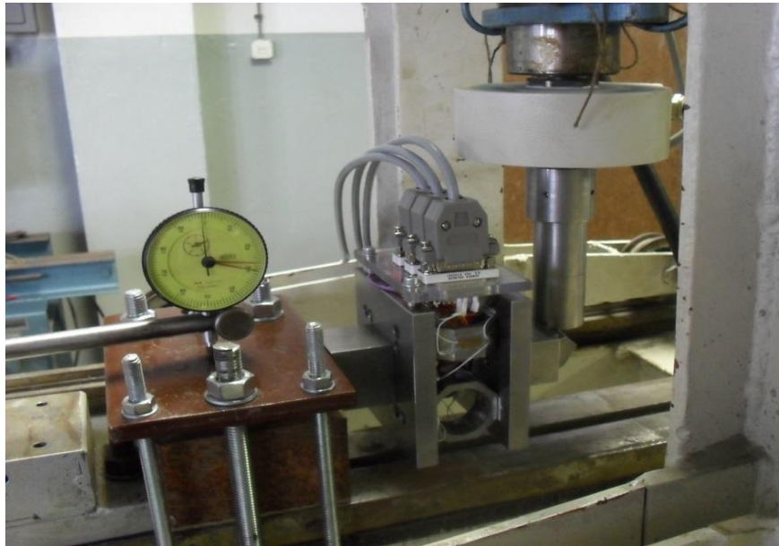
Slika 6.10. Uređaj za umjeravanje pretvornika sile.
