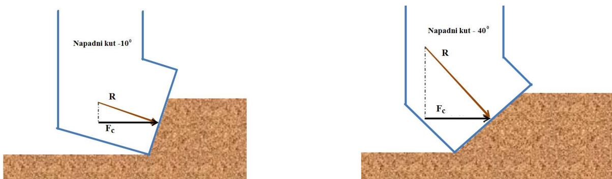
Slika 5.6. Povećanje rezultantne sile uslijed povećanja napadnog kuta Rajabov et al. (2012).
