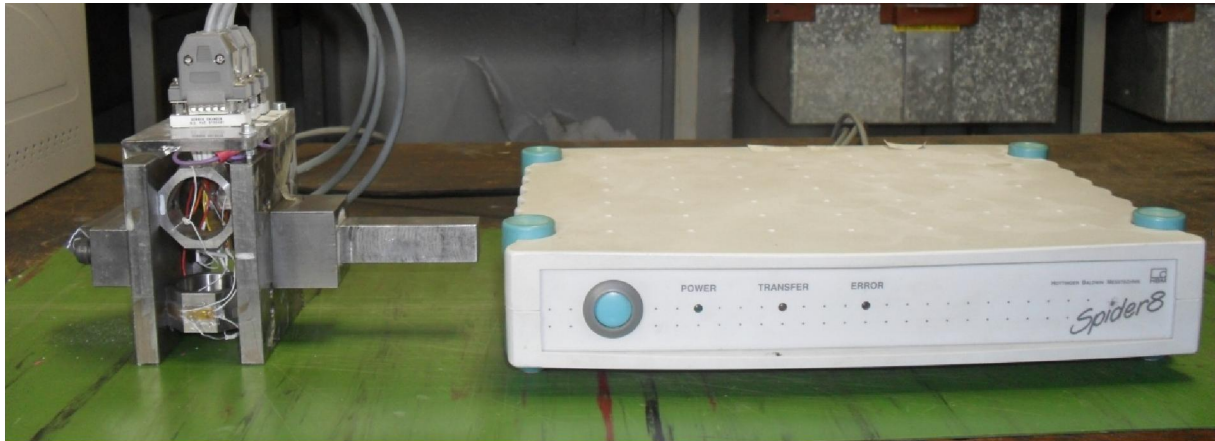
Slika 6.8. Mjerni sustav za ispitivanje rezivosti stijenske mase.
