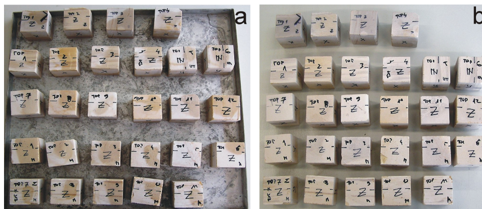
Sl.5.72. Uzorci a) prije i b) nakon ciklusa postojanosti na toplinske promjene.
