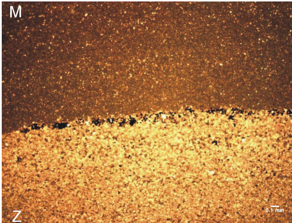
Sl. 5.11. Mikrofotografija pirita akumuliranog na samoj granici zrnskog i mikritnog litotipa.
