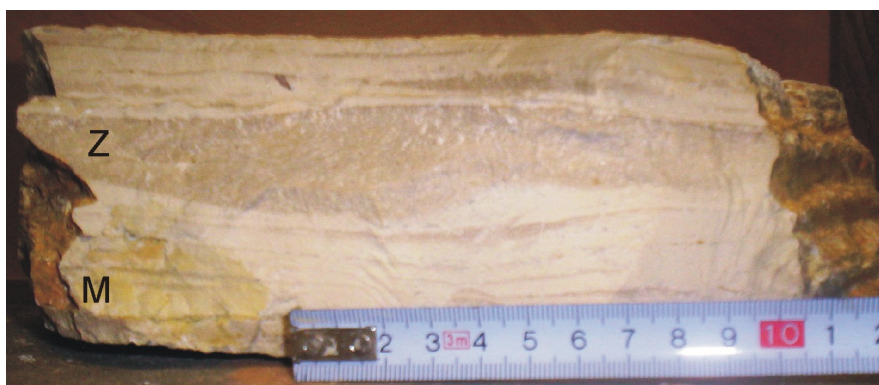
Sl.5.22. Uzorak benkovačkoga kamena na kojem je vidljiva izmjena svijetlih i tamnijih lamina (laminirani litotip).
