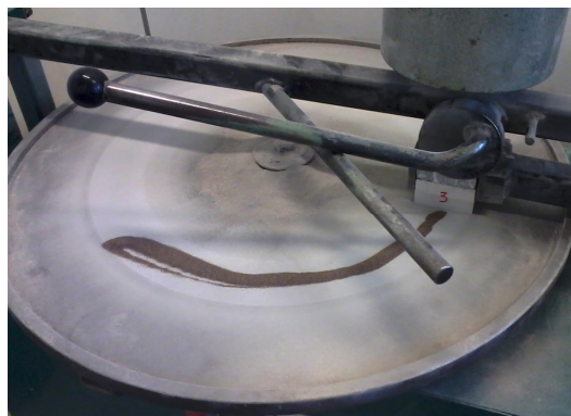
Sl.4.8. Određivanje otpornosti na habanje metodom prema Böhmeu.
