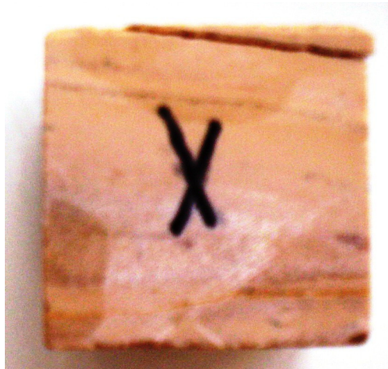
Sl.5.71. Uzorak laminiranog litotipa se raspao nakon 30-tog ciklusa smrzavanja.
