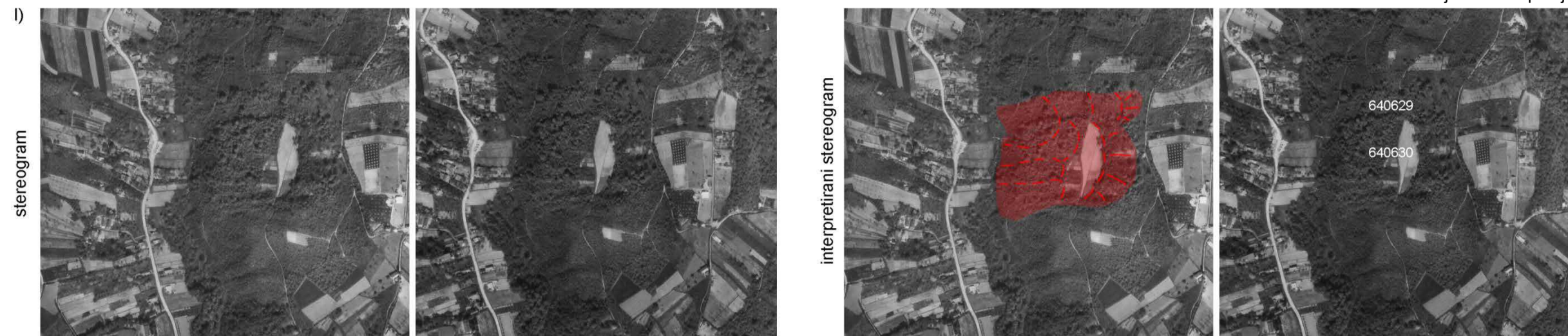
a1: jasno izražene značajke u tijelu klizišta, lokacija: Veliki potok, klizišta: 640629 i 640630
