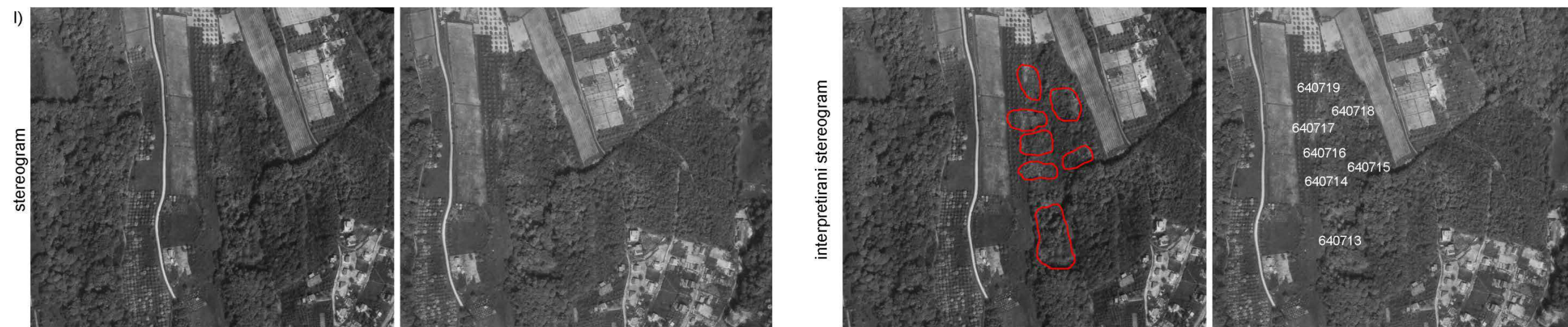
b1: granica klizišta je izražena >75%, lokacija: Jelenovac, klizišta: 640713, 640714, 640715, 640716, 640717, 640718 i 640719
