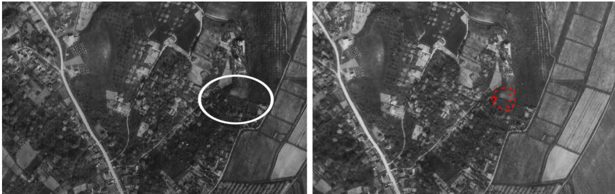
Slika 86 Stereogram klizišta broj 640217 u Kvaternikovoj ulici (kod k.br. 49) prema stereomodelu iz 1964. godine s označenom širom lokacijom klizišta (elipsa na lijevoj slici) i vidljivim elementima klizišta (crvene linije na desnoj slici)
