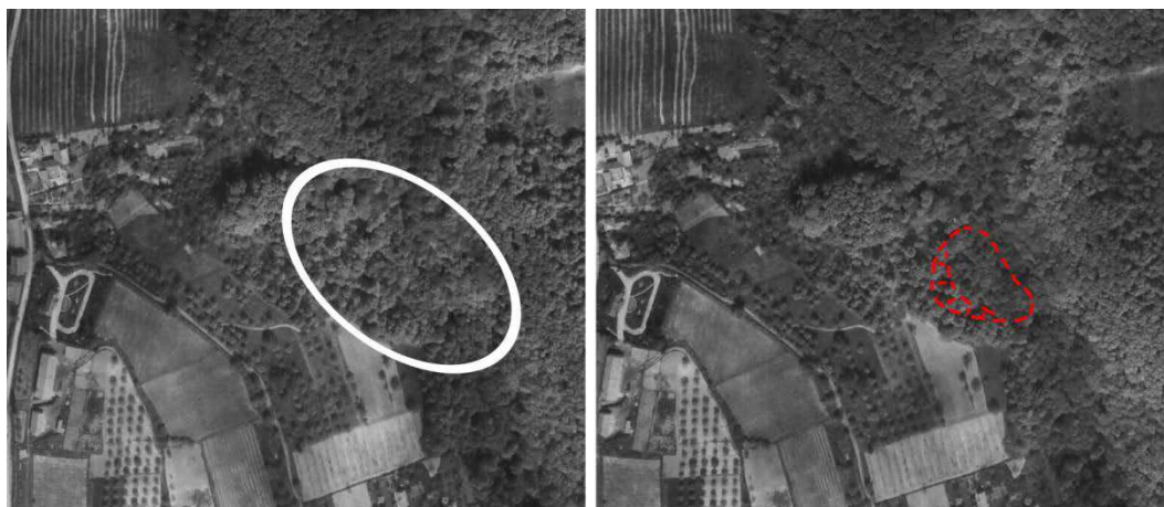
Slika 92 Stereogram klizišta broj 640722 na padini zapadno od potoka Jelenovac prema stereomodelu iz 1964. godine s označenom širom lokacijom klizišta (elipsa na lijevoj slici) i vidljivim elementima klizišta (crvene linije na desnoj slici)
