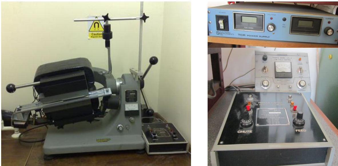
Sl. 3.8. Magnetni separator (Frantz Isodynamic Separator, Hrvatski geološki institut).
