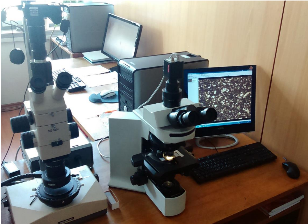
Sl. 3.2. Lupa Olympus SZH (lijevo) i mikroskop Olympus BX-51 (desno) s ugrađenim digitalnim kamerama i QuickPhoto Micro 2.3. programom za obradu mikrofotografija.
