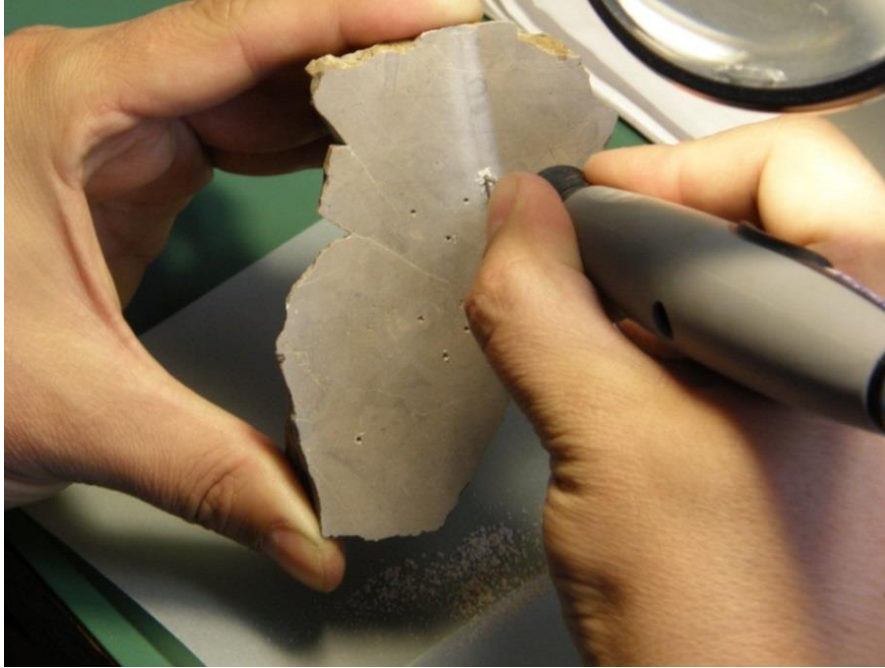
SI. 3.5. Uzorkovanje za analizu stabilnih izotopa (bušenje mikritnog dijela polirane pločice za uzorkovanje minimalno 2 g uzorka u prahu).
