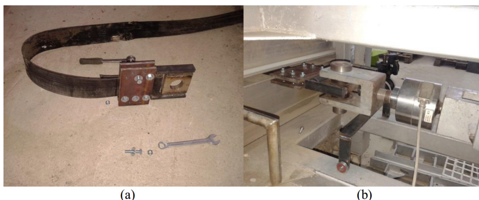
Slika 5-3 a) Posebno razvijen sustav prihвата trake b) Pričvršćenje trake na sustav za izvlačenje
