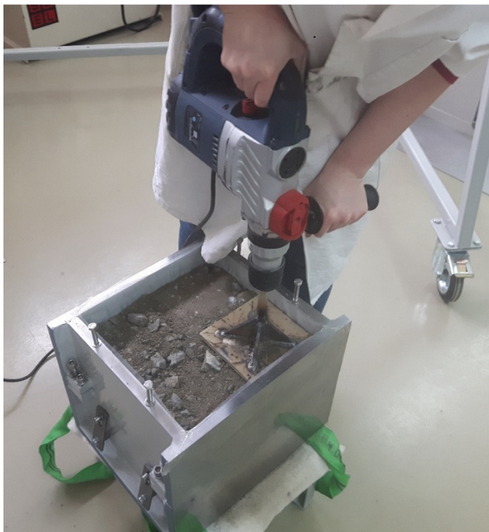
Slika 4-4 Ugradnja uzorka u kutiju
