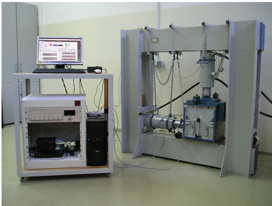
Slika 4-1 Veliki uređaj za izravni posmik
