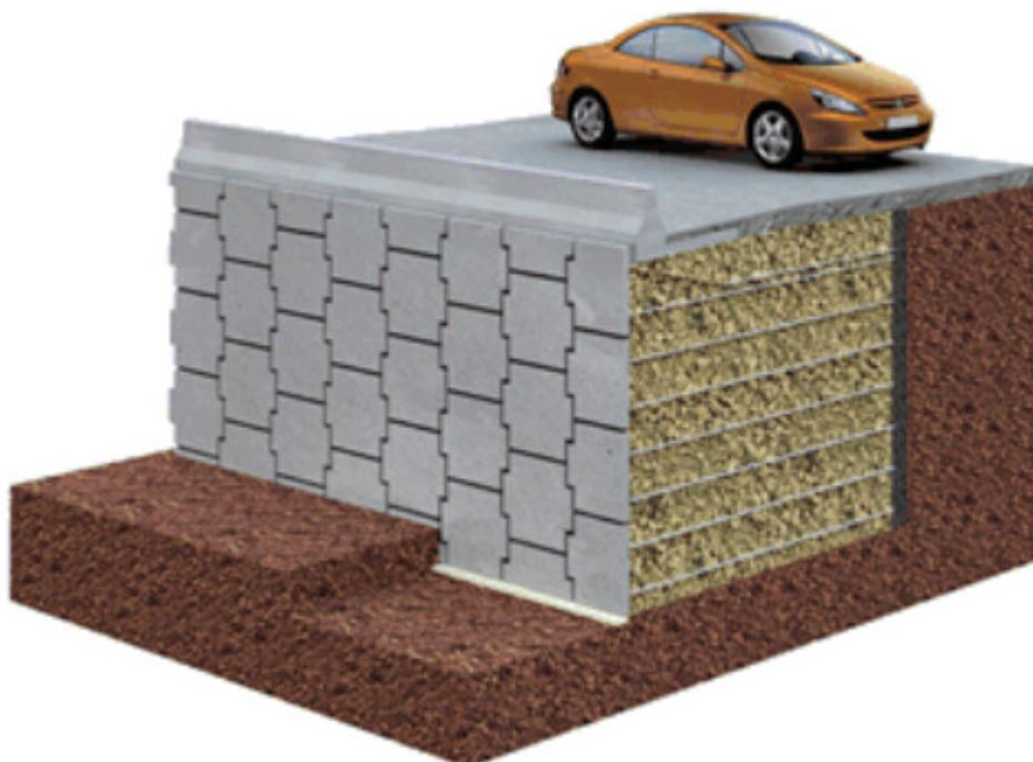
**Slika 2-1** Glavni dijelovi konstrukcija od armiranog tla
