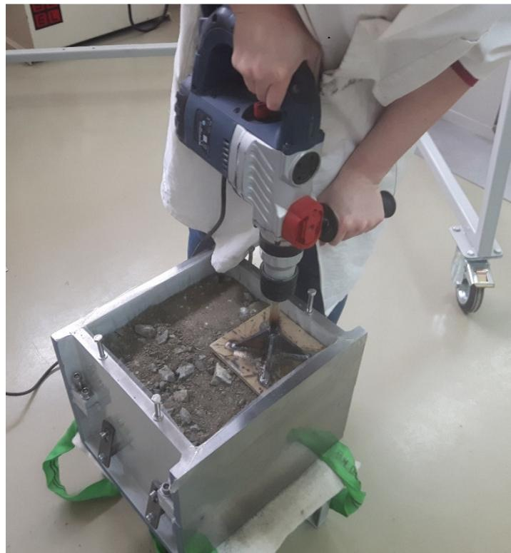
**Slika 4-4** Ugradnja uzorka u kutiju
