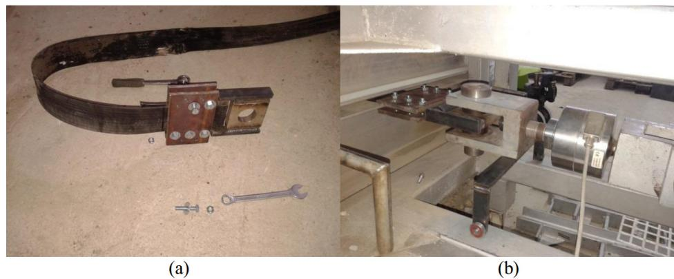
**Slika 5-3** a) Posebno razvijen sustav prihvata trake b) Pričvršćenje trake na sustav za izvlačenje
