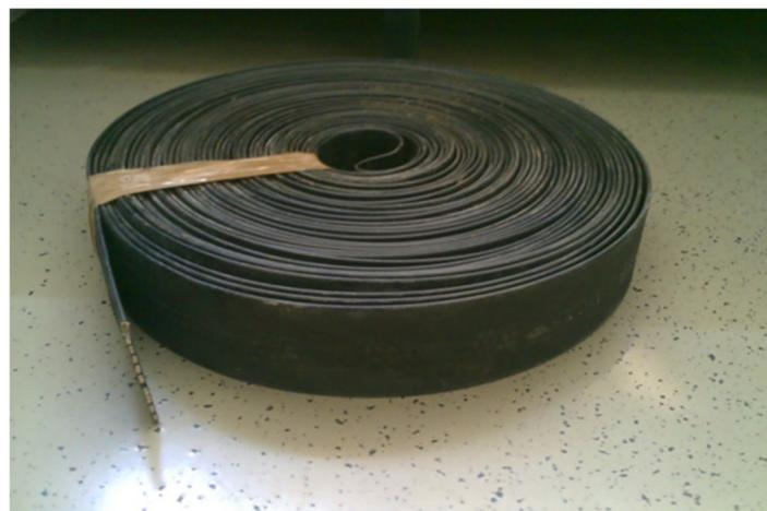
**Slika 5-4** Polietilenska – *ParaWeb* traka korištena u ispitivanju
