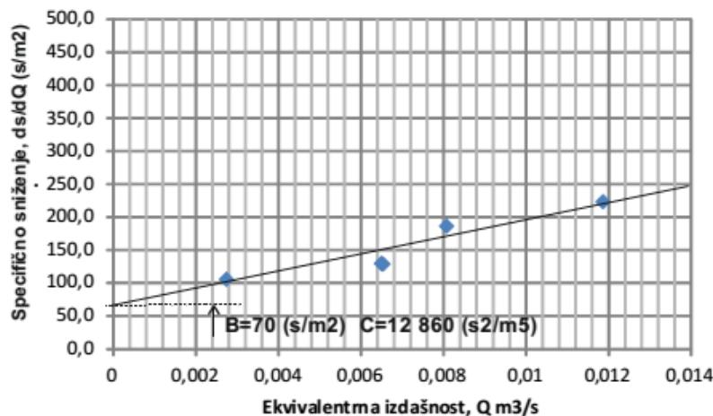
Slika 4.7. Grafička analiza ekvivalentnog specifičnog sniženja i ekvivalentne izdašnosti bušotine SP-1 prema podacima s tablice 4.3. (prema Hlevnjak i dr., 2014)
