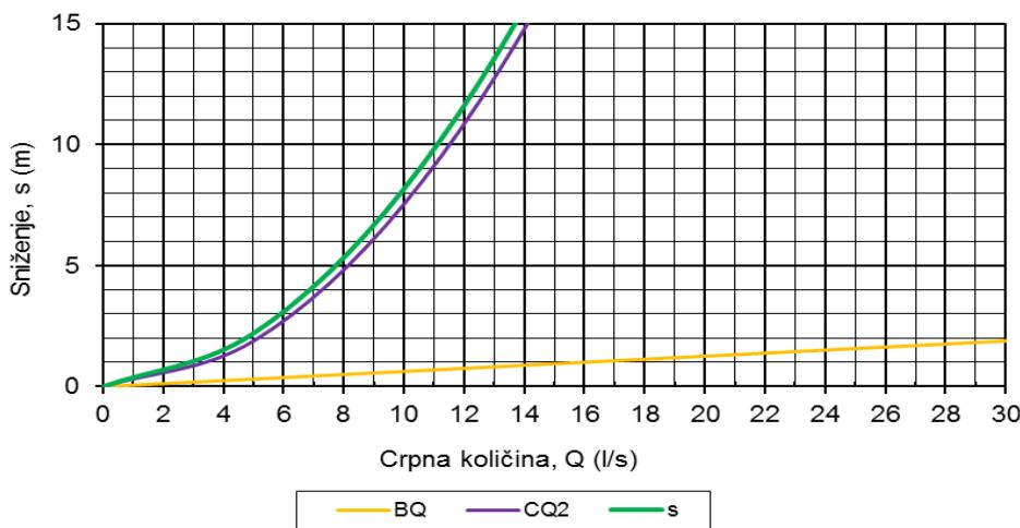
Slika 4.5. Dijagram  $s=f(Q)$  i pojedine vrste gubitaka za crpljenje bušotine SP-1
