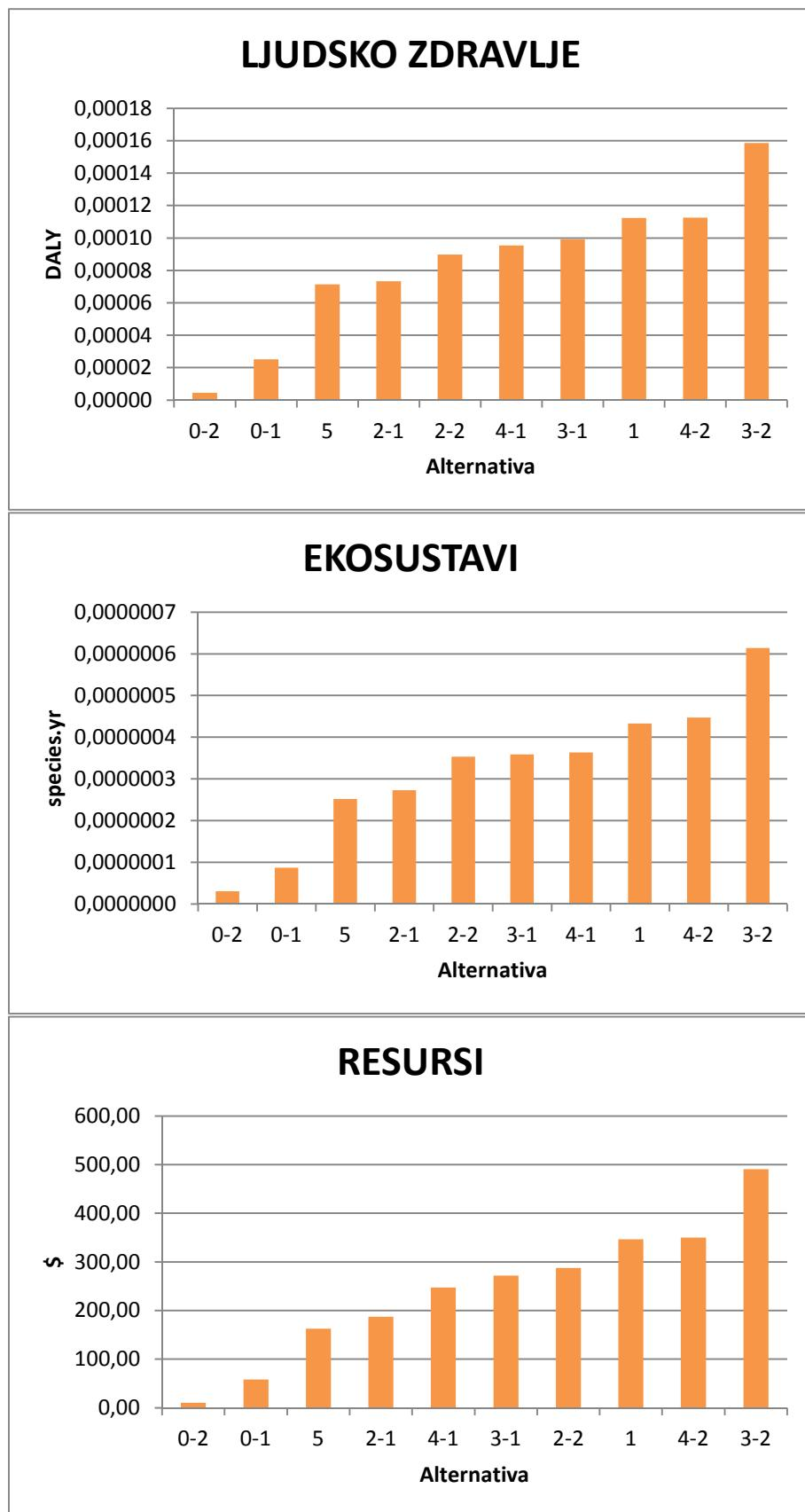
Slika 9-5. Rangiranje alternativa po vrijednostima pojedinih indikatora srednje točke
