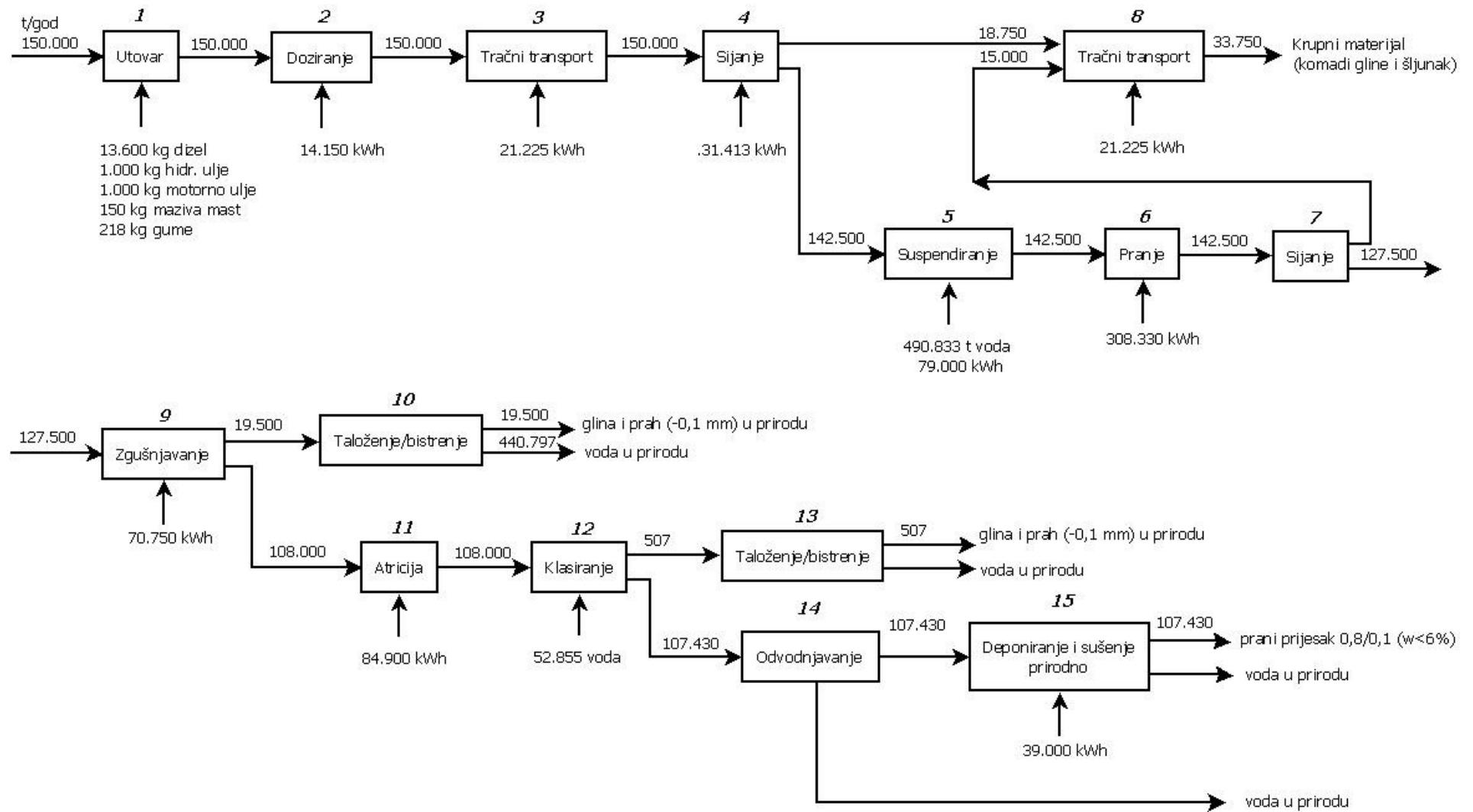
Slika 8-2. Proizvodni proces pranja i klasiranja kvarcnog pijeska
