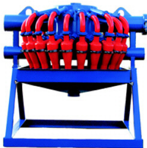
Slika 7-9. Baterija hidrociklona DC Machinery (NOV, 2013)
