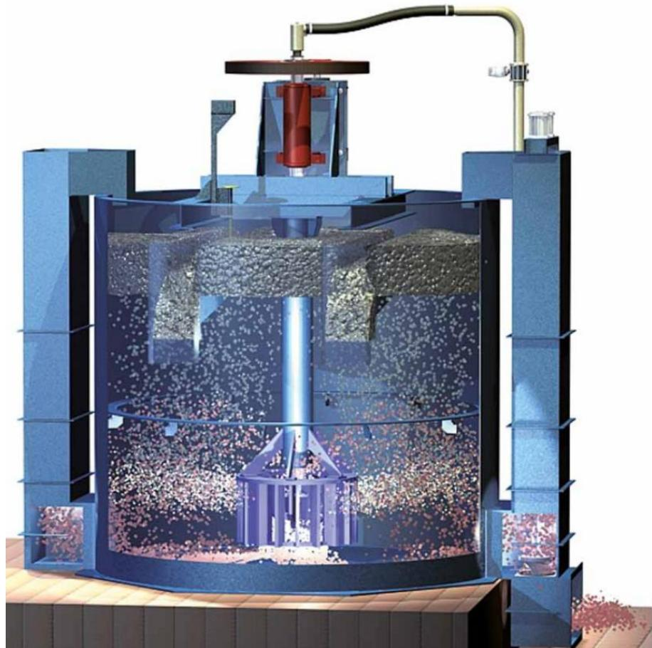
Slika 7-14. Flotacijska čelija Metso RCS (Metso, 2013)
