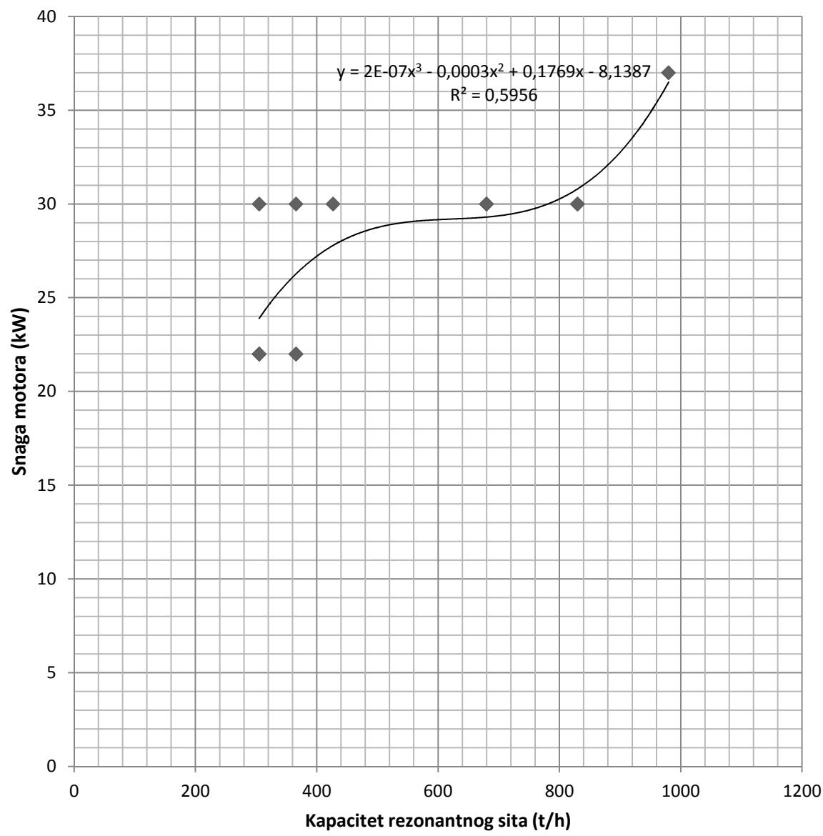
Slika 2b. Grafički prikaz snage elektromotora u odnosu na kapacitet rezonantnog sita
