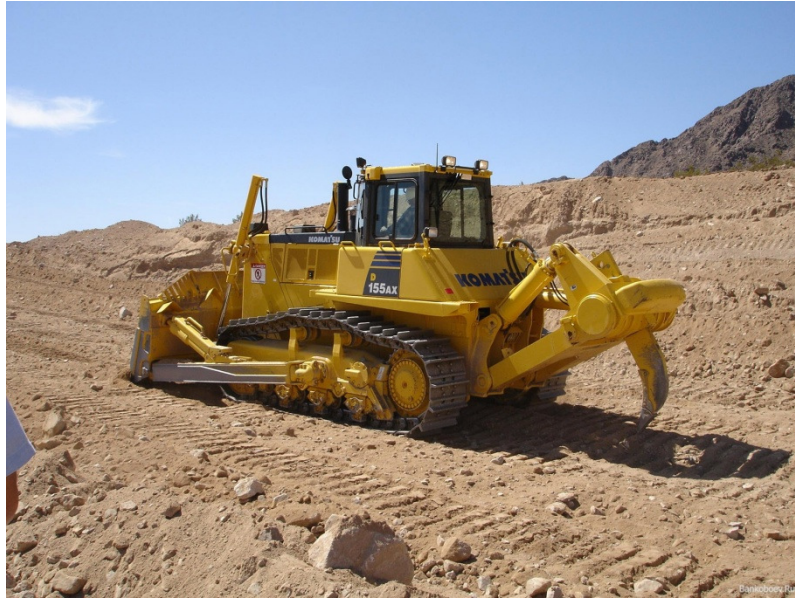
Slika 7-1. Buldozer KOMATSU D155AX (White, 2013)
