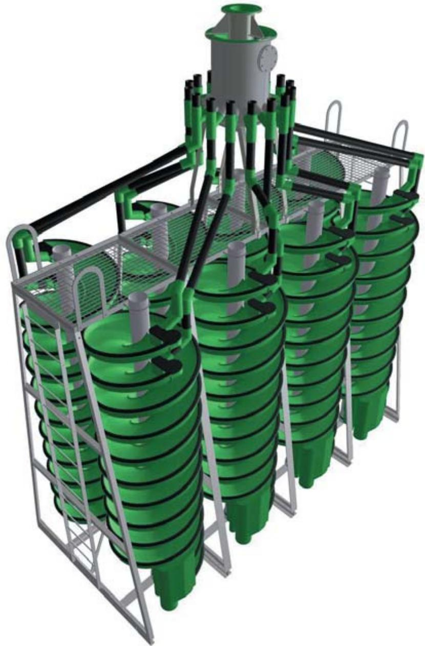
Slika 7-11. Spiralni separator MULTOTEC HX5 (Multotec, 2014)
