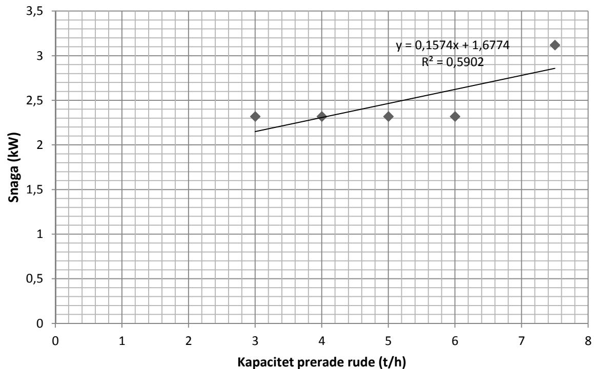
Slika 10a. Grafički prikaz snage suhog magnetskog separatora u odnosu na kapacitet prerade rude
