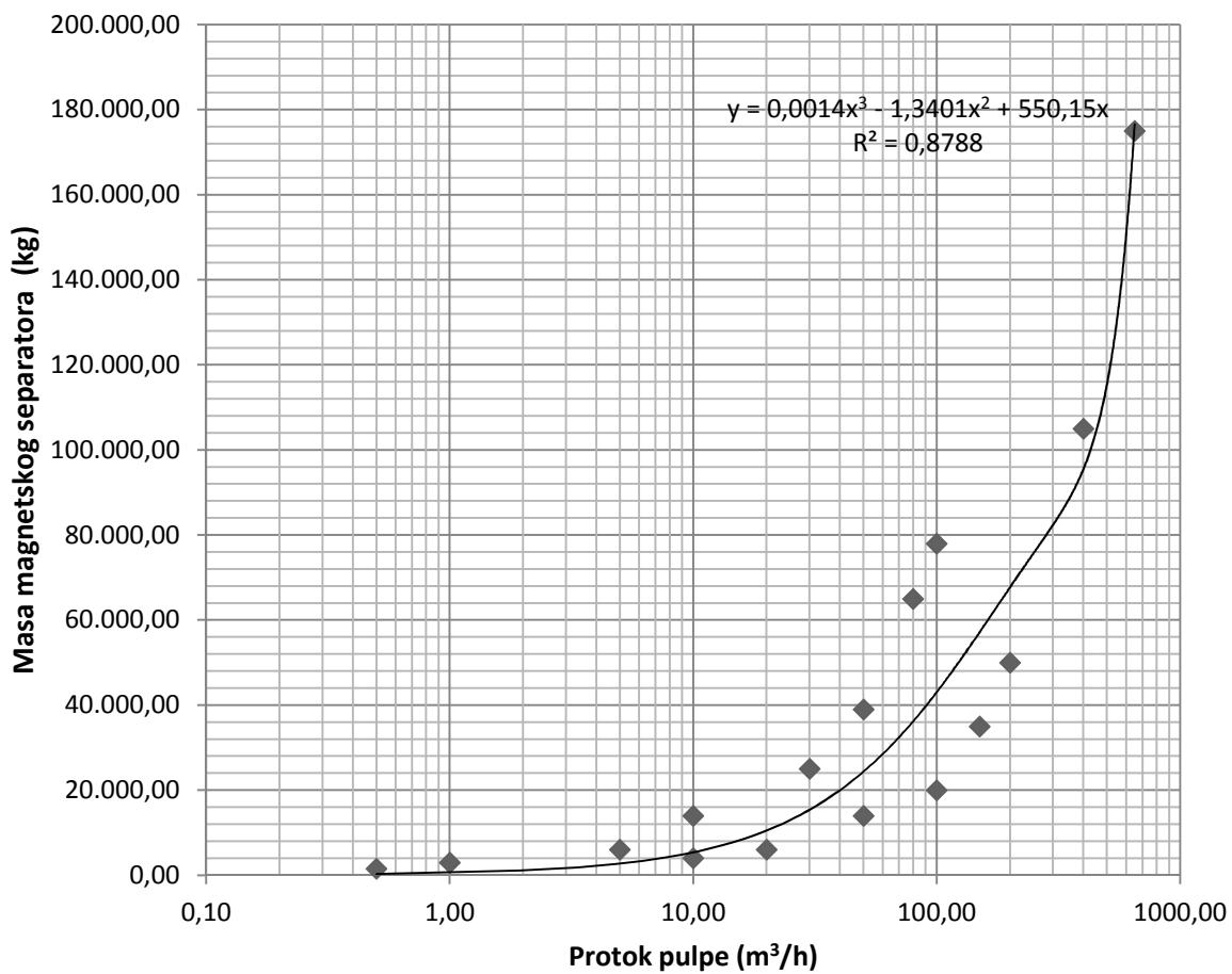
Slika 9d. Grafički prikaz mase mokrog magnetskog separatora u odnosu na protok pulpe
