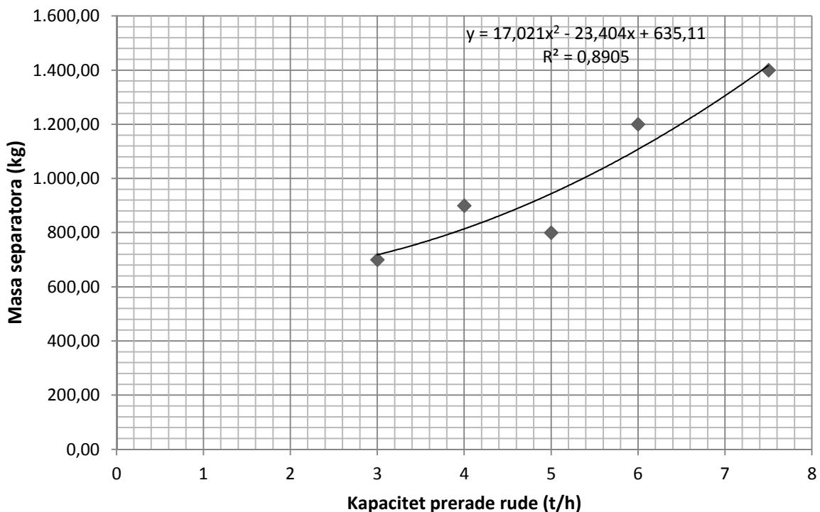
Slika 10b. Grafički prikaz mase suhog magnetskog separatora u odnosu na kapacitet prerađe rude
