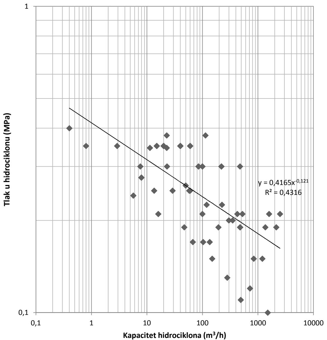
Slika 5. Grafički prikaz tlaka u odnosu na kapacitet hidrociklona
