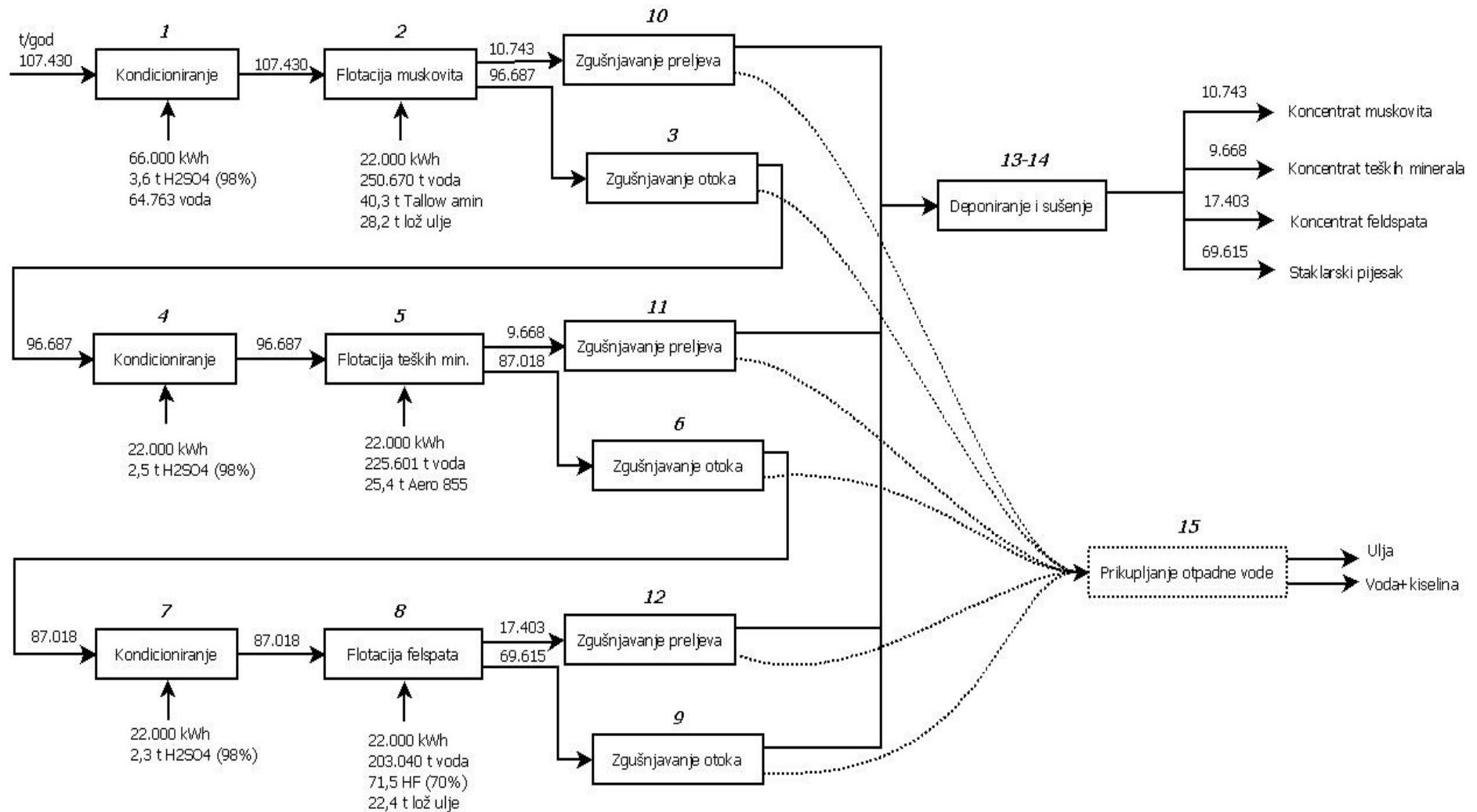
Slika 8-4. Proizvodni proces oplemenjivanja kvarcnog pjeska postupkom flotacije
