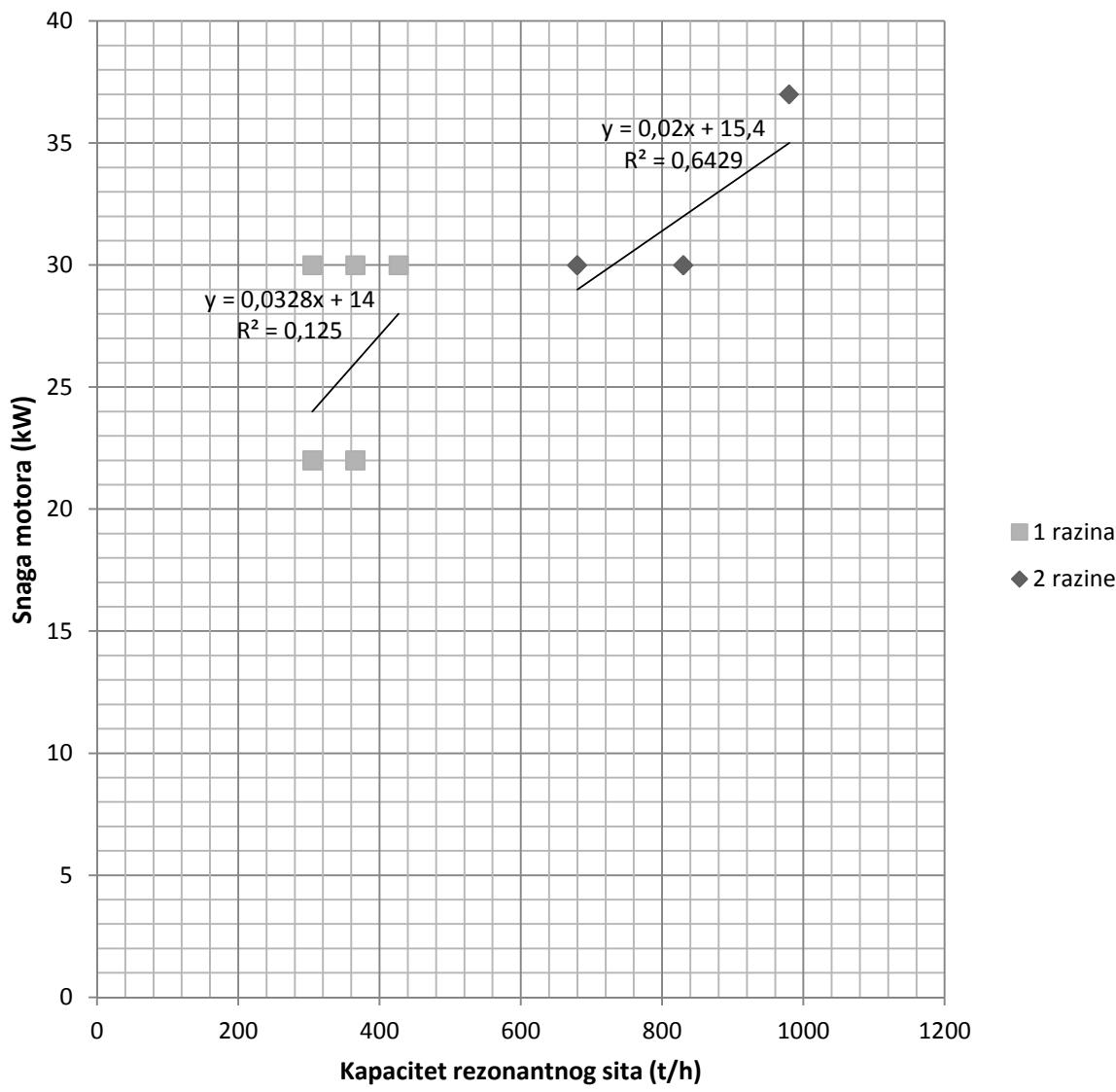
**Slika 2a.** Grafički prikaz snage elektromotora u odnosu na kapacitet rezonantnog sita za sita s jednom i dvije razine
