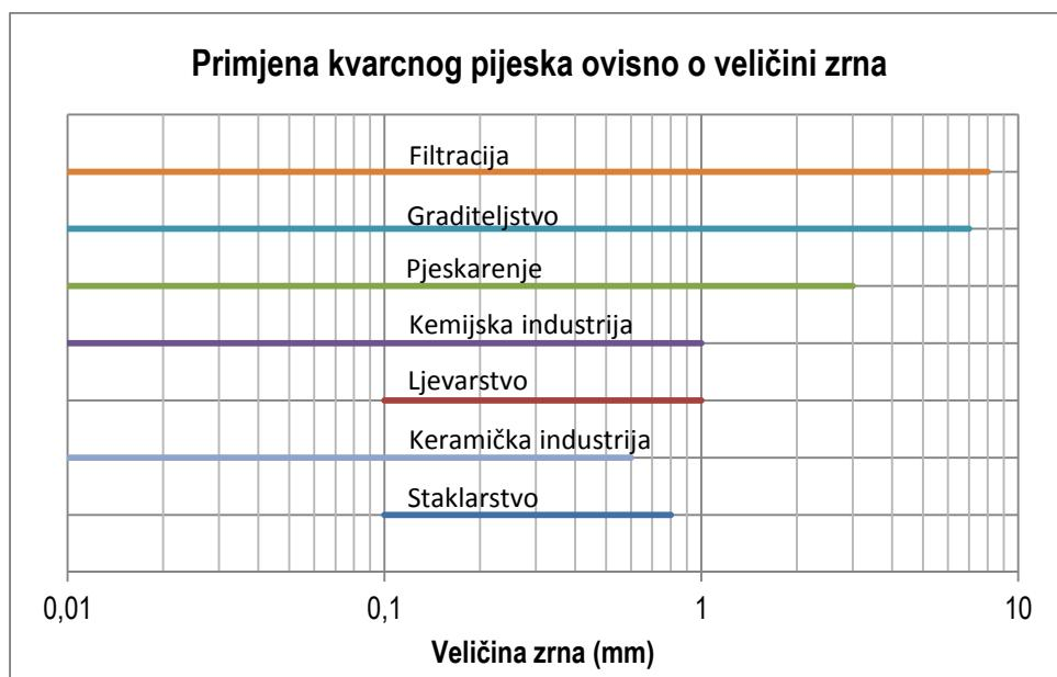
Slika 5-3. Primjena različitih granulacija kvarcnog pijeska (Sobota, 2009)
