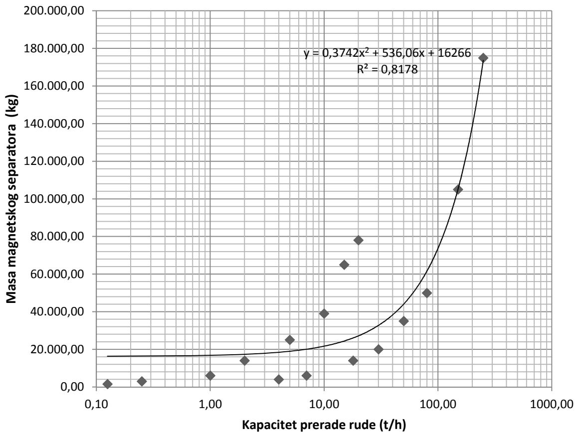
Slika 9b. Grafički prikaz mase visokointenzivnog mokrog magnetskog separatora u odnosu na kapacitet prerade rude
