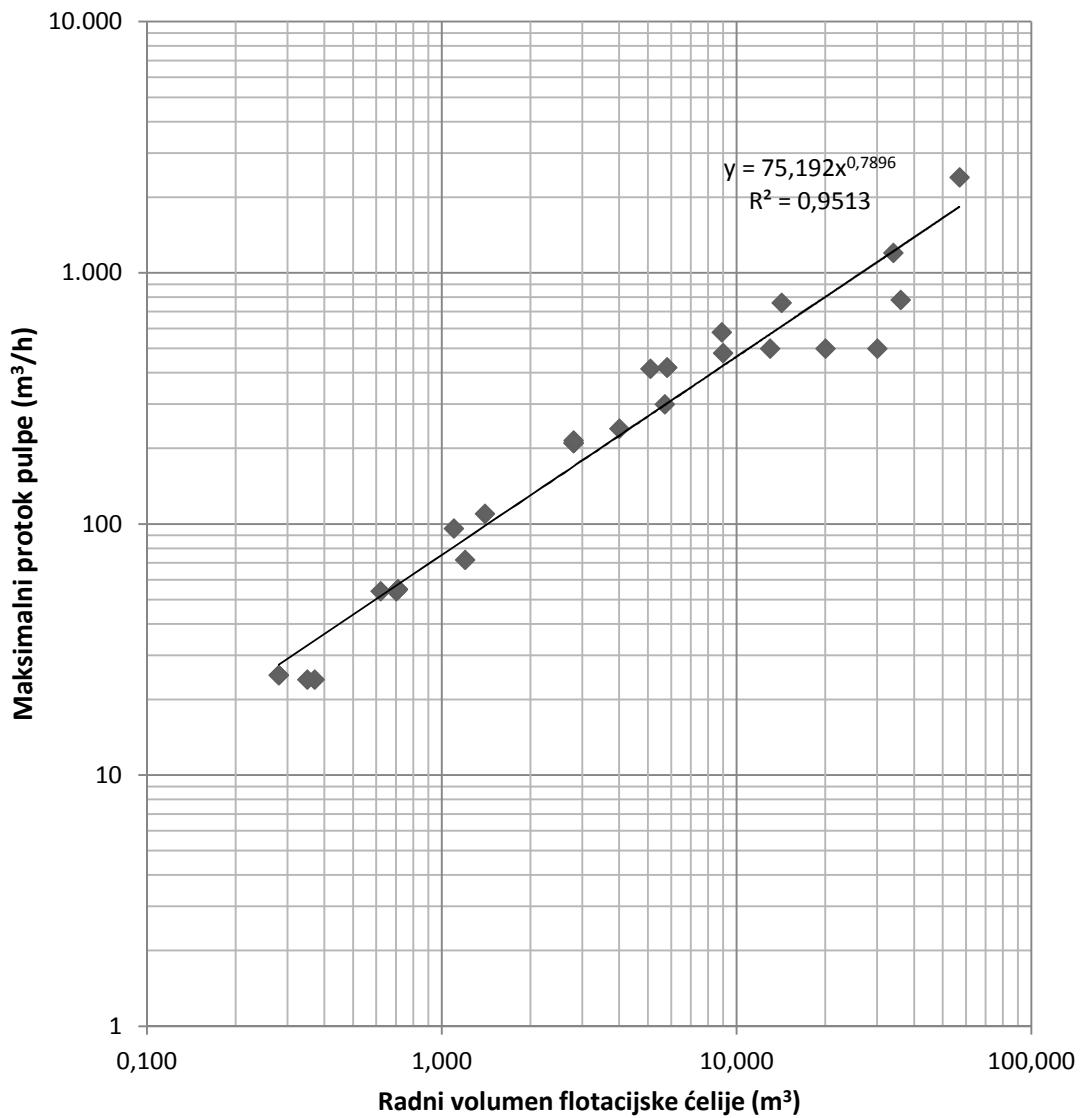
Slika 8c. Grafički prikaz protoka pulpe u odnosu na radni volumen flotacijske čelije
