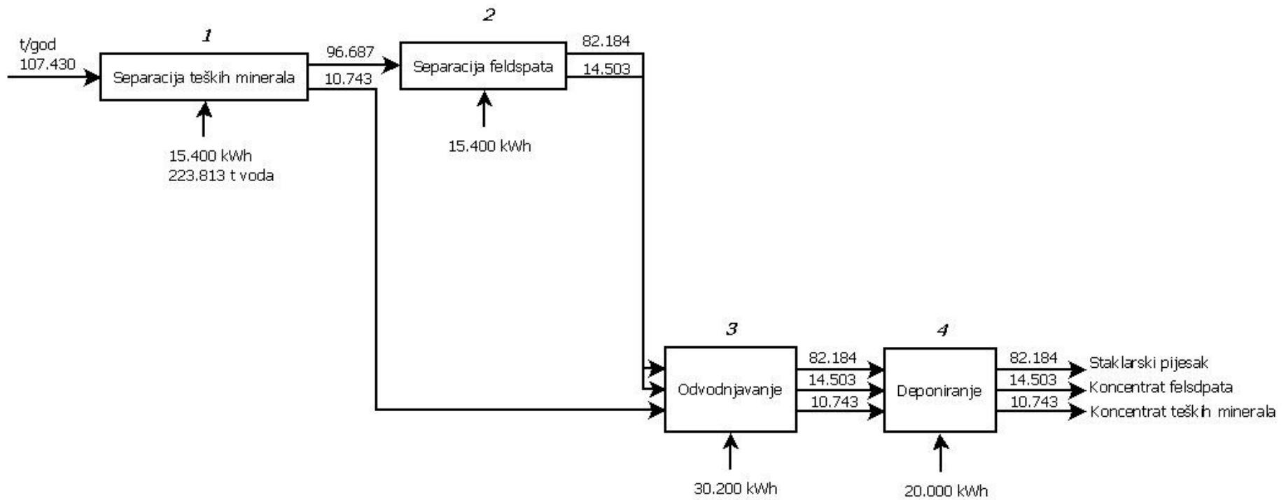
Slika 8-5. Proizvodni proces oplemenjivanja kvarcnog pjeska postupkom gravitacijske koncentracije
