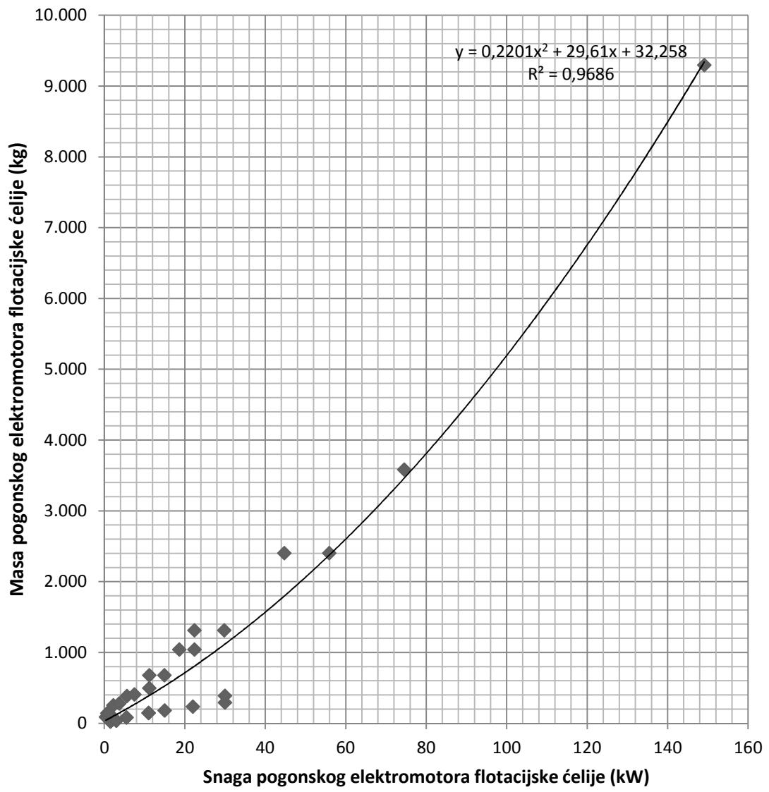
Slika 8d. Grafički prikaz mase u odnosu na snagu elektromotora
