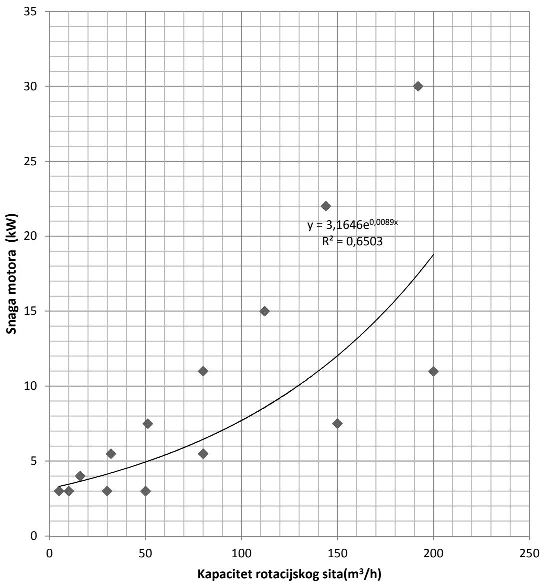
Slika 3a. Grafički prikaz snage elektromotora u odnosu na kapacitet rotacijskog sita
