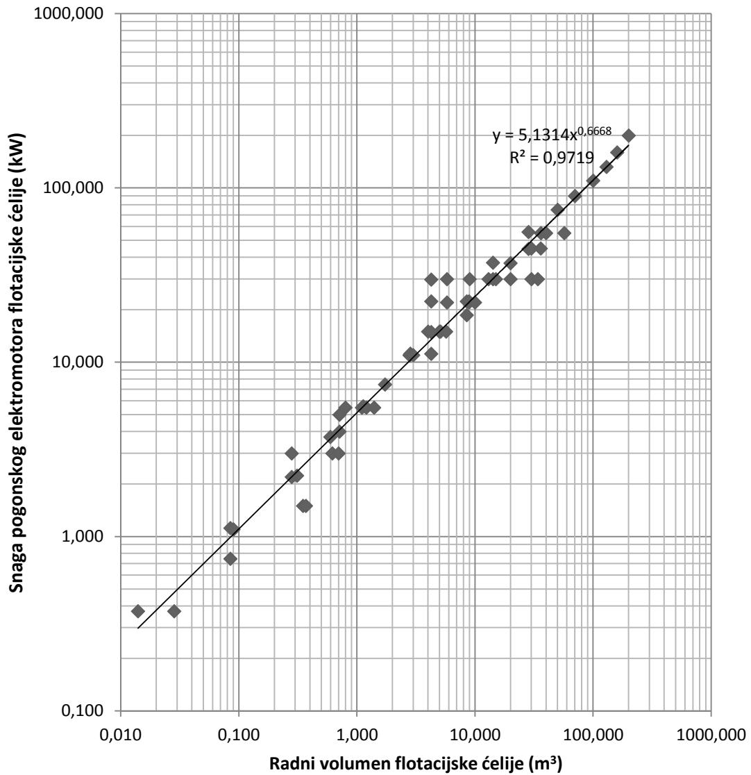
Slika 8a. Grafički prikaz snage pogonskog elektromotora u odnosu na radni volumen flotacijske čelije
