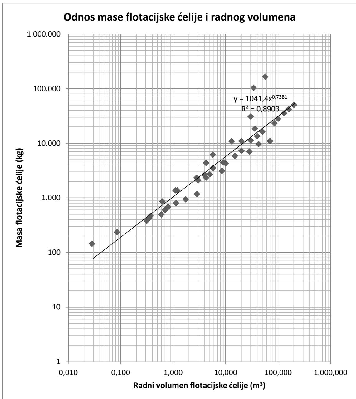
**Slika 8b.** Grafički prikaz mase flotacijske čelije u odnosu na radni volumen
