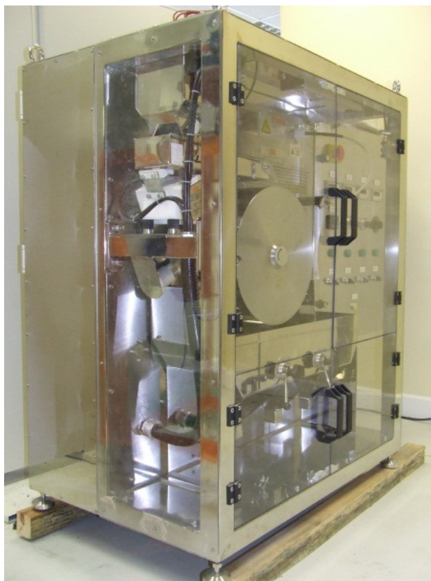
Slika 7-13. Elektrostatički separator ERIEZ (Eriez, 2014b)
