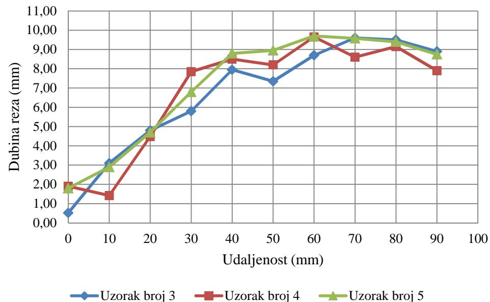
Slika 6-75. Dijagram uzdužnih presjeka dubine reza, iniciranje paralelno s uzdužnom osi
