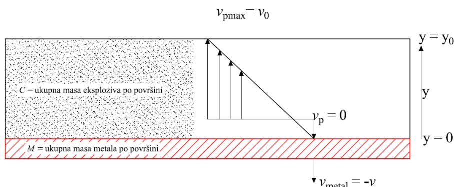
Slika 5-1. Sendvič-sustav eksploziva i metala i prepostavljena raspodjela brzina.
