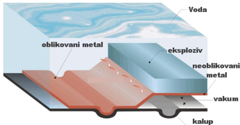
Slika 3-4. Shema oblikovanja metala eksplozivom primjenom kontaktne metode
