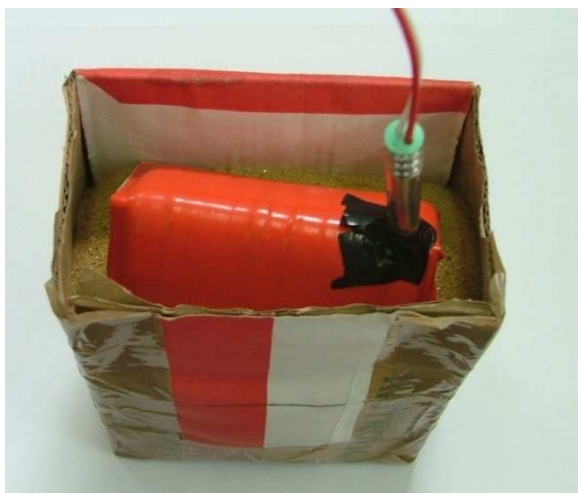
Slika 6-19. Ispitivanje oblika i stanja obloge –postav II u pijesku
