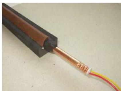
a) detonator paralelan s osi
