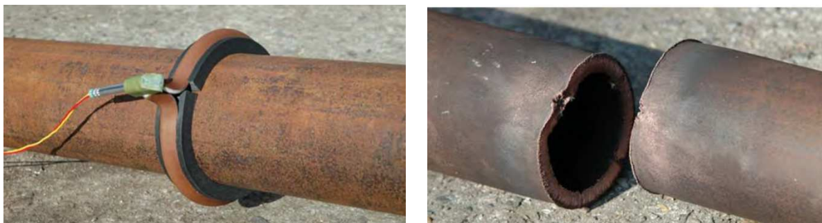
Slika 4-8. Savitljivi linijski kumulativni rezač postavljen na cijev i prerezana cijev
