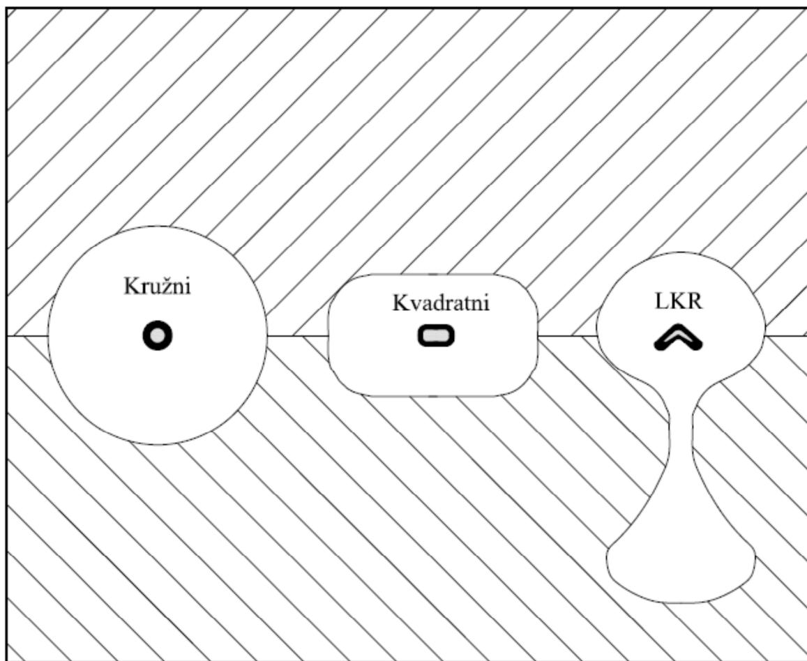
Slika 4-6. Poprečni presjeci šupljina nastalih nakon detonacije (Barbour 1981)
