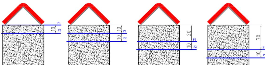
Slika 6-27. Mjerni postav sa konstantnom udaljenosti između svjetlovoda
