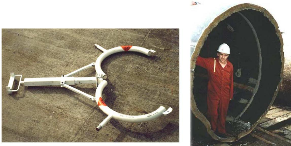
Slika 4-12. Kružni vanjski rezač i presječena cijev
