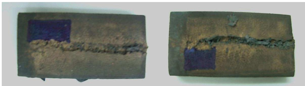
a)detonator paralelan s uzdužnom osi rezaca      b)detonator okomit na uzdužnu os rezaca
