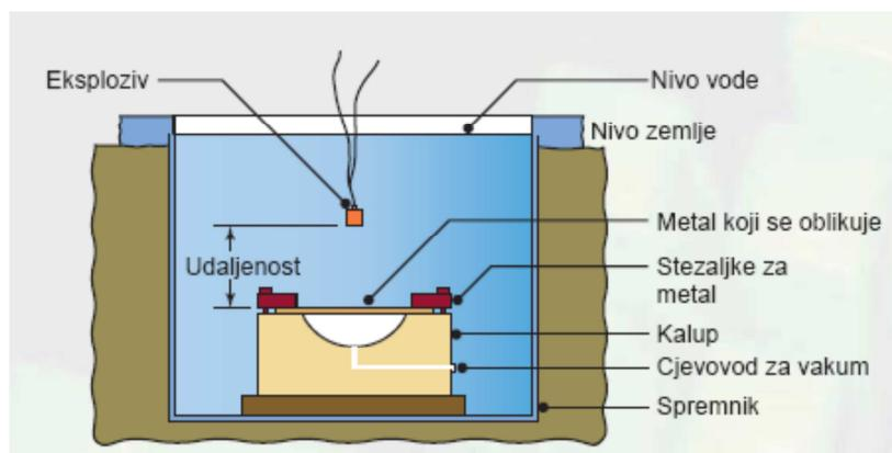
Slika 3-5. Shema oblikovanja metala eksplozivom primjenom nekontaktne metode
