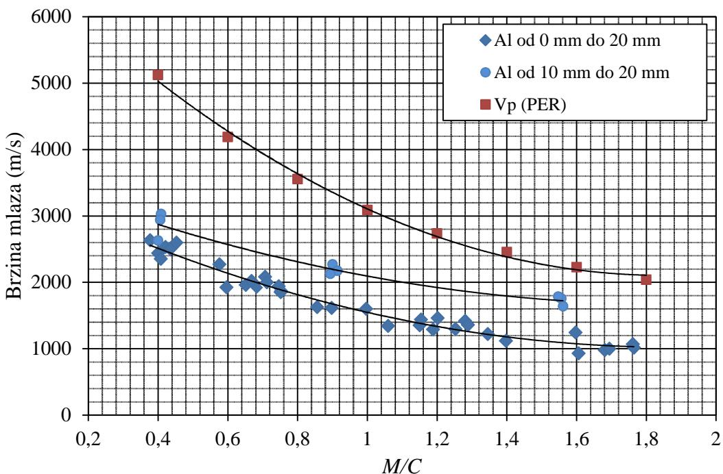
Slika 6-48. Odnos između izmjerениh brzina mlaza i brzine primarnoga mlaza proračunate prema PER teoriji
