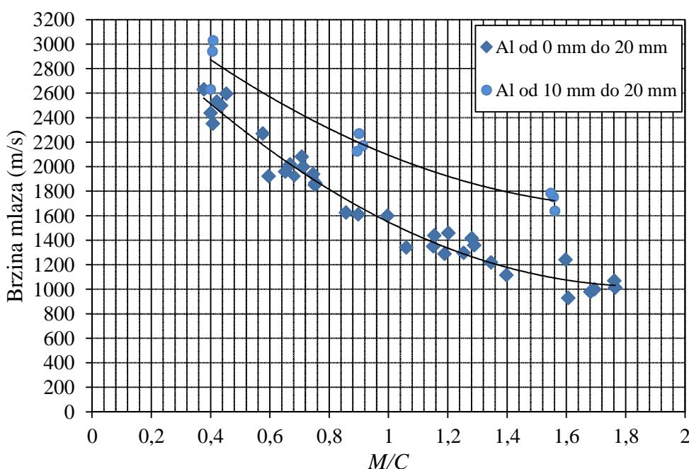
Slika 6-47. Usporedba rezultata mjerjenja brzine Al-obloge na segmentima od 0 mm do 20 mm i od 10 mm do 20 mm za različite  $M/C$  odnose.
