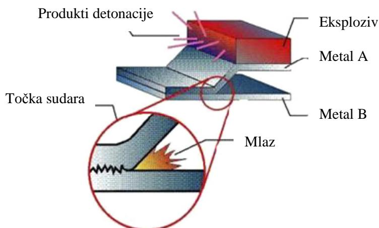
Slika 3-1. Postupak zavarivanja metala eksplozivom (Akbari Mousavi & Al-Hassani 2008)
