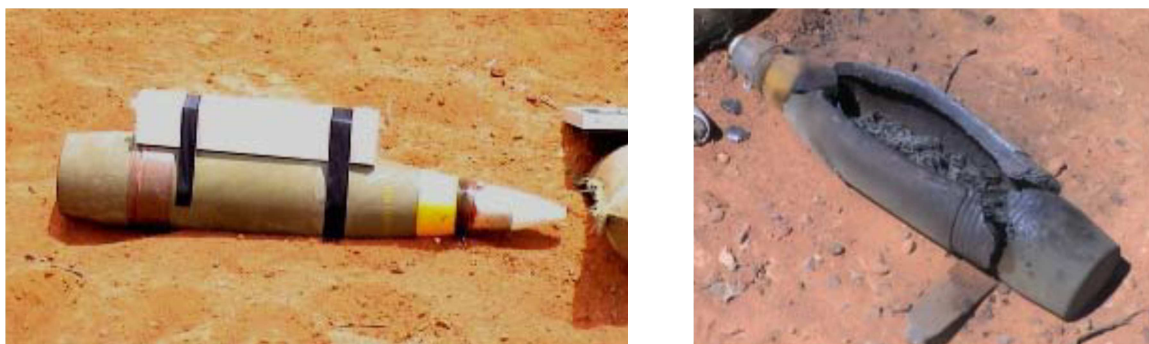
Slika 4-15. Upotreba LKR-a za neutralizaciju bojeve glave
