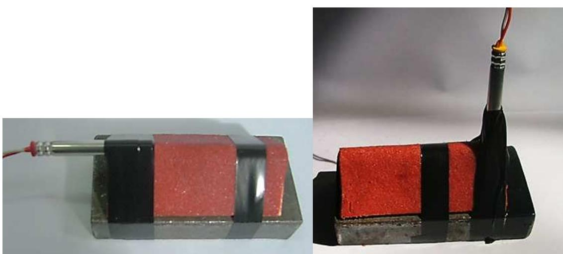
a)detonator paralelan s uzdužnom osi rezača      b)detonator okomit na uzdužnu os rezača
