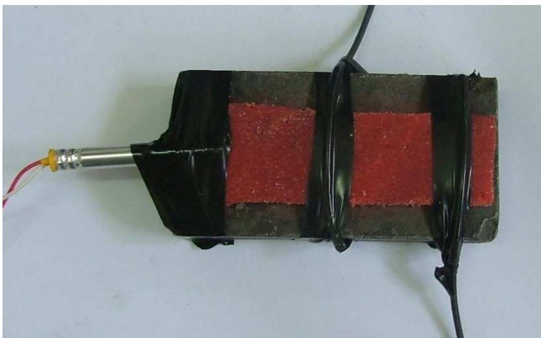
Slika 6-8. Postav mjerena brzine detonacije eksploziva
