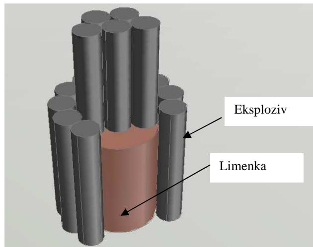
Slika 4-5. Munroeva konstrukcija kumulativnog naboja
