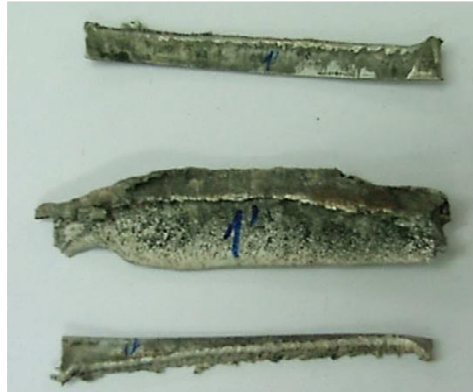
Slika 6-22. Ostaci Al obloge otpucavane u pijesku – mjerni postav II
