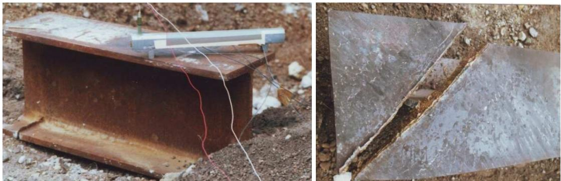
Slika 4-4. Linijski (linearni) kumulativni naboј i rez nakon detonacije (Čačić 1998)
