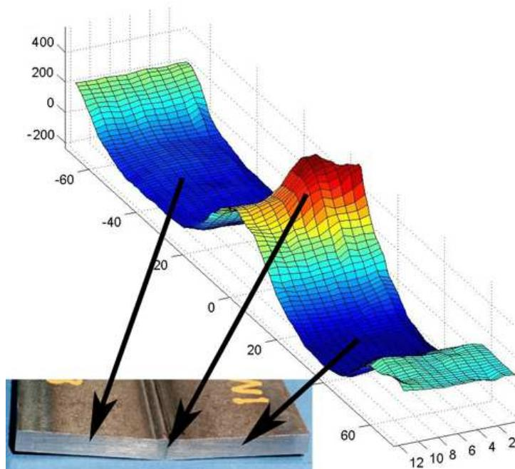
Slika 3-9. Zaostala deformacija i dijagram raspodjele zaostalih naprezanja
