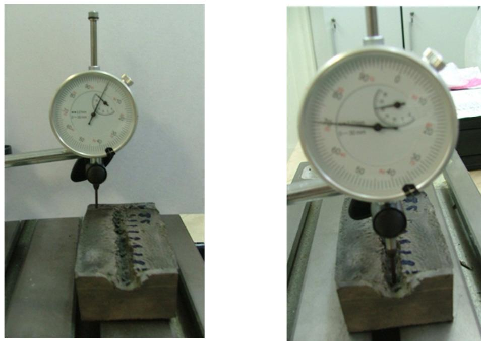
a) pozicioniranje mikroure prije početka mjerena      b) mjerene dubine reza
