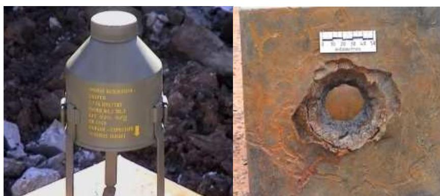
Slika 4-3. Konusni kumulativni naboj i perforacija nakon detonacije
