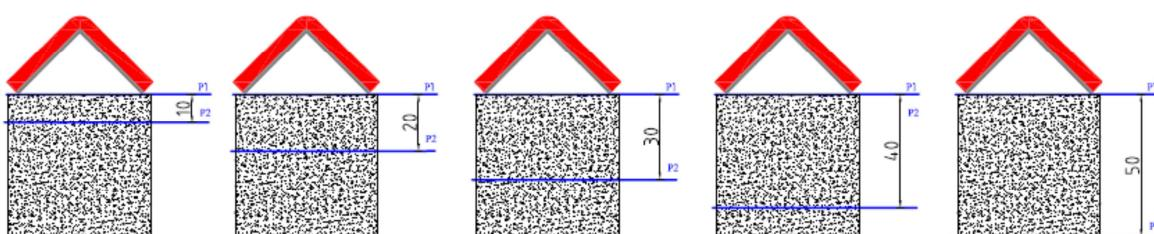
Slika 6-26. Mjerni postav sa promjenljivom udaljenosti između svjetlovoda
