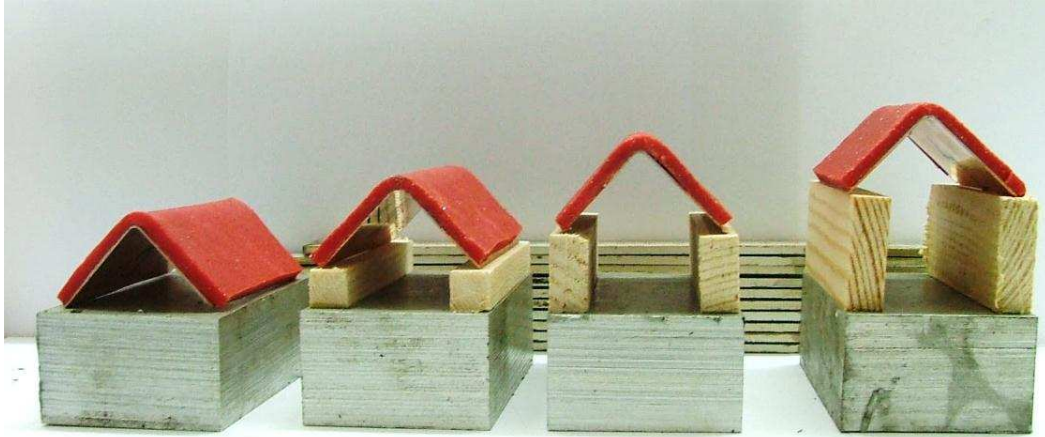
Slika 6-60. Postav ispitivanja prilikom određivanja utjecaja mase eksplozivnog punjenja, odmaka i materijala obloge
