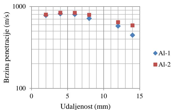
Slika 6-51. Brzina penetracije mlaza u čeliku, linijski kumulativni rezača s Al-oblogom (Miyoshi et al. 2005)
