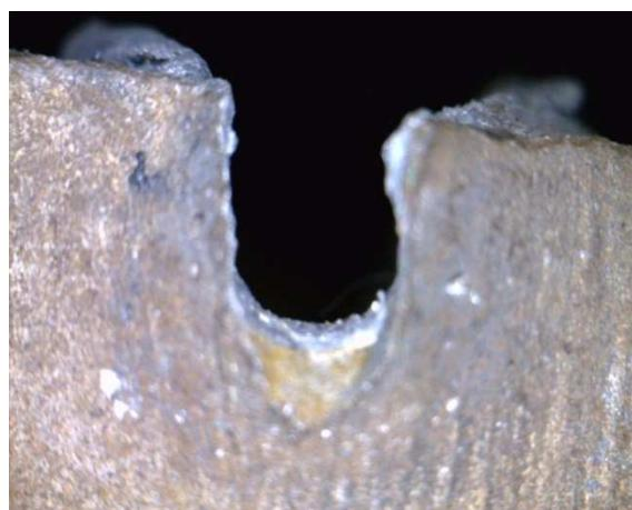
Slika 6-58.      Poprečni presjek reza u metalu
