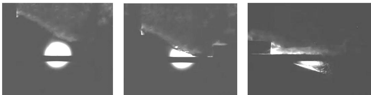
Slika 6-45. Djelovanje mlaza linijskih kumulativnih rezača na metu – snimka I
