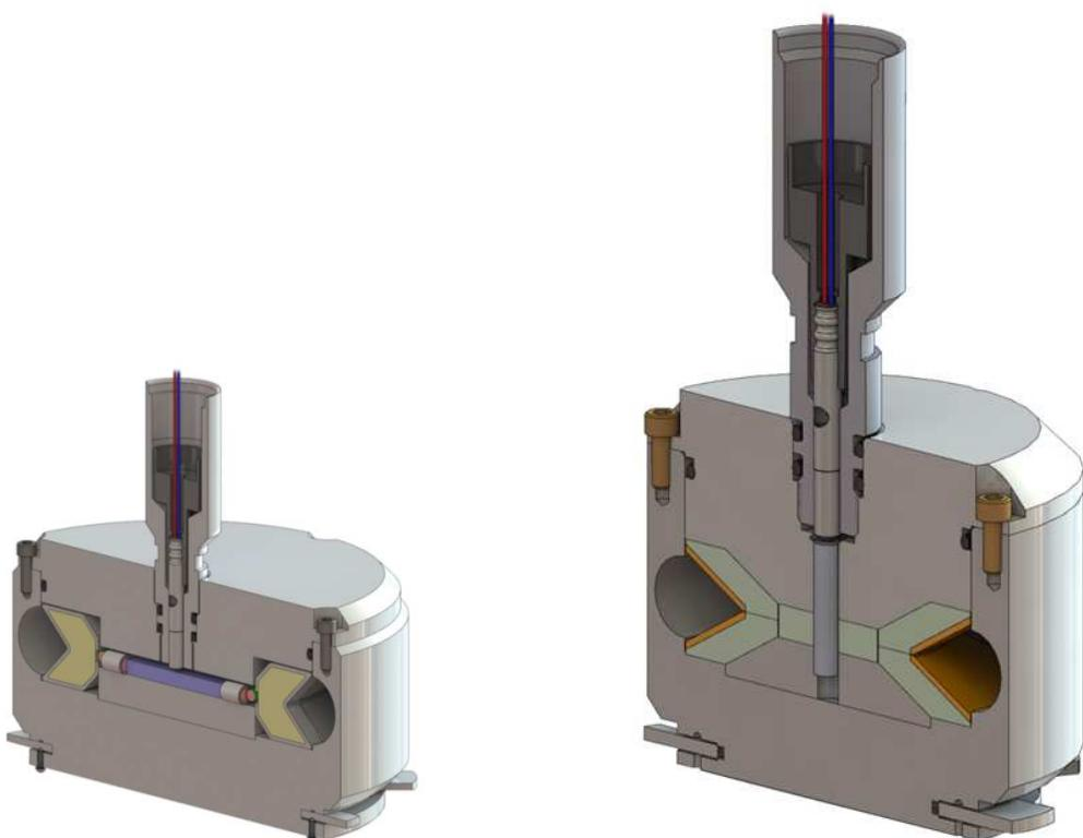
Slika 4-11. Linijski kumulativni rezači za rezanje bušotinske cijevi.
