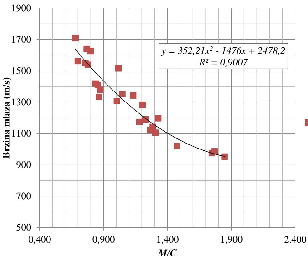
Slika 6-29. Grafički prikaz raspodjele brzine mlaza za Cu-oblogu na razmaku od 20 mm
