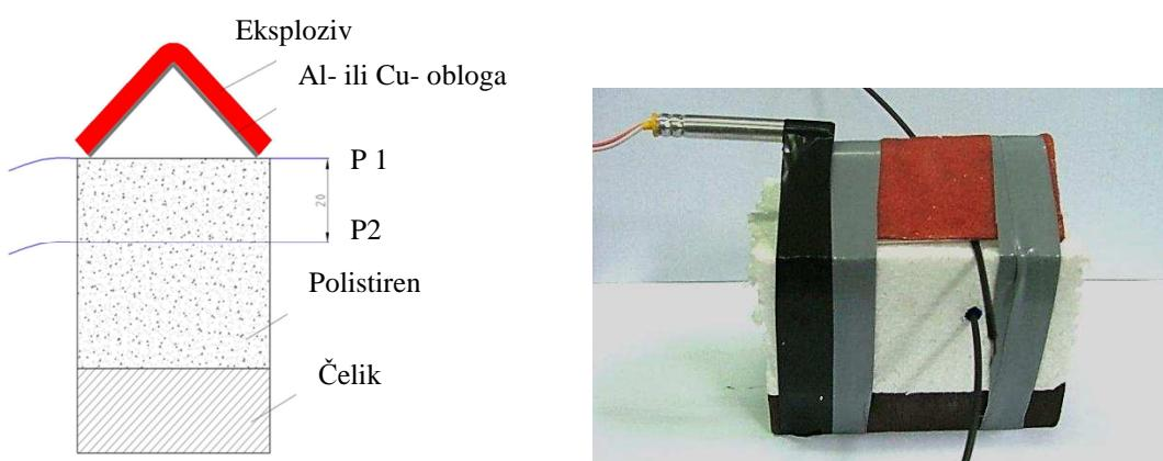
Slika 6-25. Mjerni postav mjerena brzine mlaza linijskog kumulativnog rezača
