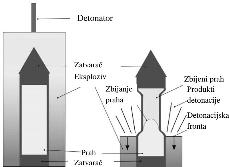
Slika 3-13. Kompaktiranje prahova primjenom cilindra (Farinha et al. 2009)
