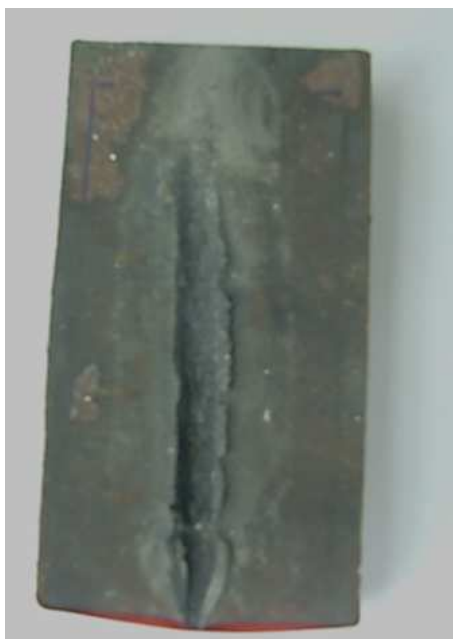
Rez u čeličnoj meti
