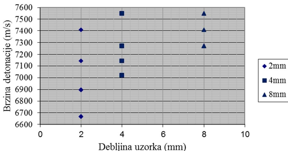
Slika 6-9. Grafički prikaz rezultata mjerjenja brzine detonacije eksploziva.
