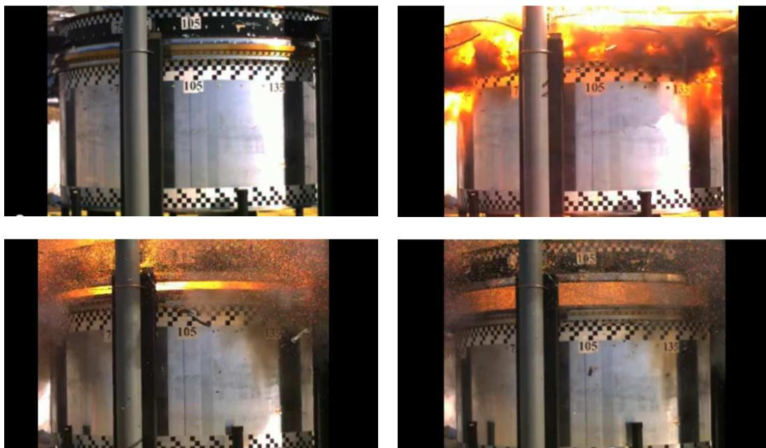
Slika 4-14. Upotreba linijskog rezača za razdvajanje raketnog motora od tijela letjelice
