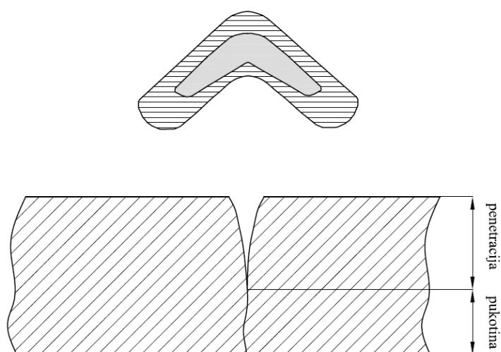
Slika 4-7. Princip djelovanja linijskog kumulativnoga rezača (Barbour 1981)
