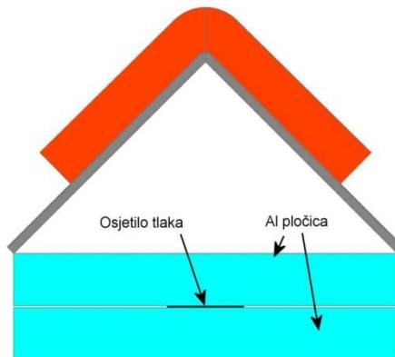
Slika 6-38. Mjerjenje tlaka mlaza - mjerni postav I (osjetilo između Al-pločica)
