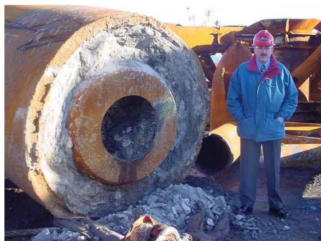
Slika 4-13. Nosivi stup platforme presječen linijskim kumulativnim rezačem
