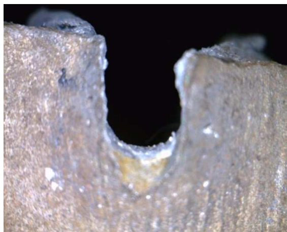
Slika 6-58. Poprečni presjek reza u metalu
