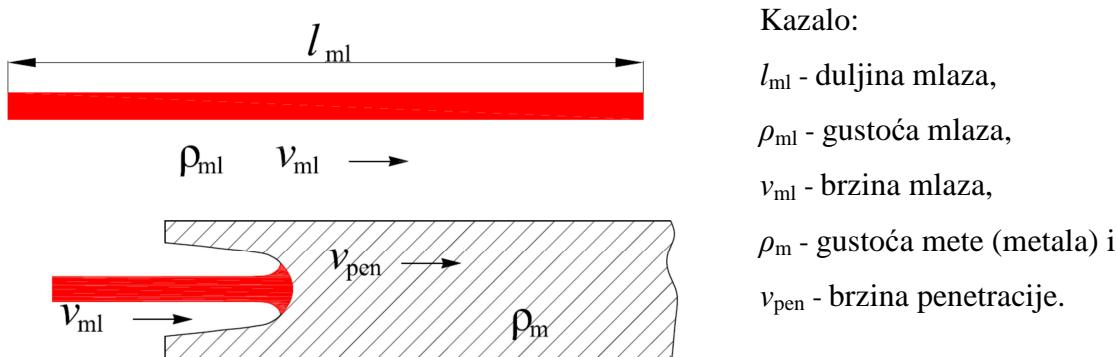
Slika 5-10. Penetracija mlaza konstantne brzine i duljine
