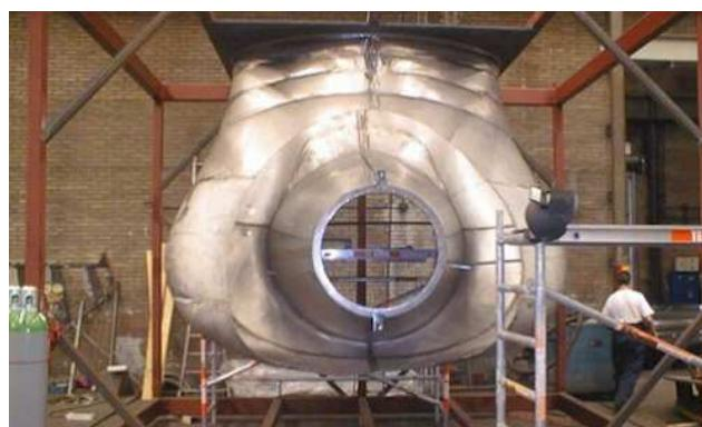
Slika 3-6. Rolls-Royce MT30 ispušni kolektor (<http://www.3dmetalforming.com>)
