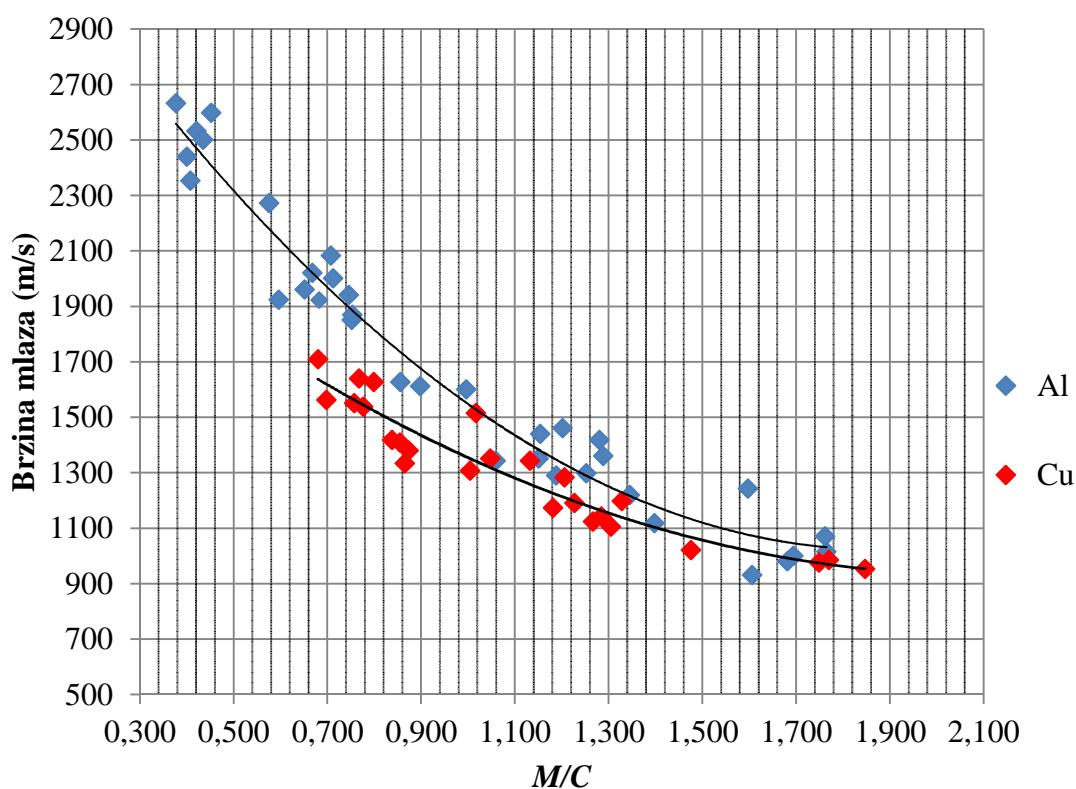
Slika 6-30. Usporedni prikaz brzine mlaza za Al- i Cu-oblogu na razmaku od 20 mm
