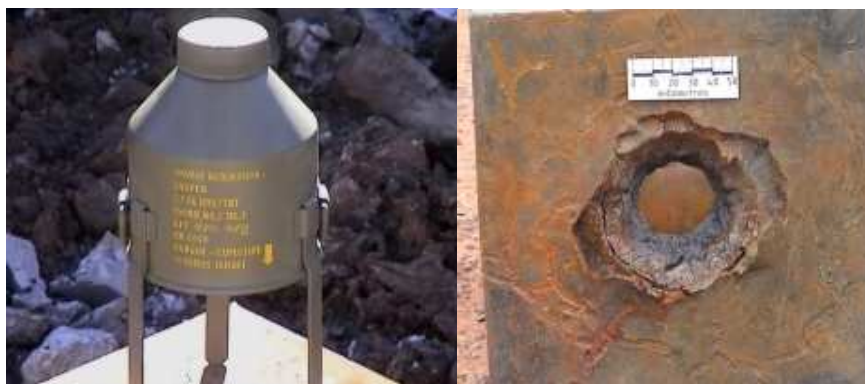
Slika 4-3. Konusni kumulativni naboj i perforacija nakon detonacije ( www.appliedexplosives.com/images/stories/smallbook.pdf )
