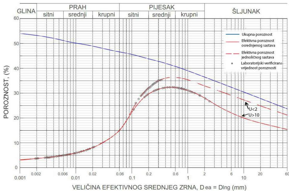
Slika 3.7 Veličina efektivne poroznosti u funkciji srednjeg zrna  $D_{\text{lng}}$ . Opaska: Crkana krivulja odgovara jednoličnim zrnima,  $U < 2$ , a verificirani uzorci dobro graduiranih šljunaka i pijeska na punoj crti su za  $U > 10$ . Točke na dijagramu, označene kružnicom, predstavljaju veličinu efektivne poroznosti verificiranu izračunom hidrauličke vodljivosti Kozeny – Carman metodom
