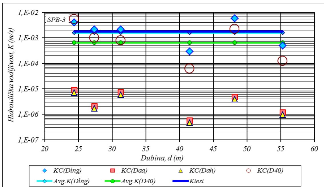
Slika 5.8 Rezultati K korištenjem KC metode uz različite D za buštinu SPB-3
