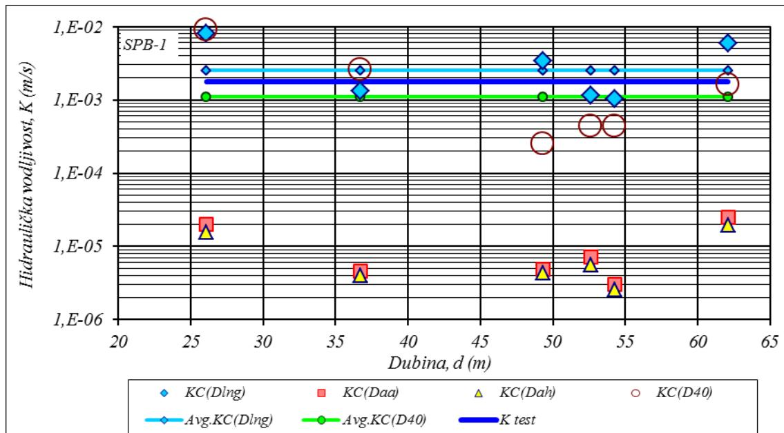
Slika 5.6 Rezultati K korištenjem KC metode uz različite D za buštinu SPB-1
