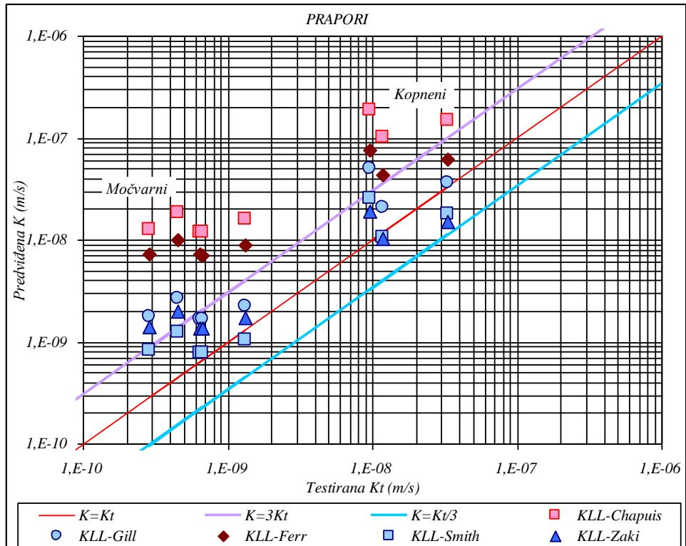
Slika 6.8 Grafička korelacija testirane i izračunate hidrauličke vodljivosti određene Kozeny-Carmanovom jednadžbom korištenjem specifične površine iz korelacije s granicom tečenja
