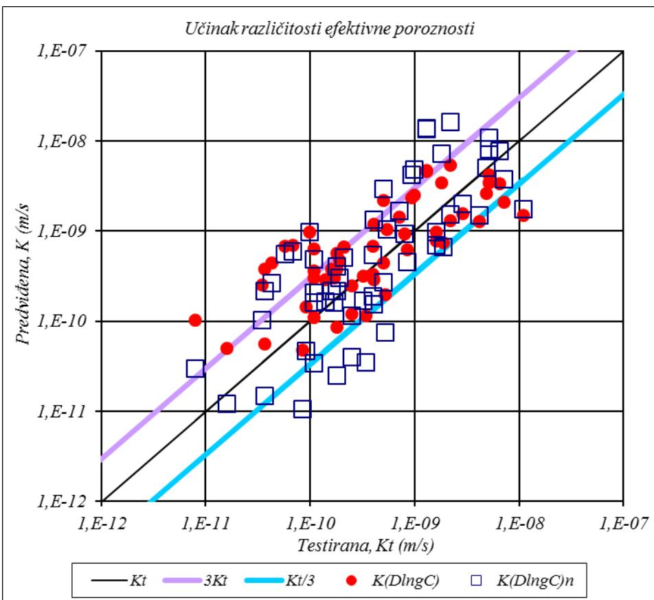
Slika 6.12 Grafička korelacija testirane i izračunane hidrauličke vodljivosti uz primjenu jedinstvene srednje veličine efektivne poroznosti  $K(D_{\ln g}C)$  i efektivne poroznosti  $K(D_{\ln g}C)n$  u funkciji veličine efektivnog zrna prema krivulji na slici 3.7
