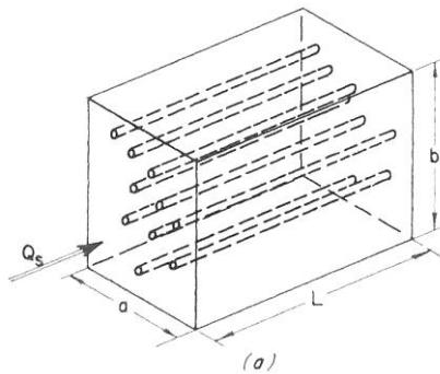
Slika 5.1 Model kapilarnih cjevčica (prema Bear, 1984)
