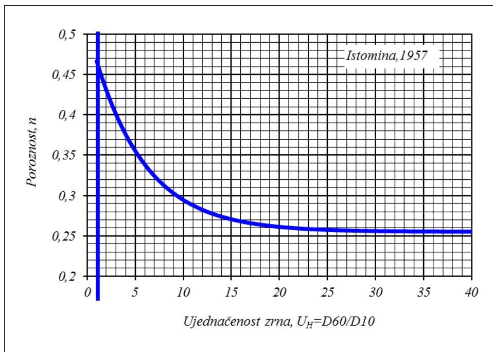
Slika 3.6 Dijagram poroznosti prema jedn. 3.14 (Istomina, 1957)
