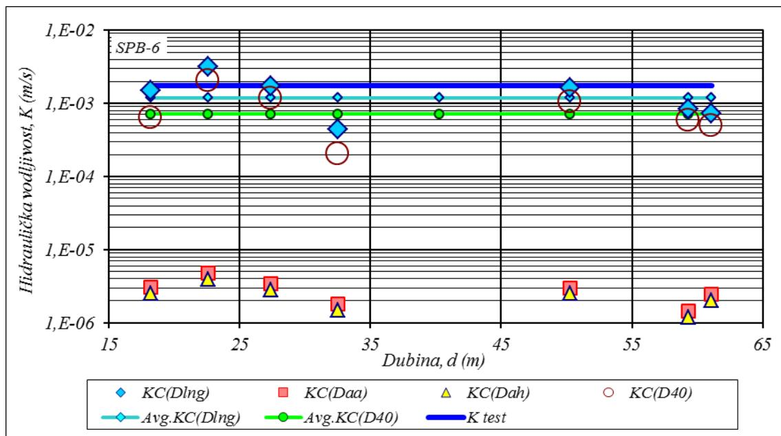
Slika 5.11 Rezultati K korištenjem KC metode uz različite D za buštinu SPB-6
