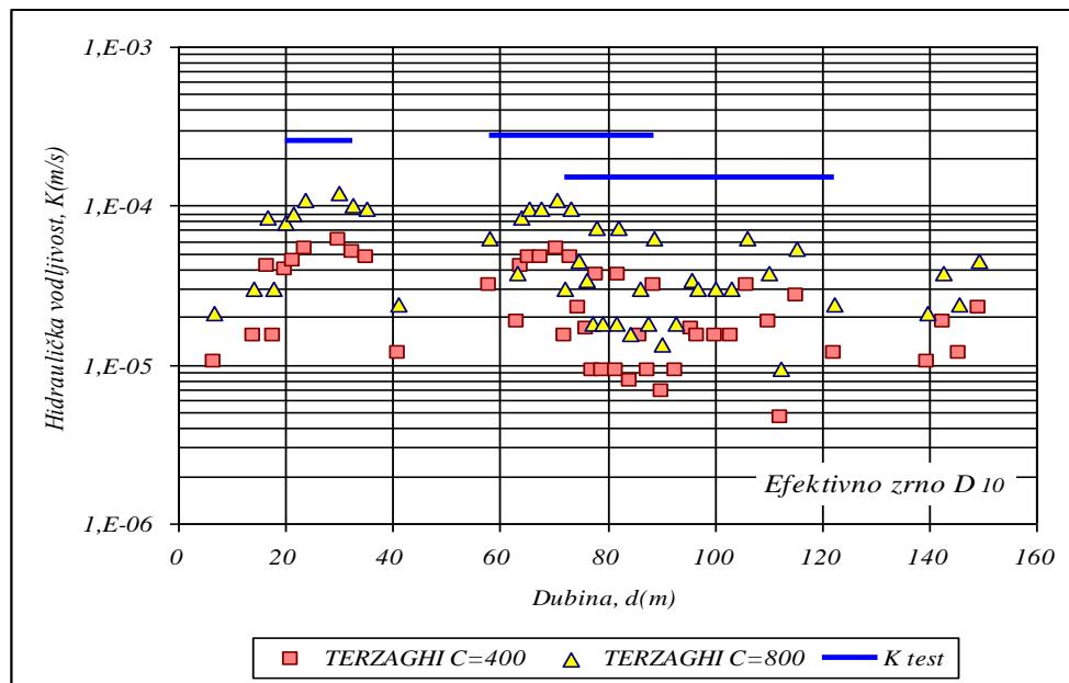
Slika 4.8 Grafička ilustracija razlike srednje hidrauličke vodljivosti vodonosnika i rezultata izračuna prema publiciranim obrascima Terzagijeve metode (jedn 4.12) za granice raspona koeficijenta  $C=400 \text{ cm}^{-1}\text{s}^{-1}$ (hrapavo zrno) i  $800 \text{ cm}^{-1}\text{s}^{-1}$ (glatko zrno)
