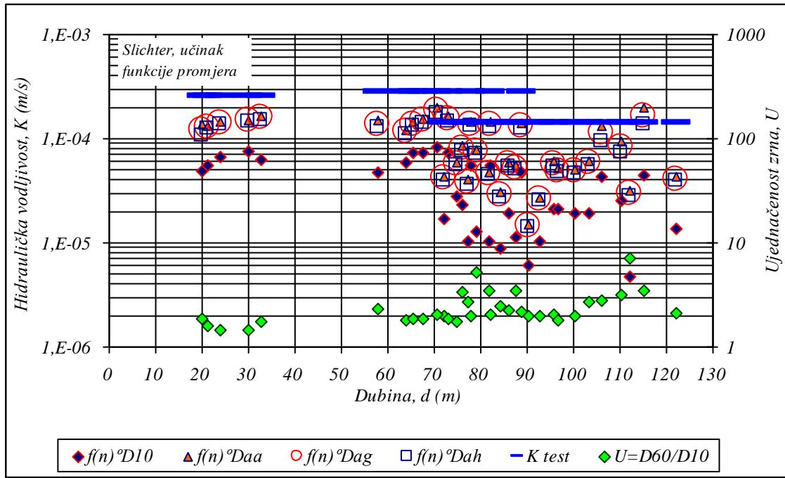
Slika 4.3 Usporedni prikaz izračuna K iz podataka granulometrijske krivulje uzoraka pjeska iz triju bušotina na pokusnim poljima Označe:  $f(n)^0$  Slichterova funkcija poroznosti,  $D_{10}$  Hazenovo efektivno zrno, Aritmetički zbroj udjela aritmetičke  $D_{aa}$ , geometrijske  $D_{ag}$  i harmonijske  $D_{ah}$  sredine promjera zrna u pojedinim prosjevima
