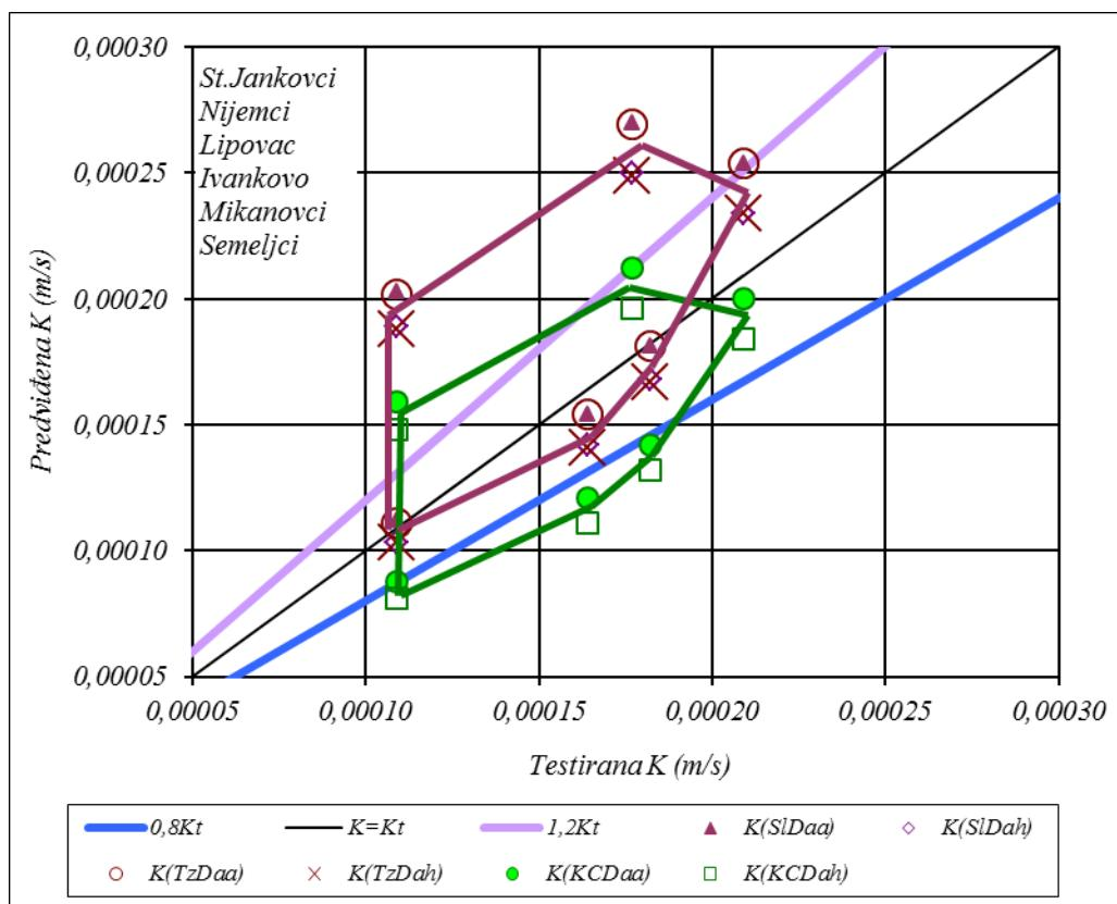
Slika 5.15 Grafička korelacija rezultata izračuna hidrauličke vodljivosti pješčanih vodonosnika u istočnoj Slavoniji i Srijemu sa lokaliteta s ograničenom valjanostju uzoraka metodama srednjeg zrna
