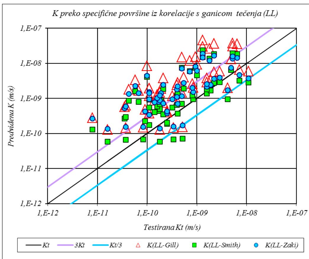
Slika 6.10 Grafička korelacija testirane i izračunane hidrauličke vodljivosti odredene Kozeny-Carmanovom jednadžbom korištenjem specifične površine iz korelacije s granicom tečenja svih analiza iz bušotina po trasi kanala Dunav-Sava pomoću triju najuspješnijih korelacija (Gill & Reavs, 1957; Smith et al. 1985; Zaki Gazalli, 1971) Oznake:  $K(D_{LNG}C)_n$  – prema jedn 6.3,  $K(D_{LNG}L)_n$  – prema jedn 6.5
