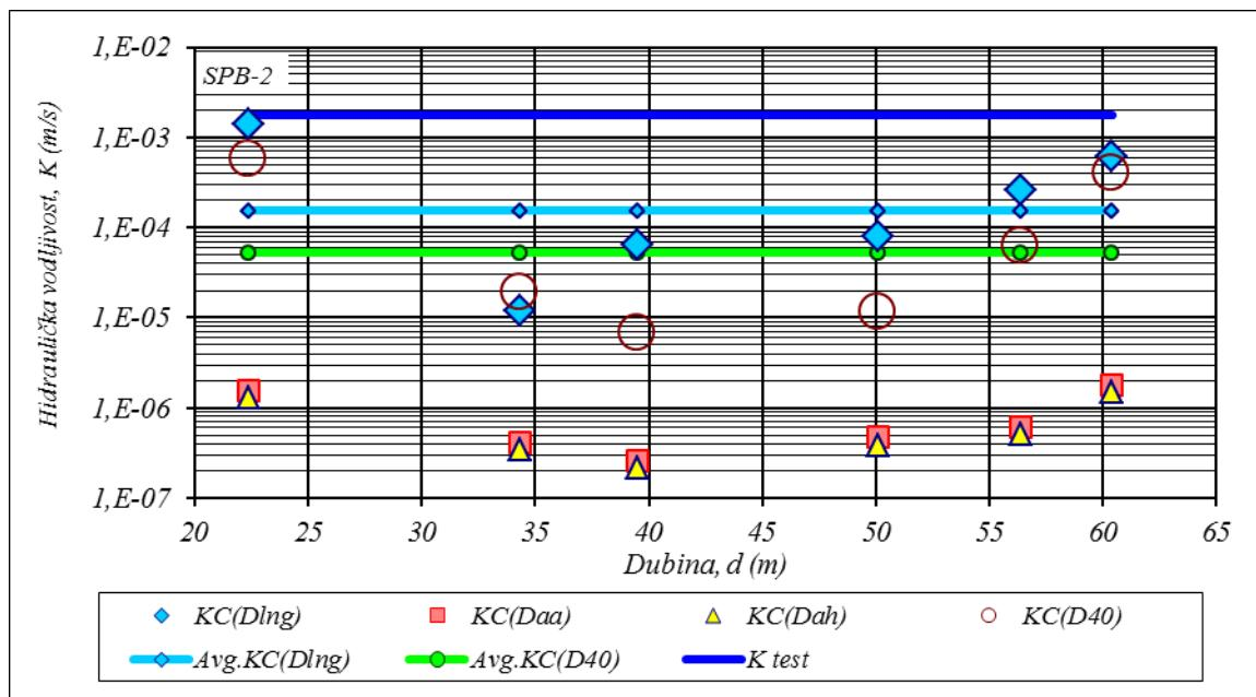
Slika 5.7 Rezultati K korištenjem KC metode uz različite D za buštinu SPB-2
