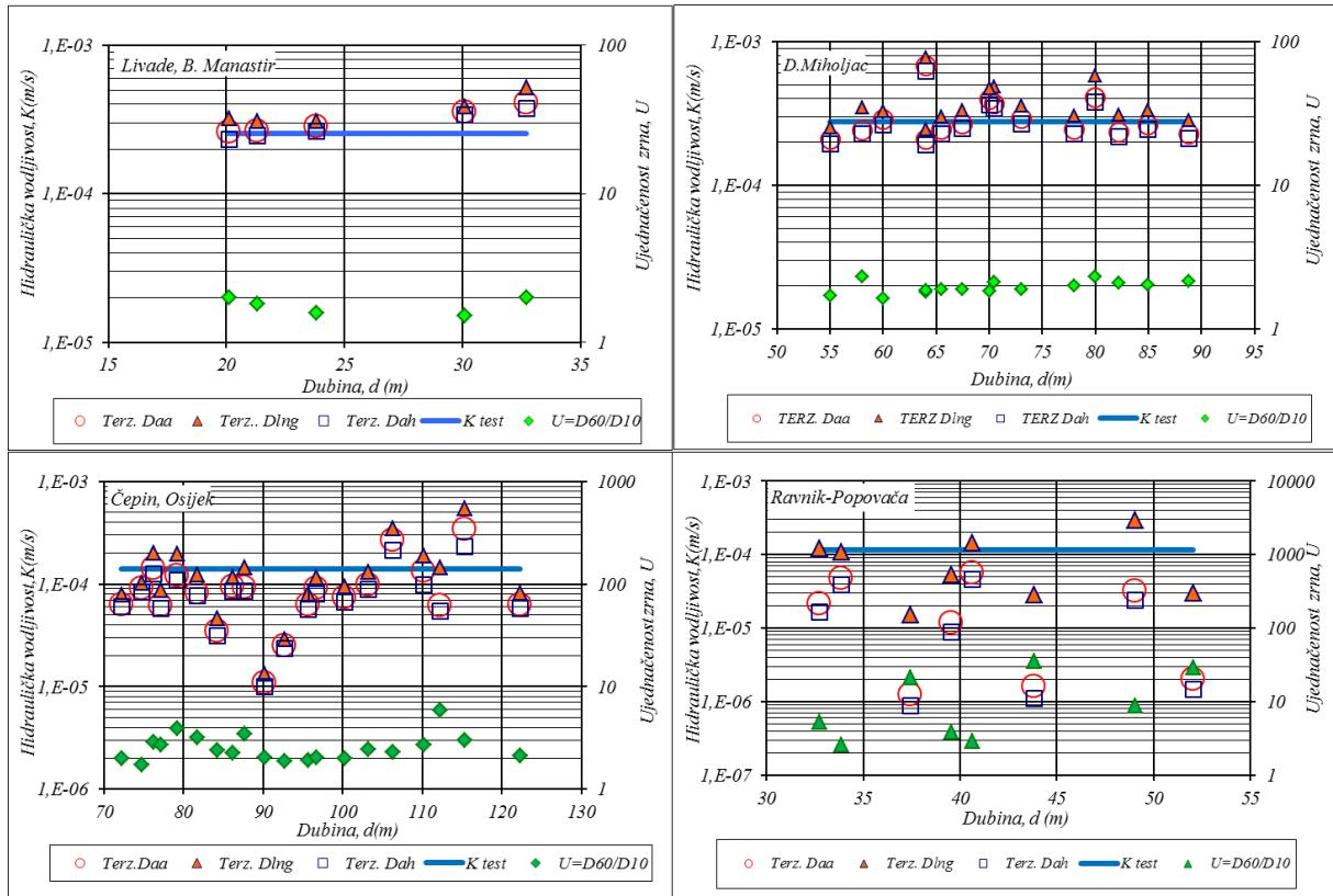
Slika 4.11 Usporedni prikaz srednje hidrauličke vodljivosti vodonosnika s vrijednostima izračuna prema novoj Terzaghijevoj jednadžbi (4.14) uz ilustraciju sortiranosti zrna u uzorku
