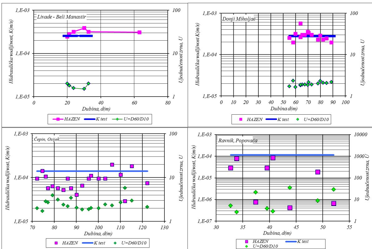
Slika 4.2 Usporedni prikaz srednje hidrauličke vodljivosti vodonosnika s vrijednostima izračuna hidrauličke vodljivosti uzoraka prema Hazenovoj jednadžbi (4.2) za temperaturu  $t=15^\circ\text{C}$  uz prikaz ujednačenosti zrna u uzorcima
