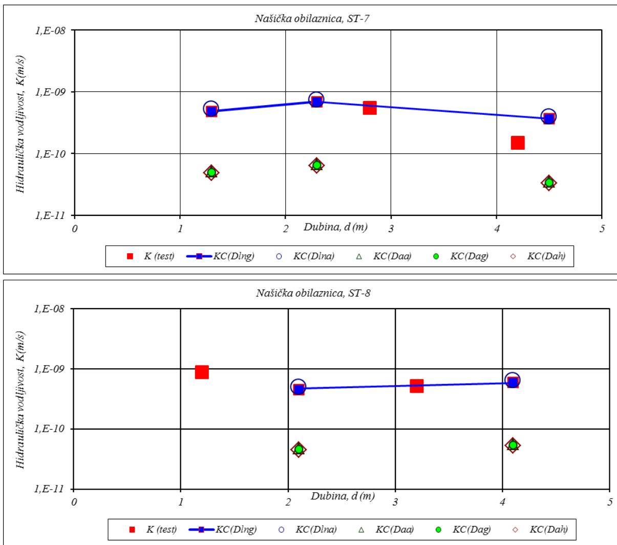
Slika 6.4 Usporedni prikaz rezultata izračuna hidrauličke vodljivosti različitim postupcima izračuna veličine efektivnoga zrna s rezultatima laboratorijskog testiranja na primjeru močvarnih prapora na lokaciji našičke obilaznice – sjeverozapadni dio
