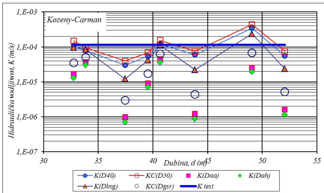
Slika 5.5 Rezultati izračuna hidrauličke vodljivosti analiziranih uzoraka pretežito sitnozrnog pijeska z bušotiny P-1 na pokusnom polju Ravnik kraj Popovače primjenom Kozeny-Carmanove metode
