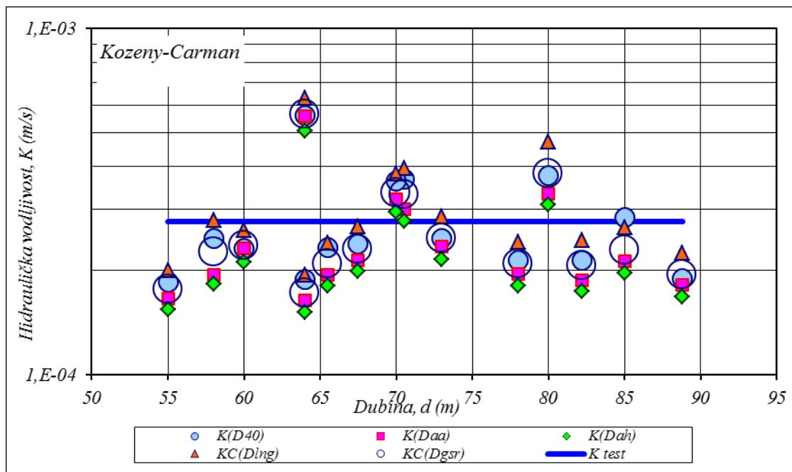
Slika 5.2 Rezultati izračuna hidrauličke vodljivosti analiziranih uzoraka jednoličnog srednjozrnog pjeska iz bušotine DM-1 i MNB-4 na pokusnom polju u Donjem Miholjcu primjenom Kozeny-Carmanove metode
