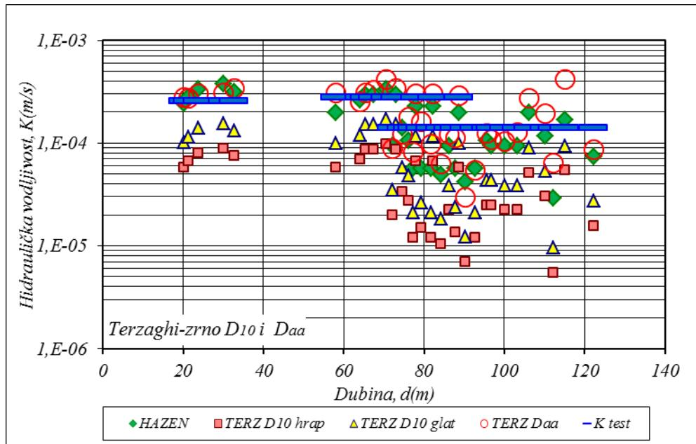
Slika 4.9 Grafička usporedba rezultata izračuna K iz granulometrijskih krivulja uzoraka pjeska iz triju bušotina u D Miholjcu, B, Manastiru i Čepinu prema formuli Hazena i varijantnim jednadžbama Terzagijeve metode (jedn. 4.10 i 4.12)
