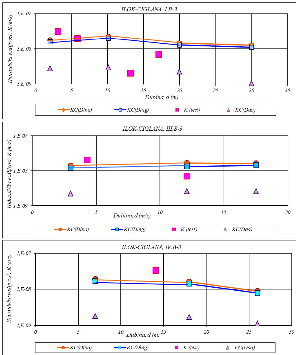
Slika 6.2 Usporedni prikaz rezultata izračuna hidrauličke vodljivosti različitim postupcima izračuna veličine efektivnog zrna s rezultatima laboratorijskog testiranja na primjeru kopnenih praporu na lokaciji iločke ciglane
