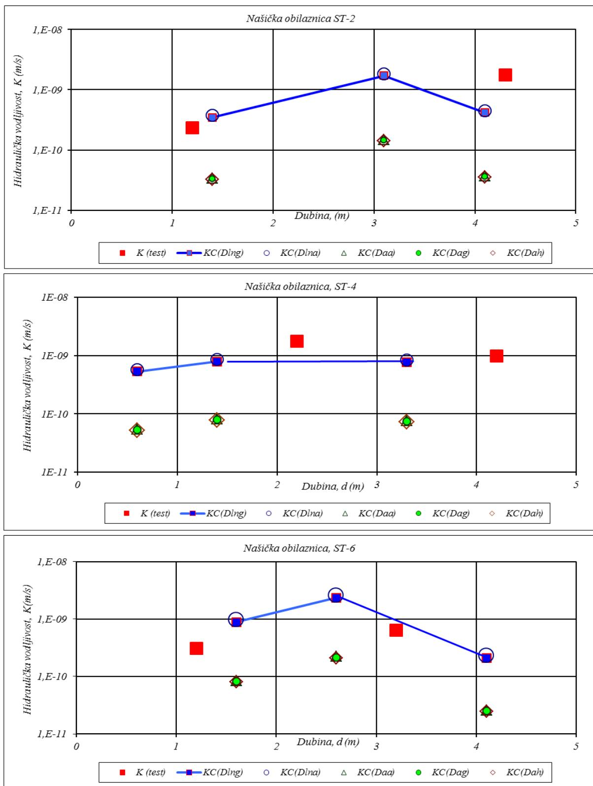
Slika 6.3 Usporedni prikaz rezultata izračuna hidrauličke vodljivosti različitim postupcima izračuna veličine efektivnog zrna s rezultatima laboratorijskog testiranja na primjeru močvarnih praporu na lokaciji našičke obilaznice – sjeverozapadni dio
