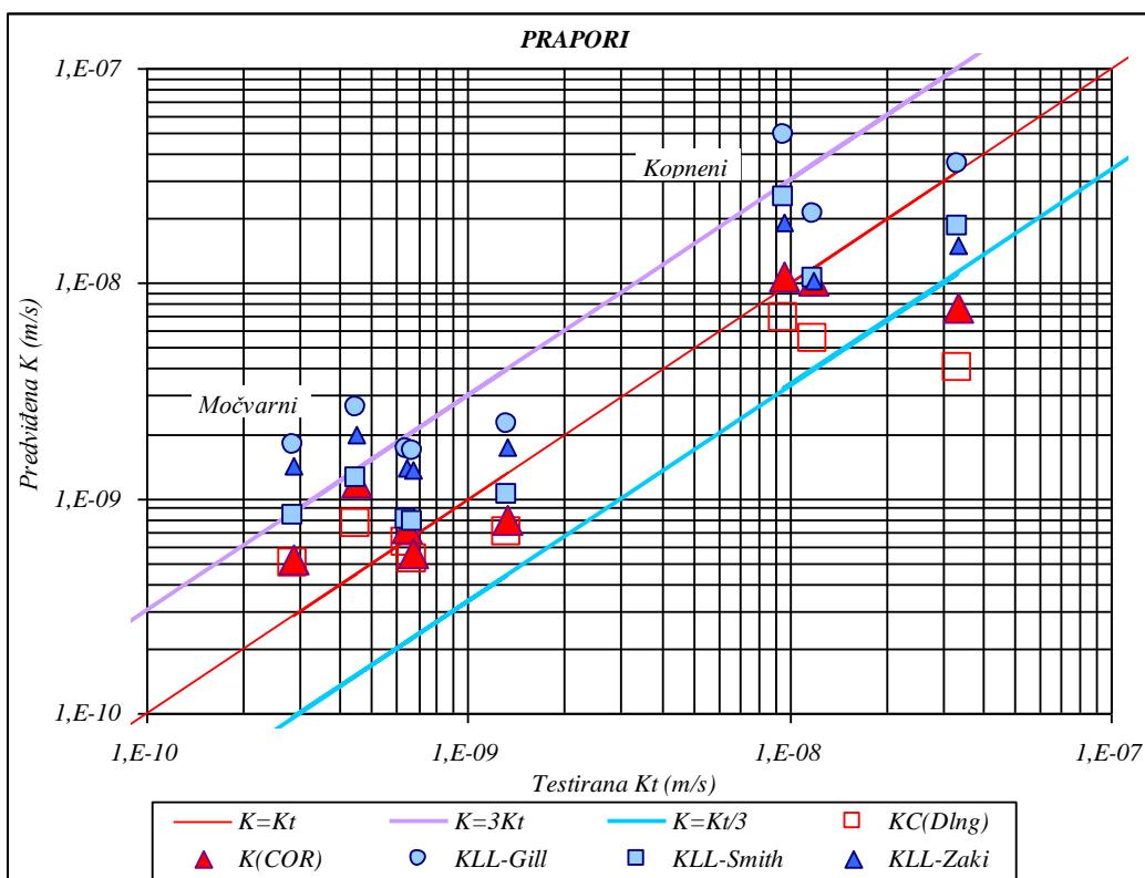
Slika 6.9 Usporedba najuspješnijih rezultata izračuna hidrauličke vodljivosti na temelju korelirane specifične površine ( $K_{LL-Gill}$ ,  $K_{LL-Smith}$  i  $K_{LL-Zaki}$ ) s rezultatima izračuna prema granulometrijskom sastavu ( $KC_{Dlng}$  i  $K_{COR}$ )
