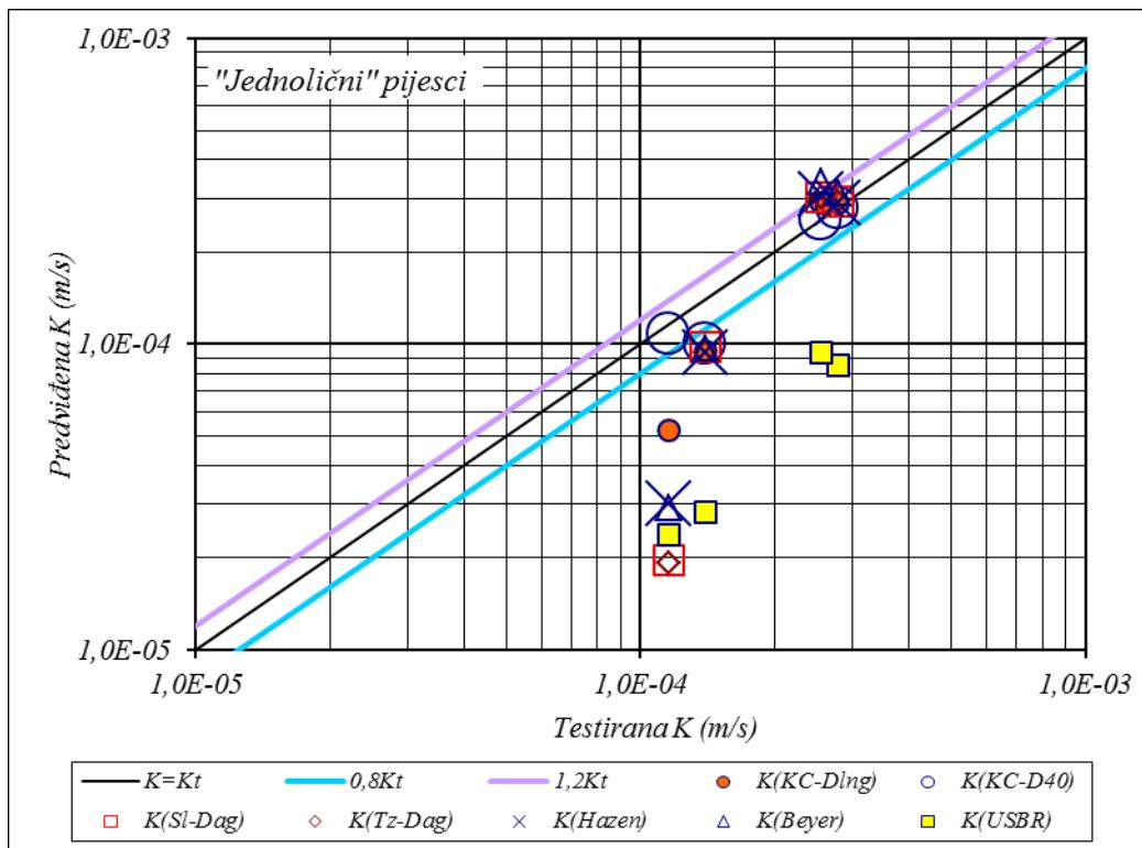
Slika 5.13 Grafička korelacija između testirane hidrauličke vodljivosti pješčanih vodonosnika i najboljih rezultata izračunanih primjenom svih korištenih metoda. Oznake:  $K(\text{Sl}-D_{sr})$  Slichterova metoda korištenjem srednjeg zrna,  $K(\text{T}-D_{sr})$  Terzagijeva metoda korištenjem srednjeg zrna,  $K(\text{T}-D_{sr})$  Terzagijeva metoda korištenjem srednjeg zrna
