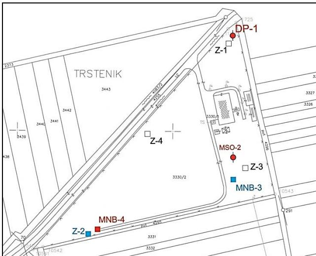
Slika 2.5 Položaj hidrogeoloških objekata na crpilištu Donji Miholjac, M 1:5000. Oznake: MSO-2 - stara istraživačka bušotina; MNB-3 i MNB-4 - stari eksplotacijski zdenci; Z-2 - novi zdenac; Z-1, Z-3 i Z-4 projektirane lokacije za nove zdence; DP-1 – nova istraživačka bušotina
