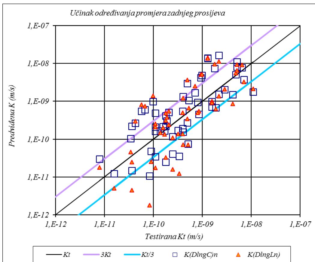
Slika 6.11 Grafička korelacija testirane i izračunane hidrauličke vodljivosti u ovisnosti o načinu određivanja veličine zrna u zadnjem „prosijevu“. Oznake:  $K(D\ln gC)n$  – prema jedn 6.3,  $K(D\ln gL)n$  – prema jedn 6.5
