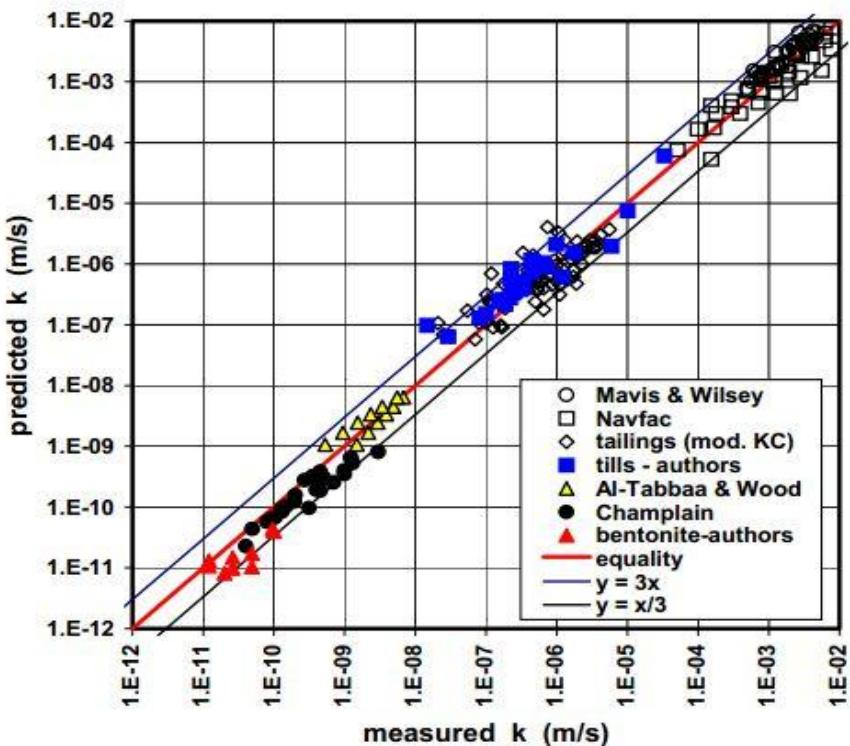
Slika 6.1 Odnos mjerene hidrauličke vodljivosti i predviđene primjenom Kozeny-Carmanove jednadžbe za raznovrsne tvorevine od bentonita i kaolinita do pjesaka i šljunka (iz Chapuis & Aubertin, 2003)
