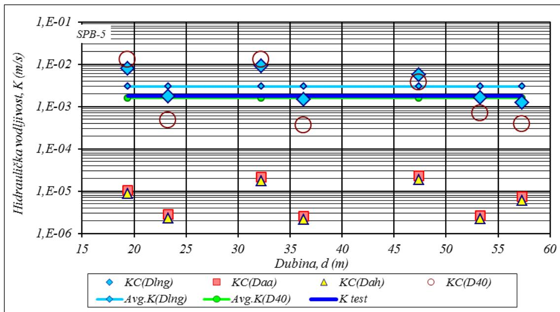
Slika 5.10 Rezultati K korištenjem KC metode uz različite D za buštinu SPB-5
