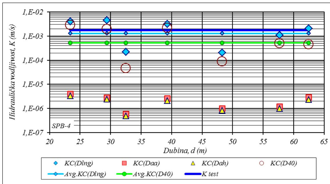
Slika 5.9 Rezultati K korištenjem KC metode uz različite D za buštinu SPB-4
