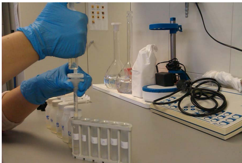
Slika 5.21. Filtriranje uzoraka vodene otopine tla kroz membranu.
