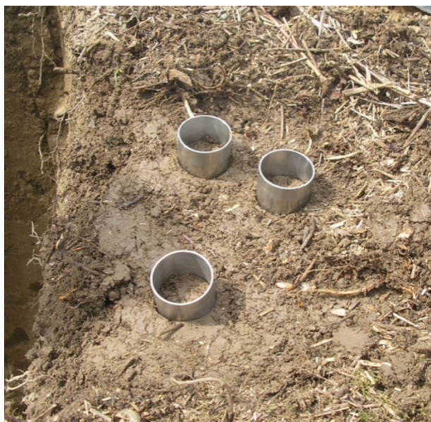
Slika 5.5. Cilindri za uzimanje neporušenih uzoraka tla.
