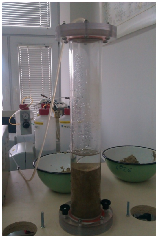
Slika 5.17. Saturacija uzorka s vodom.
