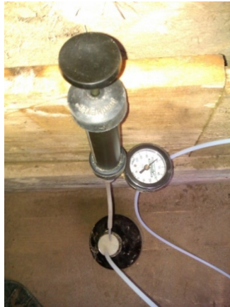
Slika 5.11. Postizanje podtlaka u boci za sakupljanje uzoraka.
