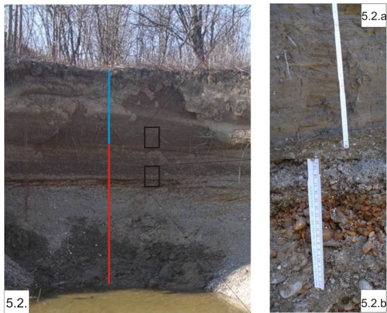
Slika 5.2. Otvoreni profil nesaturirane zone: a) tlo, mjerilo oko 40 cm; b) šljunci s pijescima, mjerilo duljine 20 cm.
