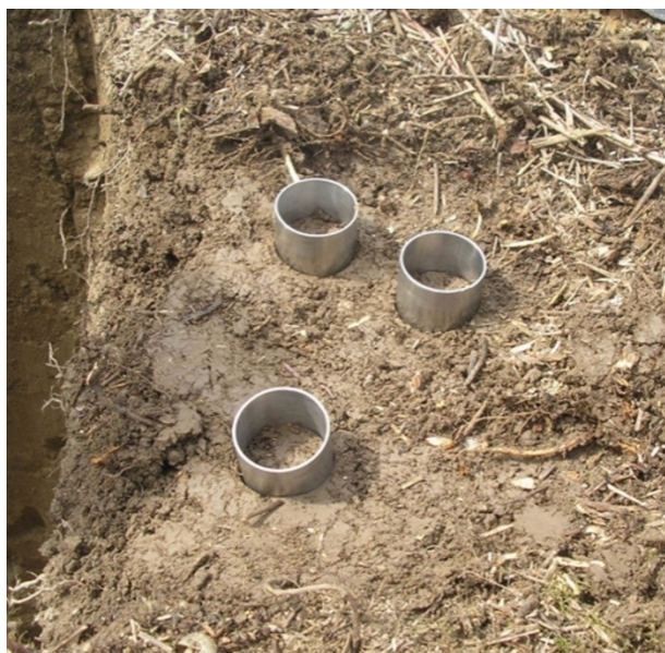
Slika 5.5. Cilindri za uzimanje neporušenih uzoraka tla.
