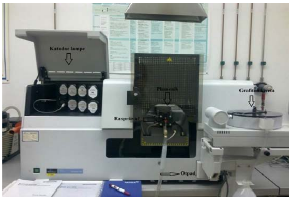
Slika 5.19. Atomski apsorpcijski spektrometar AAS 700 (foto: Prša, 2011).
