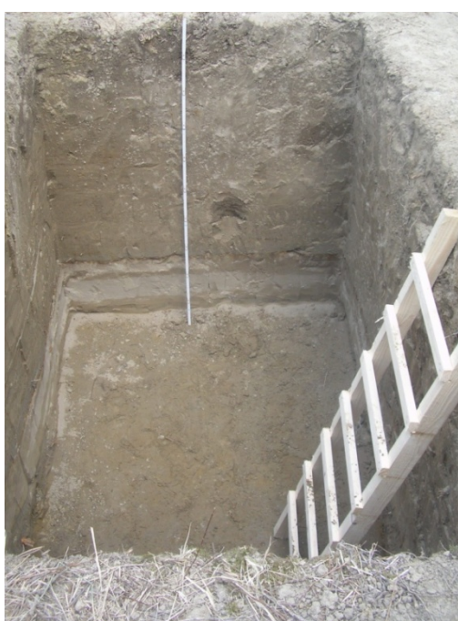
Slika 5.4. Pedološka jama, mjerilo dubine 210 cm.
