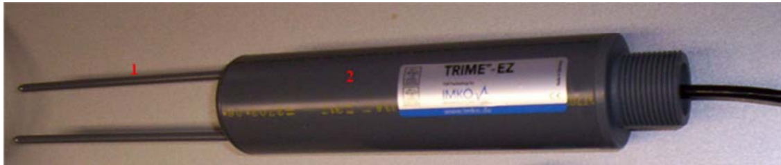
Slika 5.6. Prikaz TDR sonde. Legenda: 1) metalni vodič; 2) tijelo sonde.
