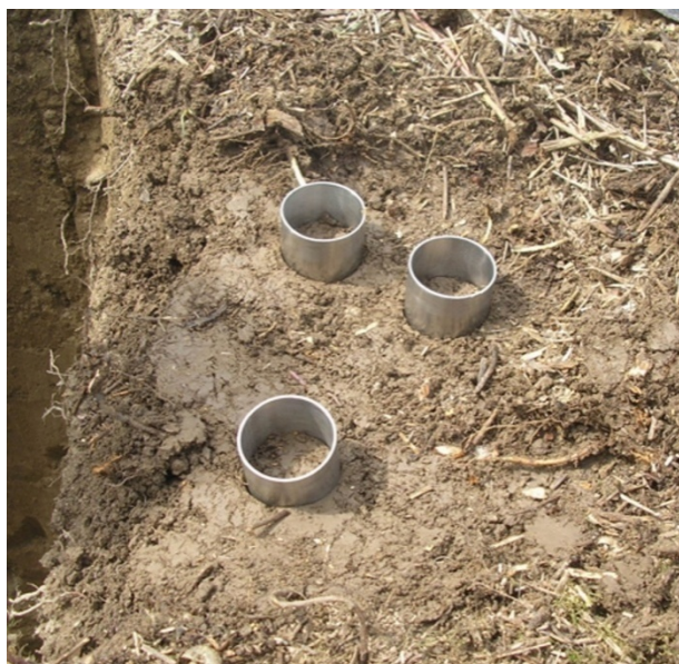
Slika 5.5. Cilindri za uzimanje neporušenih uzoraka tla.
