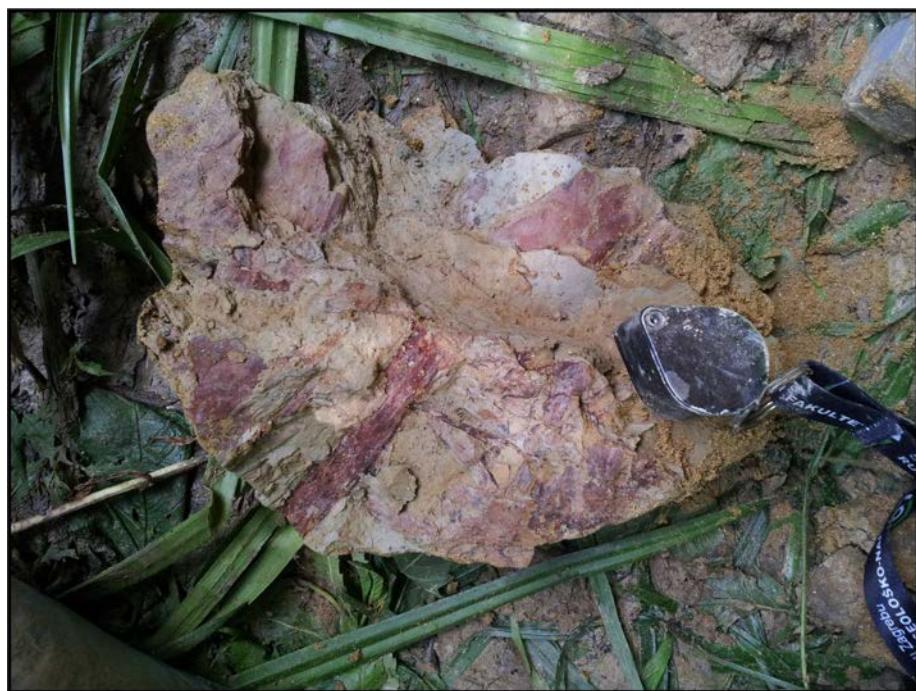
**Slika 12.6:** Ostatci bjelogoričnog lišća u prahovitoj glini smeđe boje - podina slabo litificiranih pješčenjaka s kosom slojevitosti
