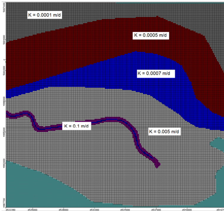
Slika 7.26 Različite zone hidrauličke vodljivosti u krovinskim naslagama
