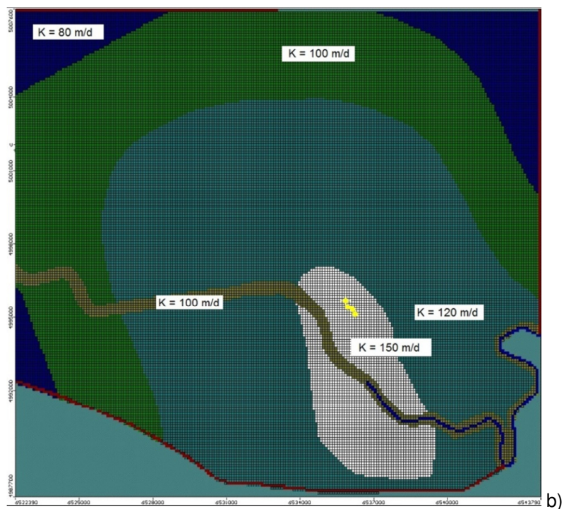
Slika 7.6 Hidraulička vodljivost krovinskih naslaga a) i vodonosnih naslaga b)
