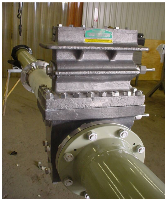
Slika 5.3: Fiksno mjerno mjesto s oštrobriđnom prigušnicom tipa Daniel
