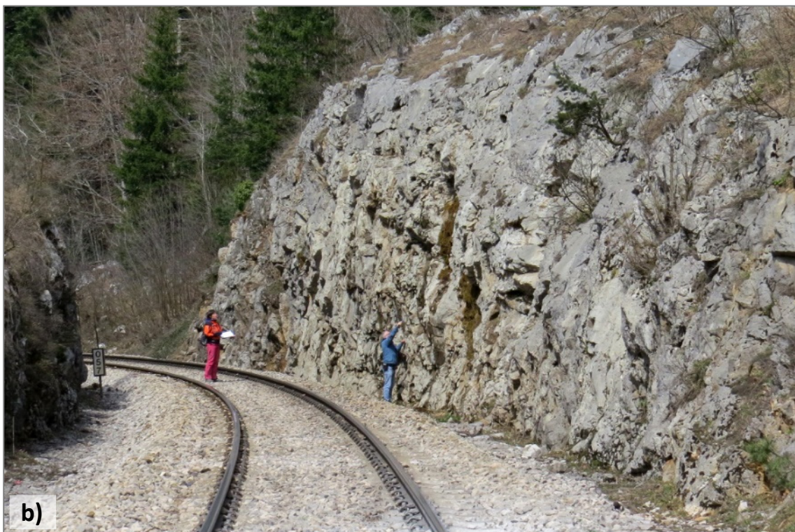
Slika 5-3. Inženjerskogeološka prospekcija: a) mjerenje Visine ; b) mjerenje Veličine bloka
