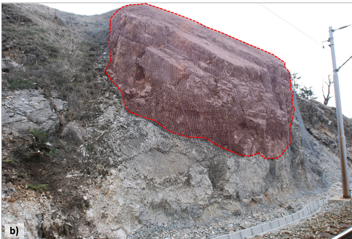
Slika 5-9. Procjena parametra Veličina bloka : a) dominantna i maksimalna veličina bloka (604-13-L); b) volumen potencijalno nestabilnog materijala (202-55-2-L)
