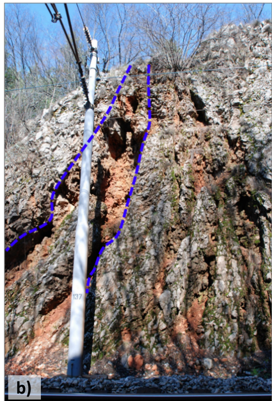
Slika 2-7. Osipavanje vezano uz razlomljene zone: a) 202-16-L; b) 202-61-D
