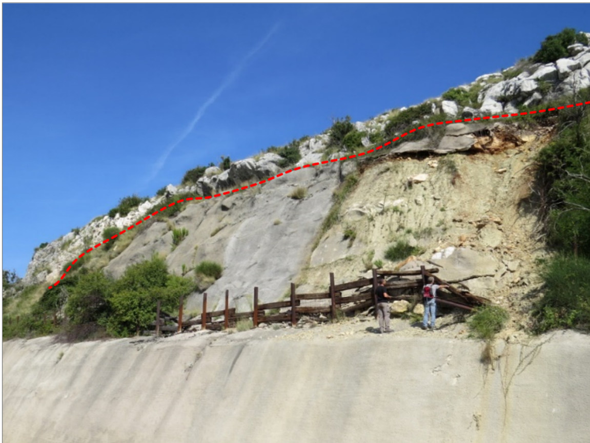
Slika 4-5. Kontakt flišnih naslaga i karbonatne stijene (604-133-L)
