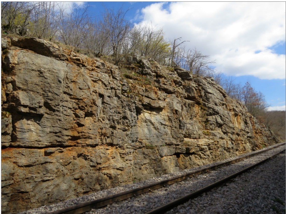
Slika 4-8. Gornja zona trošenja (604-60-L)
