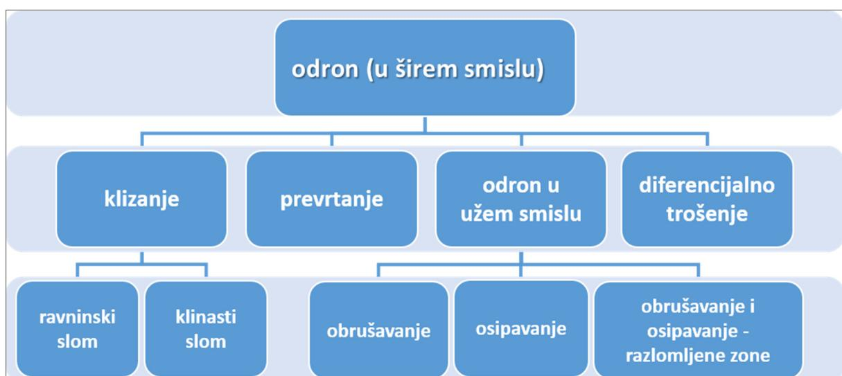
Slika 2-1. Osnovni tipovi odrona korišteni u doktorskom radu (modificirano prema Mauldon et al., 2007)
