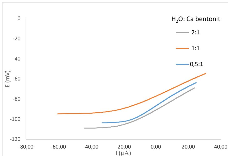
**Slika 6-17.** Linearna polarizacija Cu elektrode u uskom području potencijala u Ca bentonitnoj glini
