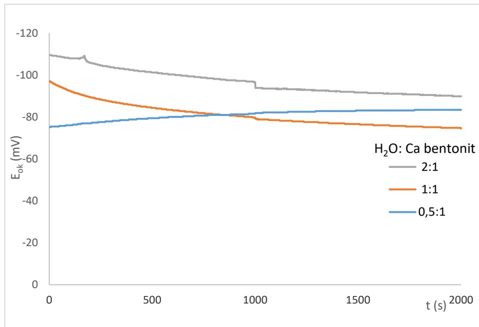
**Slika 6-16.** Stabilizacija korozijskog potencijala Cu elektrode u Ca bentonitnoj glini
