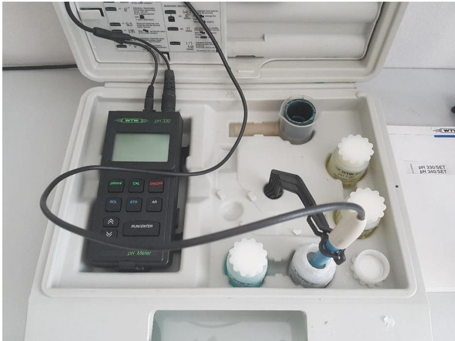
**Slika 5-12.** Pribor za mjerenje pH (WTW model pH 330)
