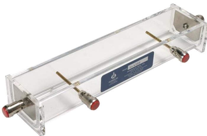
**Slika 3-6.** Ćelija za mjerenje električne otpornosti (<https://www.humboldtmetfg.com/soil-box.html>)
