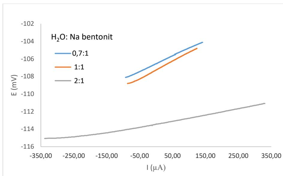
**Slika 6-26.** Linearna polarizacija Zn elektrode u uskom području potencijala u Na bentonitnoj glini
