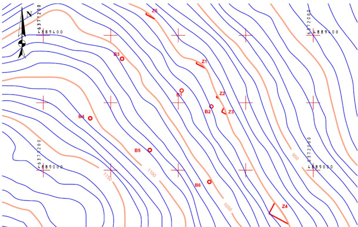
Slika 5-1 Pozicije istražnih radova s istražnim bušotinama, M 1 : 15 000
