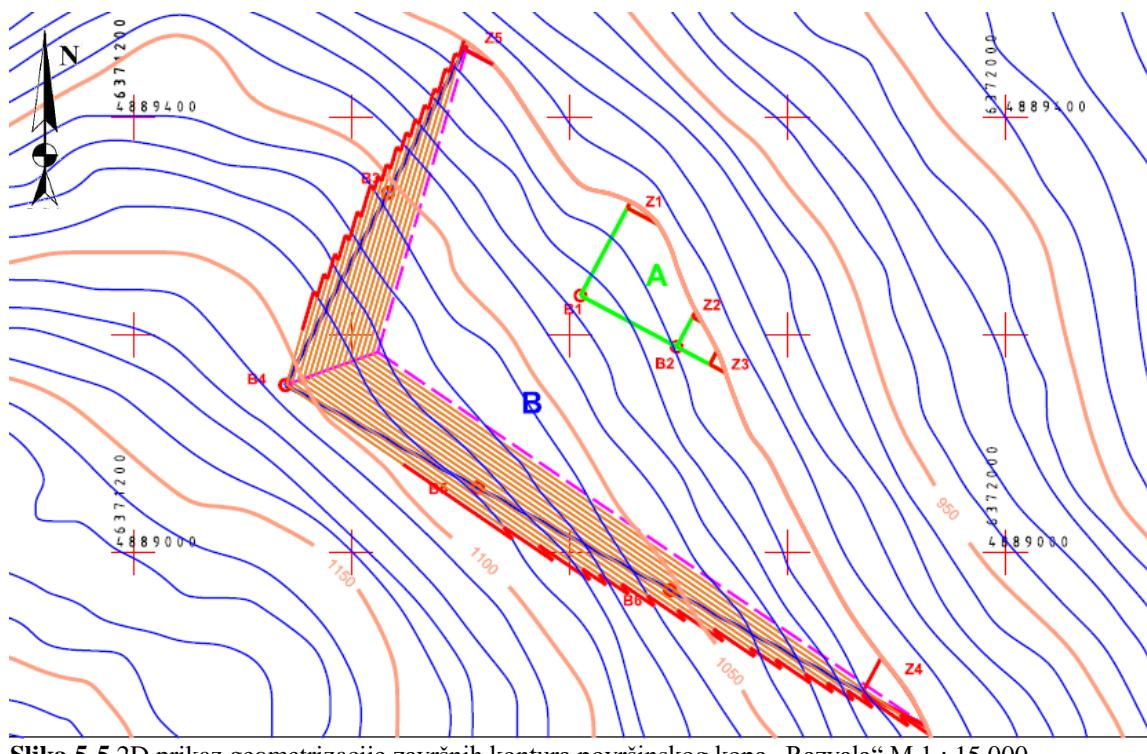
**Slika 5-5** 2D prikaz geometrizacije završnih kontura površinskog kopa „Razvala“ M 1 : 15 000
