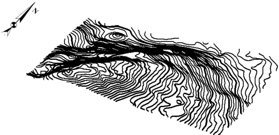
Slika 4-6 Slojnice istražnog područja prikazane u 3D modelu
