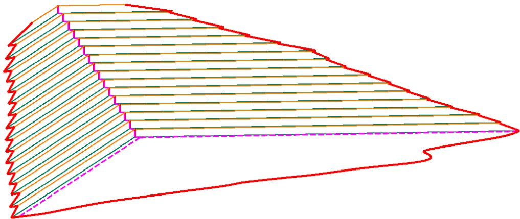
**Slika 5-6** 3D model konture površinskog kopa
