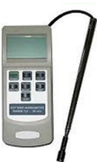
Slika 2-3. Anemometar s grijaćim elementima (Klanfar, 2017).
