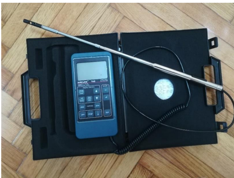
Slika 5-6. Termoanemometar TA5, Rudarsko-geološko-naftni fakultet.
