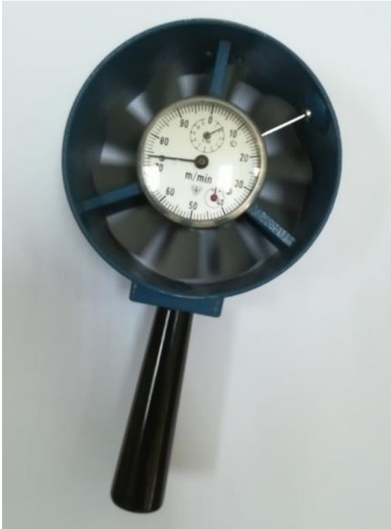
Slika 5-4. Analogni krilni anemometra, Rudarsko-geološko-naftni fakultet.
