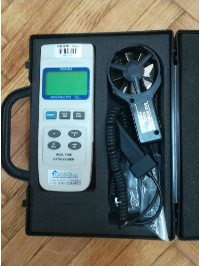
Slika 5-3. Digitalni krilni anemometar PCE – 008, Rudarsko-geološko-naftni fakultet.
