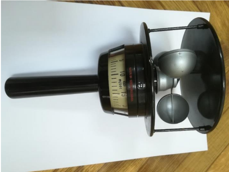
Slika 5-5. Anemometar s lopaticama, Rudarsko-geološko-naftni fakultet.
