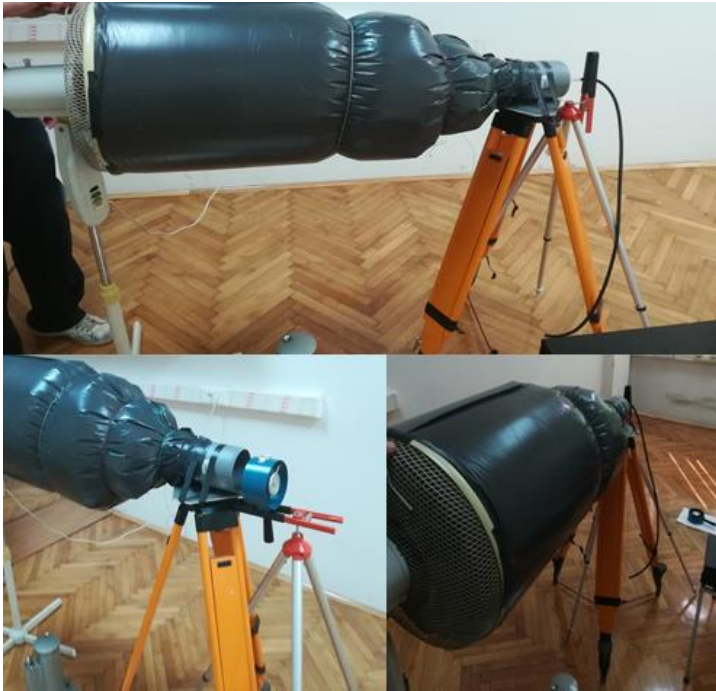
Slika 5-2. Ventilator s tri brzine rada spojen na cijev, Rudarsko-geološko-naftni fakultet.
