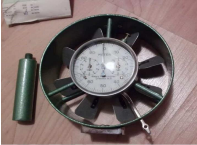
Slika 2-1. Analogni krilni anemometar (Klanfar, 2017).
