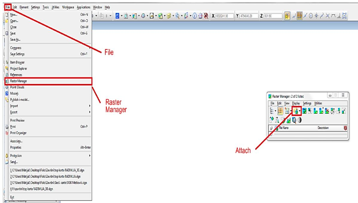
Slika 5-1 Unošenje topografske karte u Microstation
