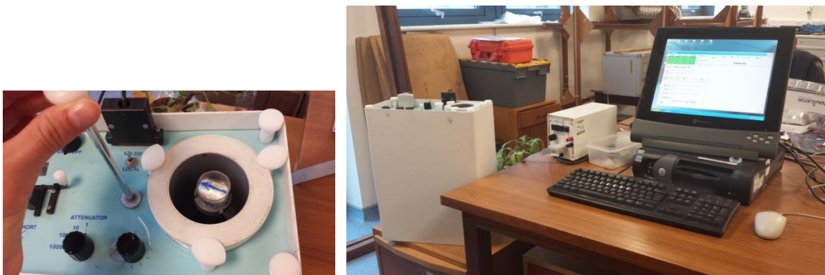
Slika 4.15. Molspin Minispin fluxgate spinner magnetometar koji je korišten za sva mjerenja remanentnog magnetizma.
