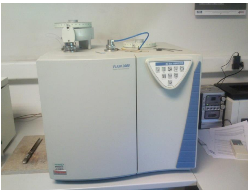
Slika 4.16. CN analizator za tla i sedimente Thermo Fisher Scientific, Flash 2000 NC Analyzer .
