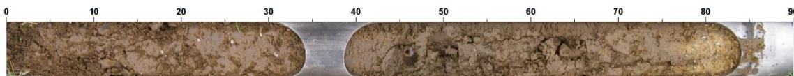
Slika 5.11. Digitalni snimak jezgre 505F. Vidljiva je promjena sastava i boje na dubini 78 cm.
