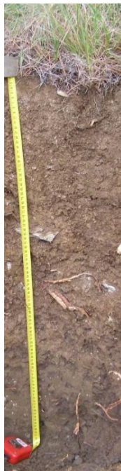
Slika 5.10. Snimak profila 505T. Od dubine 40 cm profil postaje tamniji, i prelazi od zelenkasto smeđih nijansi, u žuto-smeđe te tamno smeđe nijanse pri kraju profila.
