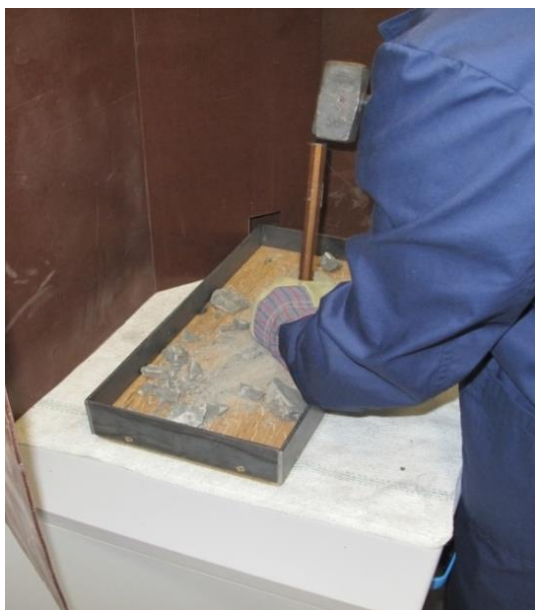
Slika 3-3. Usitnjavanje uzoraka čekićem (foto Gulam).
