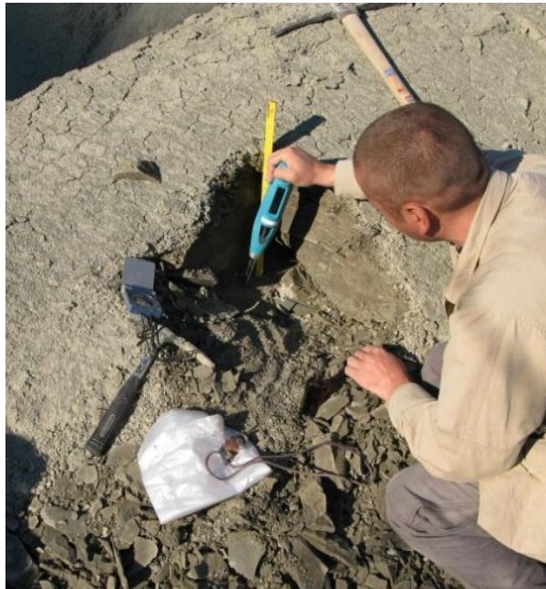
Slika 3-7. Ispitivanje Schmidtovim čekićem na terenu (Gulam, 2012).
