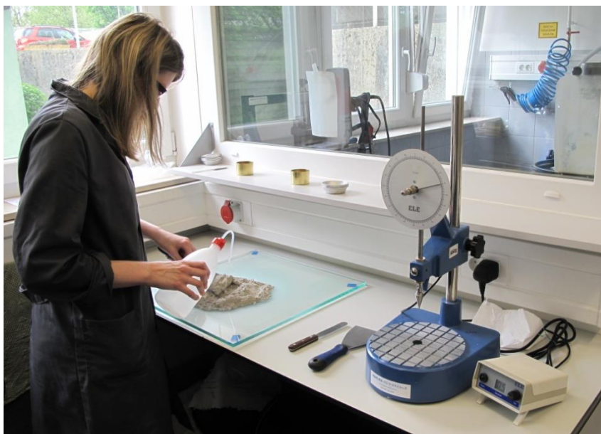
Slika 3-4. Pripremanje uzorka za određivanje granice tečenja uzorka lapora konusnim penetrometrom (foto Gulam).
