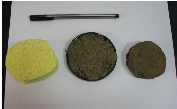
Slika 9-11. Sastavni dijelovi uređaja kojim je aproksimiran ležišni sustav (propustan i nepropustan dio). S lijeva na udesno: spužva, pijesak i muljnjak.
