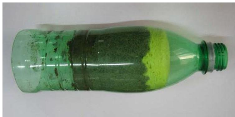
*Slika 9-12. Komora u kojoj su poredani (s lijeva na desno) mulnjak, pijesak i spužva*
