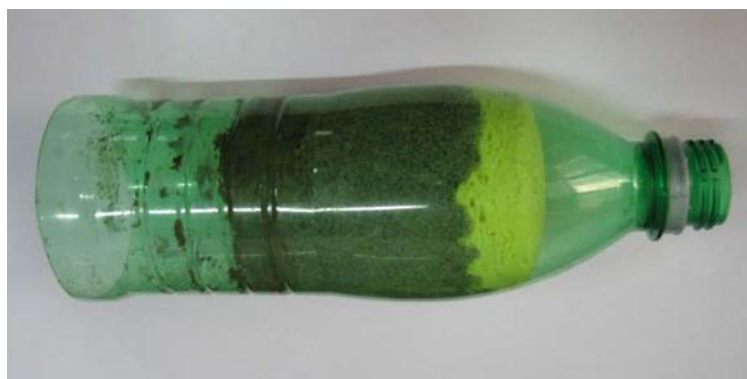
Slika 9-12. Komora u kojoj su poredani (s lijeva na desno) muljnjak, pijesak i spužva
