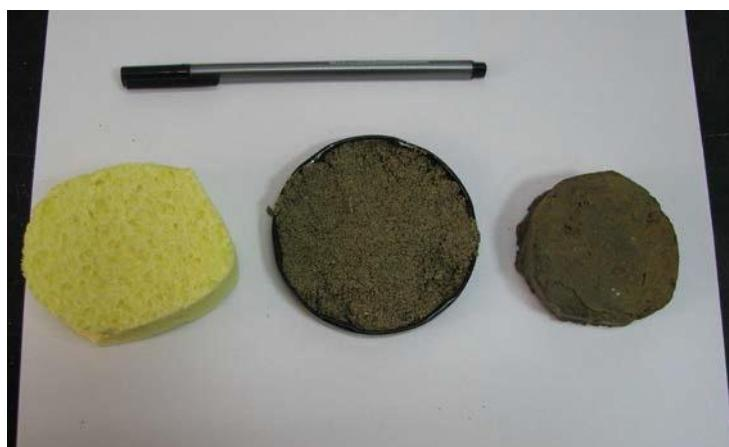
*Slika 9-11. Sastavni dijelovi uređaja kojim je aproksimiran ležišni sustav (propustan i nepropustan dio). S lijeva na udesno: spužva, pijesak i mulnjak.*
