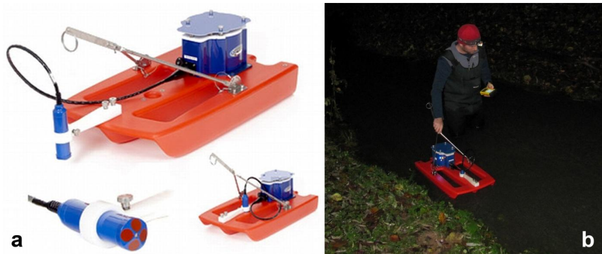
Slika 5.4. a – ADCP uređaj za mjerenje protoka; b – mjerenje protoka ADCP uređajem na izvoru Jaža
