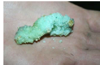
Epsomit u anizičkom dolomitu, desni bok, 3 m
