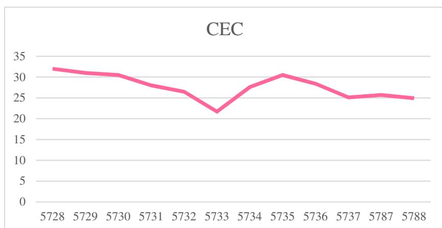
**Slika 4-19.** Raspodjela vrijednosti kapaciteta kationske izmjene po uzorcima
