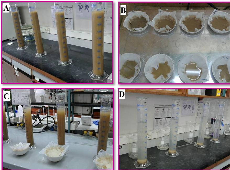
**Slika 3-10.** A) Cilindri sa zamučenom suspenzijom neposredno nakon pripreme; B) Uparavanje vode iz pipetirane suspenzije; C) Cilindri sa suspenzijem nakon 48h; D) Cilindri sa suspenzijom nakon što je iz njih izvučena sva glinovita frakcija (foto: Trebeš, 2017)
