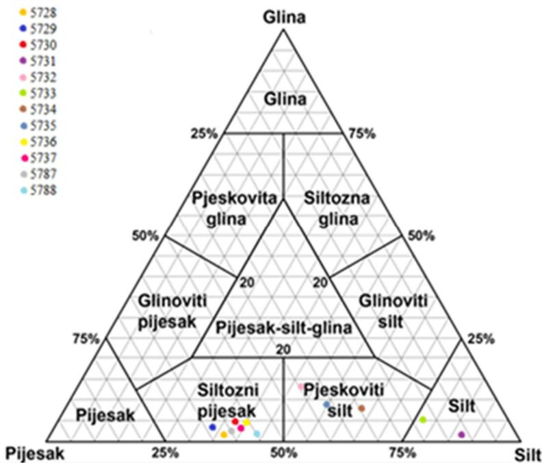
**Slika 4-5.** Trokomponentni dijagram klasifikacije sedimenata na temelju odnosa zastupljenosti gline, silta (praha) i pjeska (Shepard, 1954).
