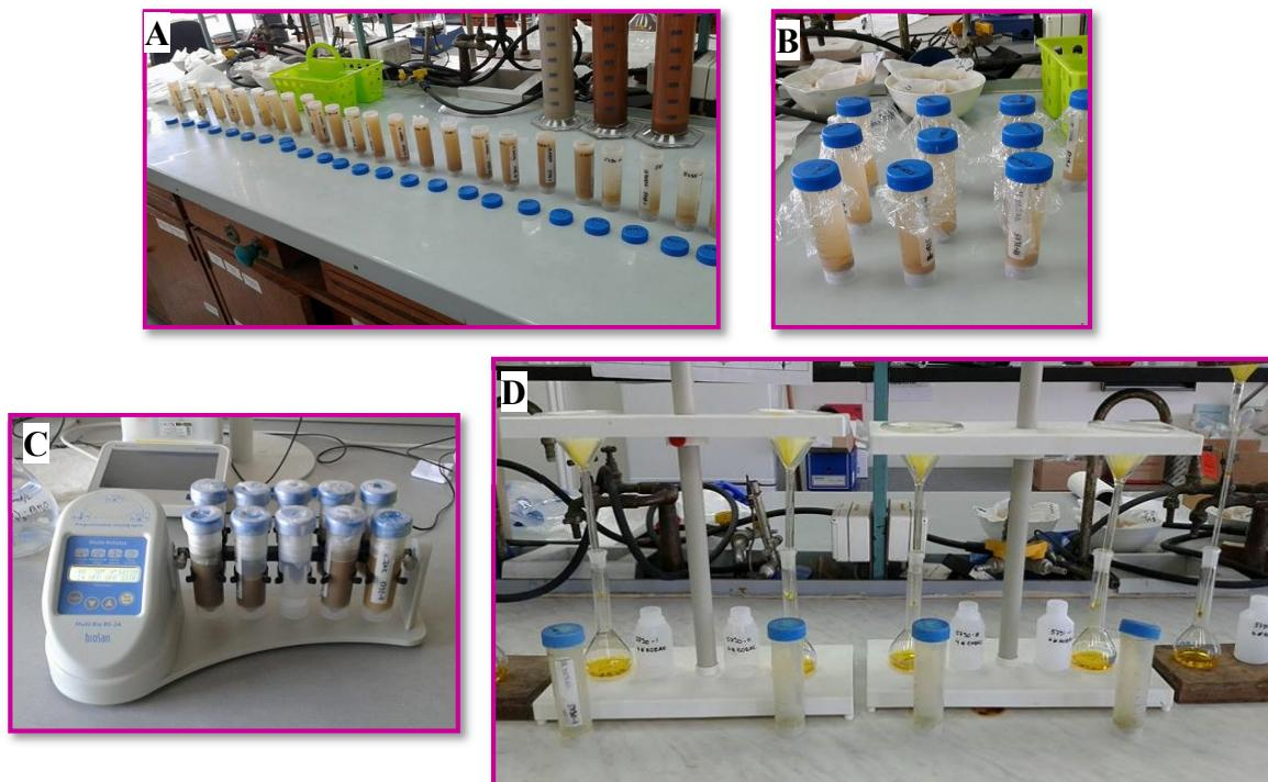
**Slika 3-13.** Postupak sekvenčne ekstrakcijske analize (A- priprema uzorka s kiselinom, B- priprema kiveta za mučkanje, C- mučkanje otopine, D- filtriranje)
