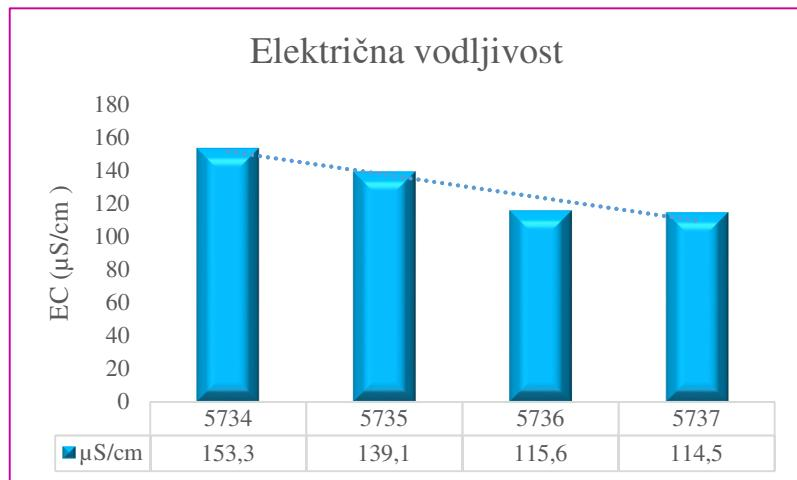
Slika 4-3. Dijagram laboratorijskih rezultata električne provodljivosti za profil
