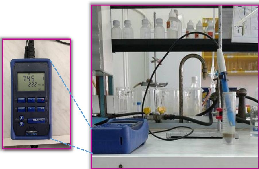
Slika 3-6. Princip mjerena pH metrom
