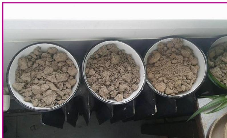
**Slika 3-4.** Sušenje uzorka na sobnoj temperaturi (foto: Trebeš, 2016)
