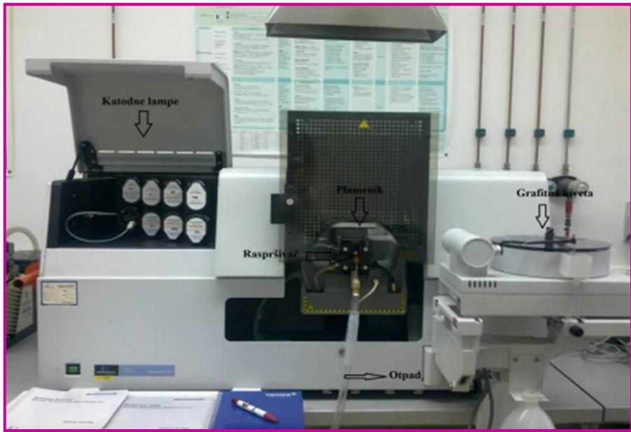
Slika 3-17. PerkinElmer AAnalyst 700 apsorpcijski spektrometar (Prša, 2011)
