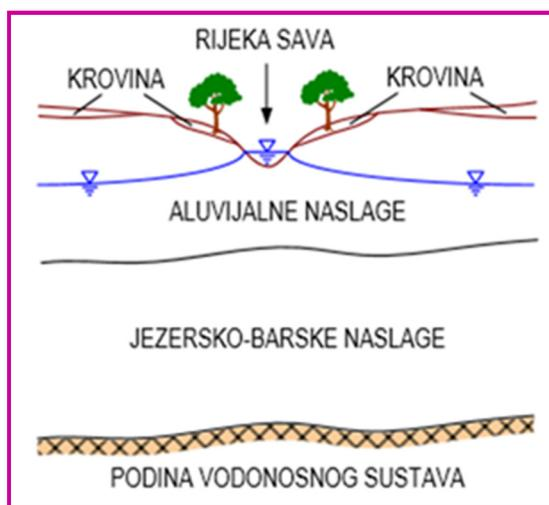
**Slika 2-6.** Shematski prikaz zagrebačkog vodonosnog sustava (Posavec, 2006)
