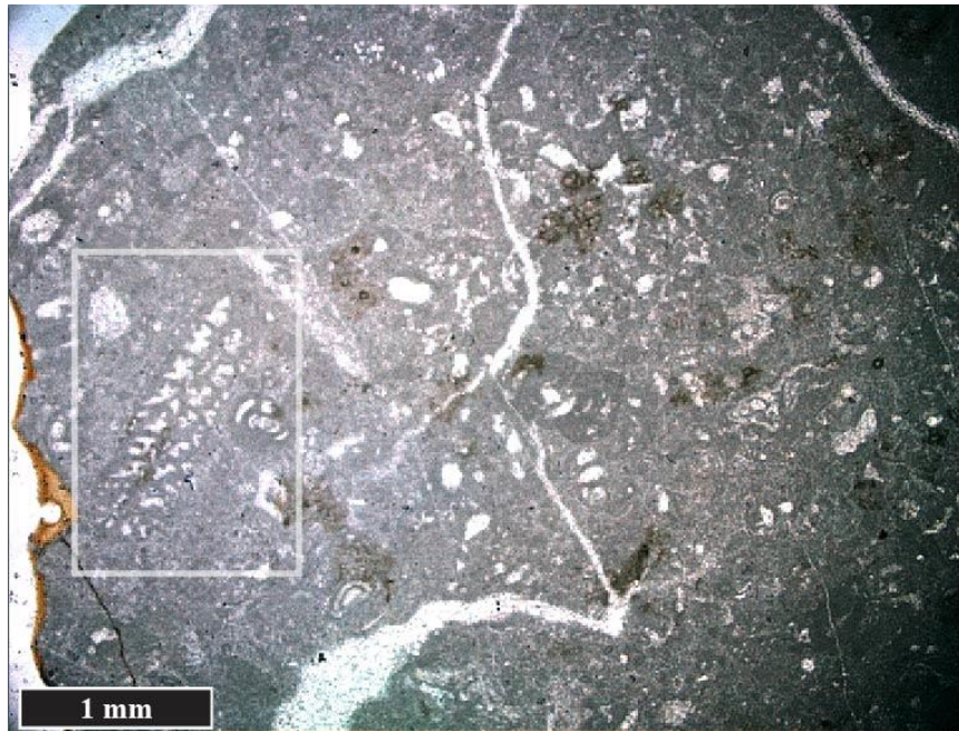
Slika 7-5. Mikrofotografija uzorka vapnenca TR-4. U bijelo uokvirenom području vidljiva je foraminifera Dicyclina schlumbergeri MUNIER-CHALMAS, koja je provodna za razdoblje turon-kampan.
