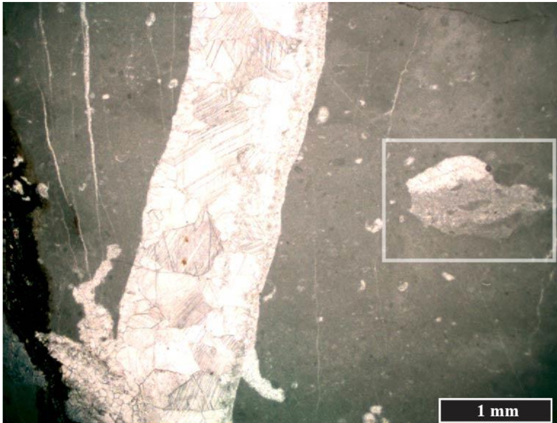
Slika 7-4. Mikrofotografija uzorka vapnenca TR-2. Uz krajnji lijevi rub slike vidljiv je dio pukotine zapunjene boksitom. Mikrit je karakteriziran geopetalnom strukturom, što je osobito vidljivo u desnom dijelu slike (bijeli okvir), a koja je karakterizirana prisustvom nepravilnih šupljina otapanja ispunjene u donjem dijelu kristalnim siltom i kalcitnim cementom u gornjem dijelu (bijeli okvir).
