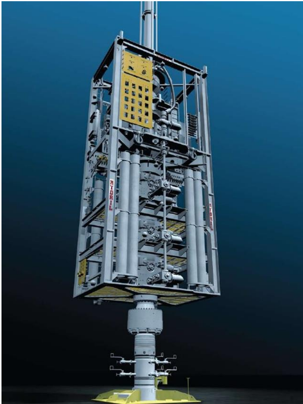
Slika 2-1. Podvodni sustav za kontrolu tlaka (Barlow, 2017)
