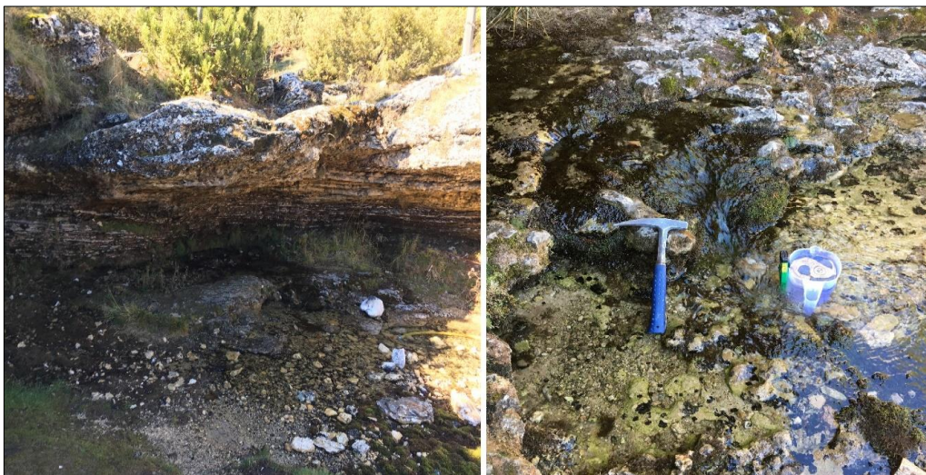
Slika 6.10. Izvor Jasle (lijevo) „in situ“ mjerenje temperature, Eh i pH vrijednosti na izvoru (desno)
