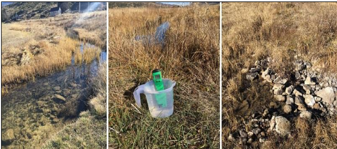
Slika 6.9. Vodotok Brčanj drenira kroz polje (lijevo), „in situ“ mjerenje temperature, Ph, Eh vrijednosti (sredina), ponor (desno)
