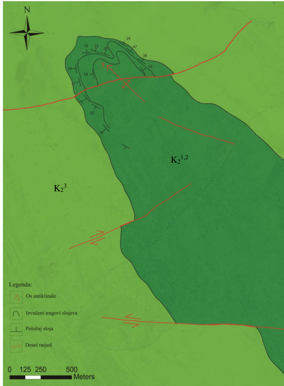
Slika 4–18. Interpretirana satelitska snimka bore unutar turonskih vapnenaca u središnjem dijelu područja istraživanja s izvučenim tragovima slojeva i mjerenih rasjeda
