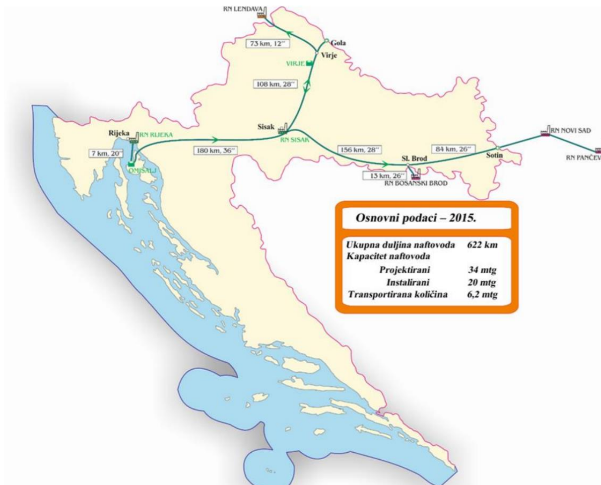
Slika 3-5. Naftovodni sustav JANAF-a ( www.hera.hr )
