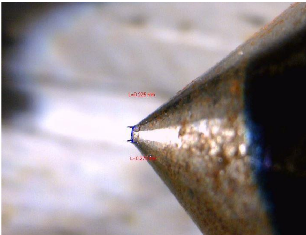
Slika 6-8. Uvećani bočni prikaz načina mjerenja promjera površine trošenja mjerne igle (Grgurić 2017).
