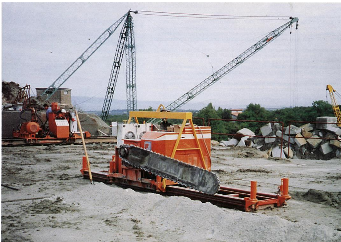
Slika 2-3. Laganija izvedba lančane sjekačice Fantini pri radu na početnom otvaranju usjeka, tj. pri početku rada na otvaranju dubinskog kamenoloma (Kujundžić et al. 2003).
