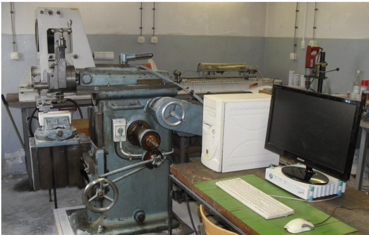
Slika 6-2. Uređaj za pravolinijsko rezanje stijena i mjerni sustav (Korman 2014).
