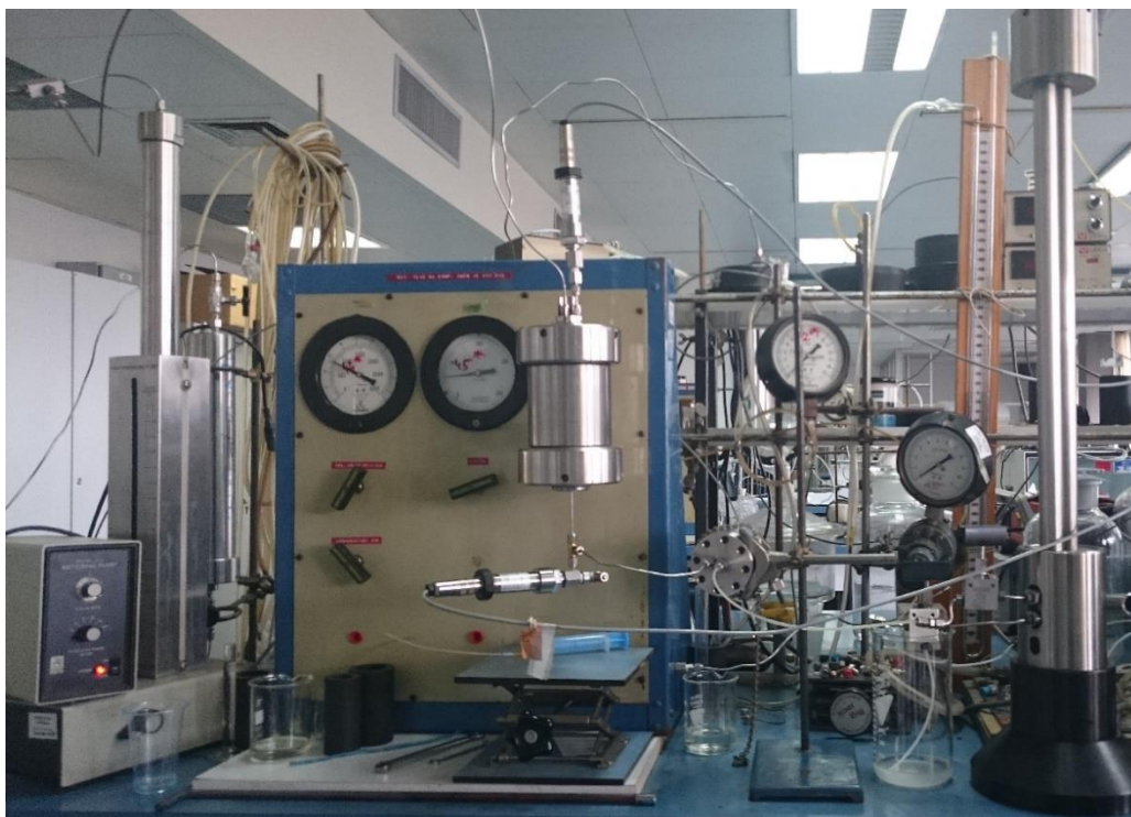
Slika 4-2. Prikaz opreme za određivanje relativnih propusnosti metodom nestacionarnog stanja.
