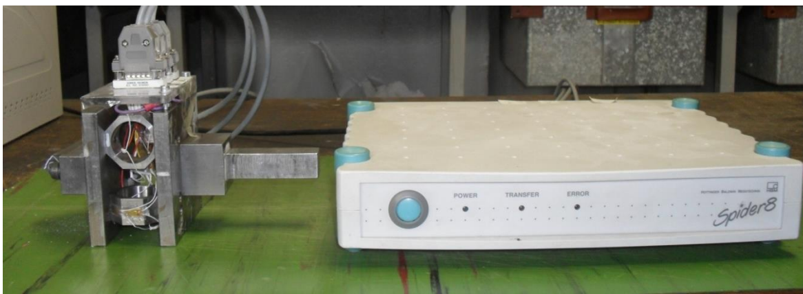
Slika 4-6 Mjerni sustav za mjerenje sile rezanja (Korman, 2014).
