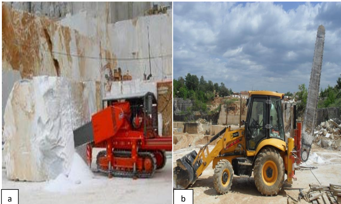
Slika 2-2 Samohodne lančane sjekačice a) na gusjenicama b) na gumenim kotačima (Dunda i Kujundžić, 2003).
