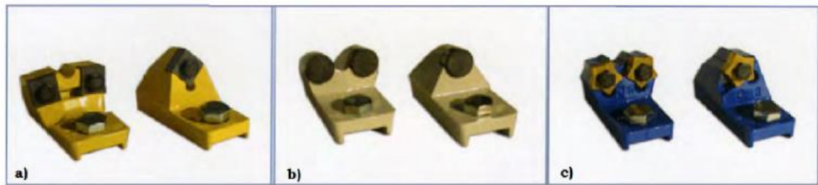
Slika 2-6 Rezne pločice a) kvadratičnog oblika, b) kružnog oblika, c) zvjezdastog oblika (Primavori, 2005).
