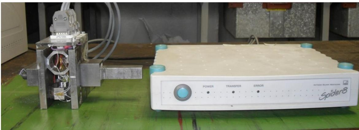
**Slika 4-6** Mjerni sustav za mjerenje sile rezanja (Korman, 2014).
