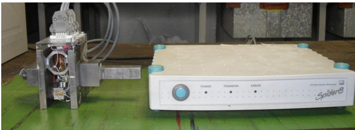
Slika 4-6 Mjerni sustav za mjerenje sile rezanja (Korman, 2014).
