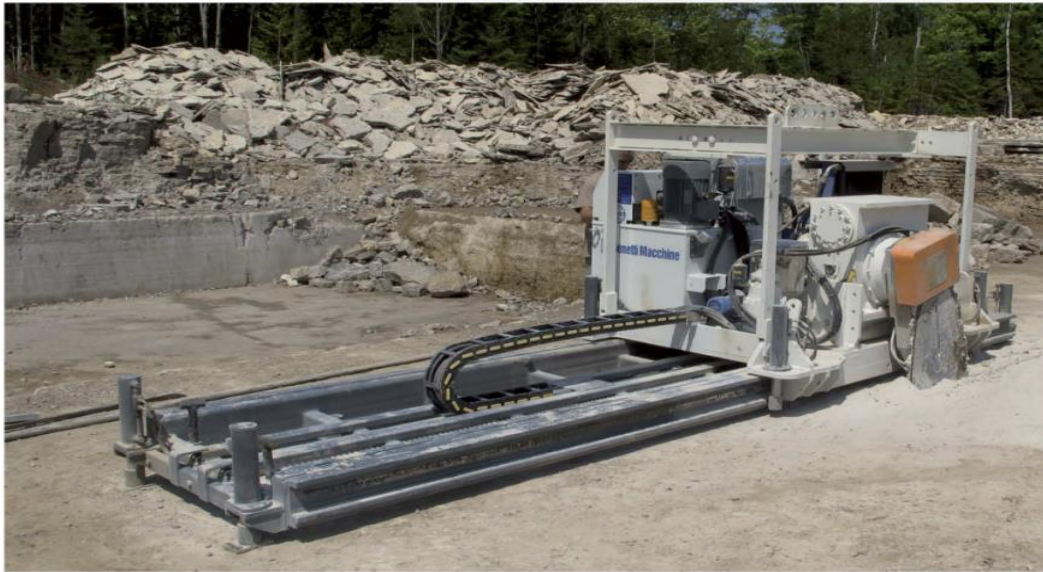
Slika 2-1 Lančana sjekačica na tračnicama (Dunda i Kujundžić, 2003).
