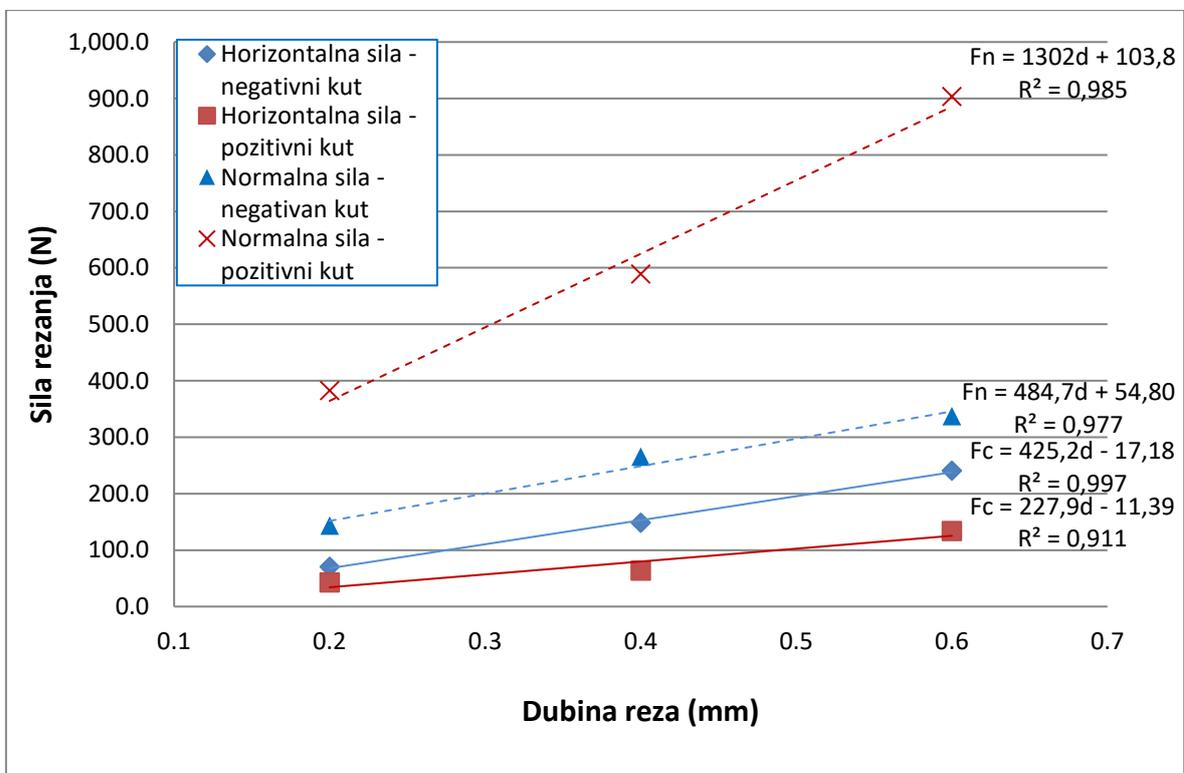
Slika 4-13 Utjecaj napadnog kuta i dubine reza na sile rezanja za uzorak Kraljev vrh.
