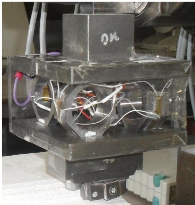
**Slika 4-5** Konstrukcija mjernog pretvornika sile (Korman, 2014).
