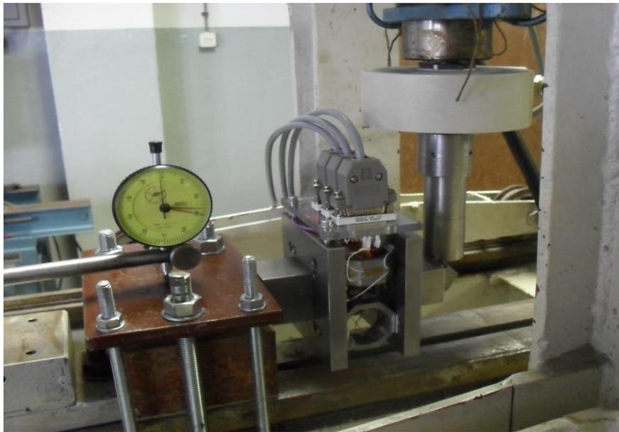
**Slika 4-7** Uređaj za umjeravanje pretvornika sile (Korman, 2014).
