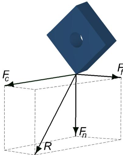
**Slika 2-9** Rezultantna sila rezanja i njene komponente (Korman, 2014).
