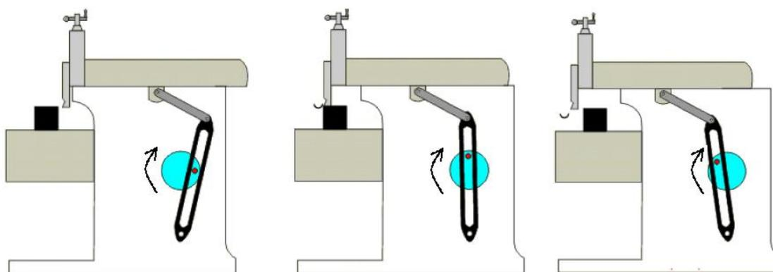
**Slika 4-1** Način glavnog gibanja mehaničke blanjalice (Slade, 2012).
