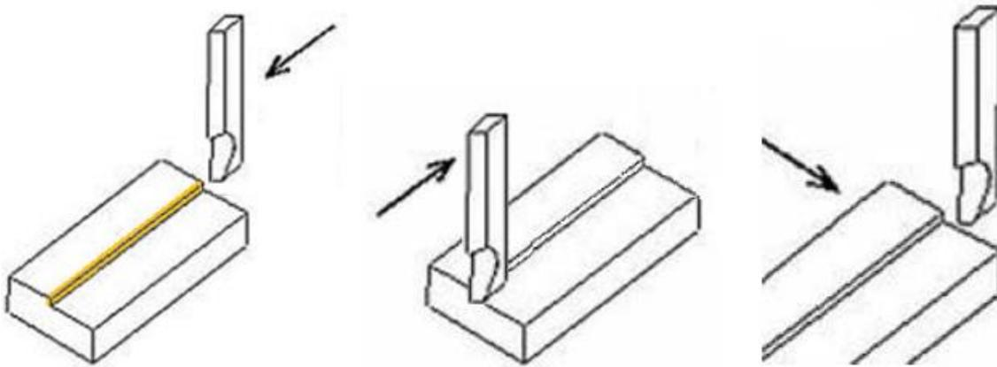
**Slika 4-2** Shematski prikaz kratkohodnog blanjanja (Slade, 2012).
