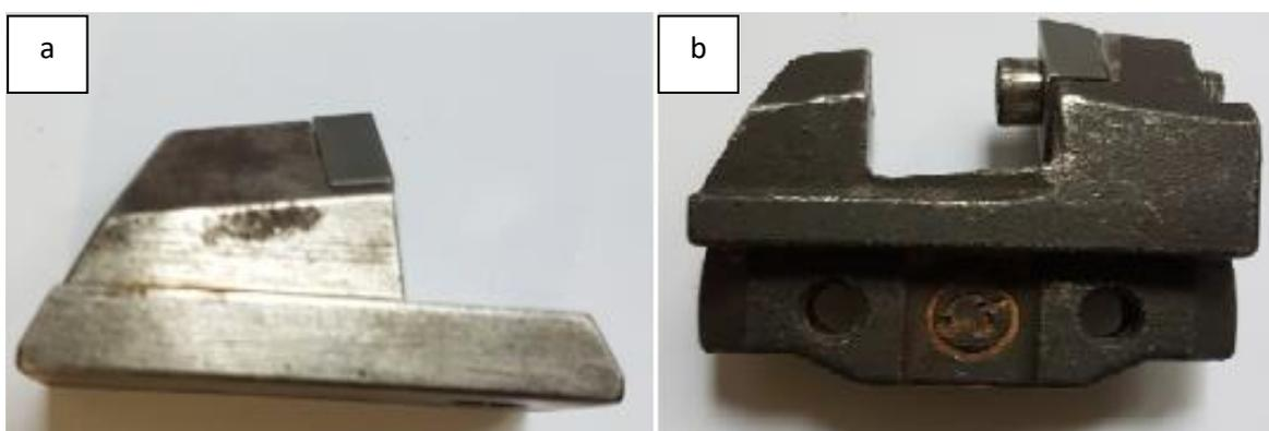
**Slika 4-10** a) nosač rezne pločice za negativni napadni kut b) nosač rezne pločice za pozitivni napadni kut
