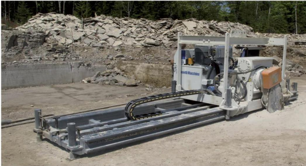
**Slika 2-1** Lančana sjekačica na tračnicama (Dunda i Kujundžić, 2003).
