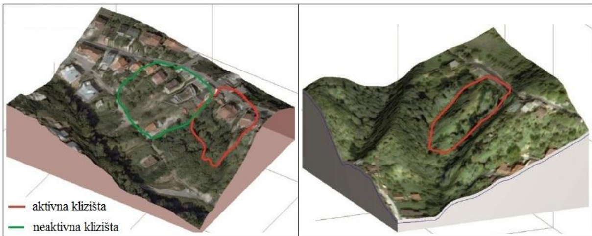
Slika 2.6 Tipična klizišta u Podsljemenskoj zoni u odnosu na kuće (modificirano prema Mihalić i dr. 2011)
